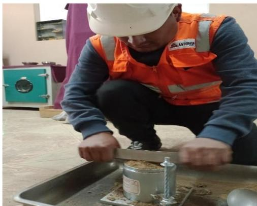
El molde a emplea es de 4”, puesto que el método es “A”, siendo la cantidad de 5 capas y 25 golpes por capa, se compacta y se enrasa para ser pesada y se saca su optimo contenido de humedad.
