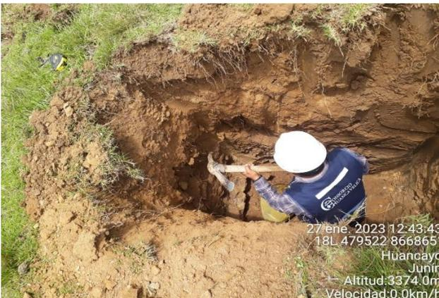
Extracción del material de cada estrato y la muestra más inestable a una profundidad 1 m, para luego ser llevado al laboratorio de suelos y sea analizado.
