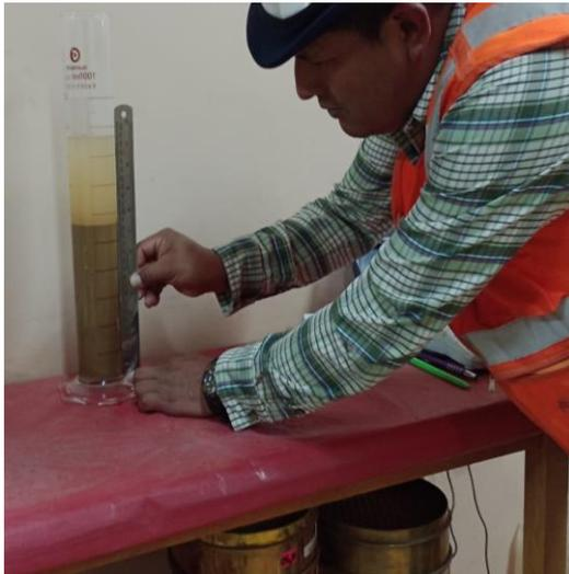
Se realiza de forma manual la agitación de la muestra de suelo con la sustancia química, y se deja un tiempo de reposo, para luego seguir agitando cuando se finaliza se sumerge el medidor para determinar qué cantidad de área y finos se encuentra en la muestra.
