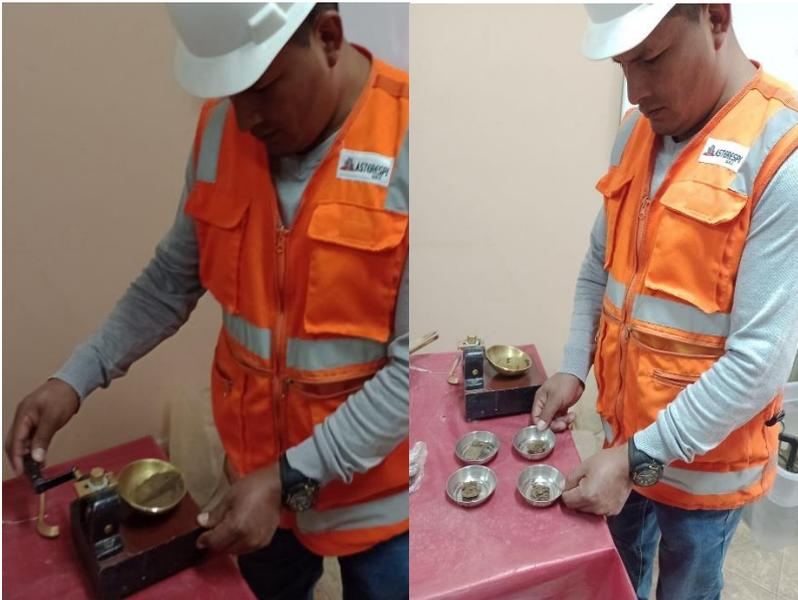
La muestra se seca a una temperatura constante, se deja enfriar y se tamiza por la malla N°40, para realizar el ensayo con el instrumento copa Casagrande y realizar las anotaciones correspondientes.
