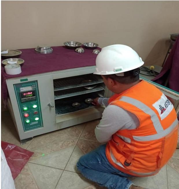
Se extra la muestra representativa se pesa la muestra humedad y se lleva a un horno a una temperatura de  $110^{\circ}\text{C} \pm 5^{\circ}\text{C}$  y obtener la masa seca del suelo.
