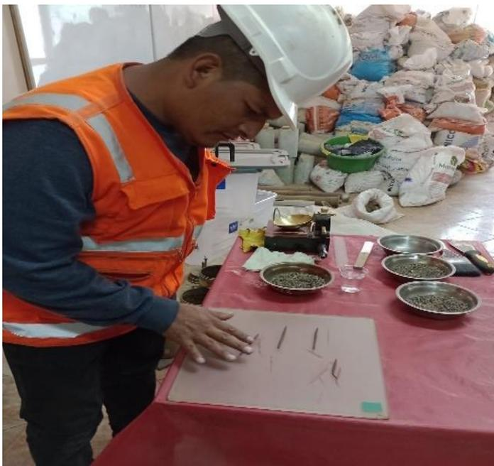
Para realizar el ensayo se requiere que la muestra sea de la pasante de la malla N°40, se humedece para realizar el rodamiento en una superficie lisa en forma de barritas sin que se desmoronen.
