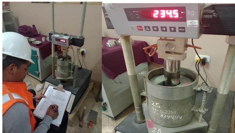
Se retira el molde de la poza de agua para luego ser ensayado con la maquina de penetración.
