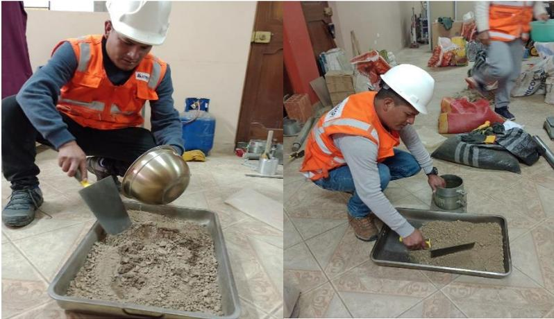
El molde a utilizar es el de 6”, la cantidad de capas a compacta es de 5, se realiza el ensayo para tres moldes, el primero se compacta con 56 golpes, el segundo con 25 golpes y el tercero con 12 golpes.
