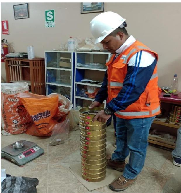
El primer paso es realizar el cuarteo para extraer la muestra representativa, se extrae la cantidad requerida como mínimo en la norma según su tamaño máximo de la partícula, se seca a una temperatura constante para obtener la masa inicial, posteriormente se satura con agua por 24 h para luego ser lavada y secada (masa final), después de esto se tamiza con las mallas según las normativas.
