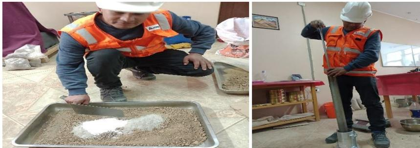
Se realiza la combinación del suelo con el agua, más los componentes estabilizadores reciclados que se propone en la investigación.
