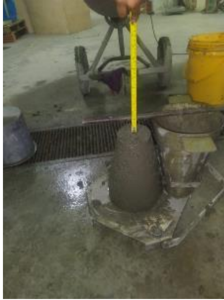
FIGURA N° 5. 22: Vista de sacado de muestras para las probetas, control de calidad de slump para concreto f'c=175 kg/cm 2 .
