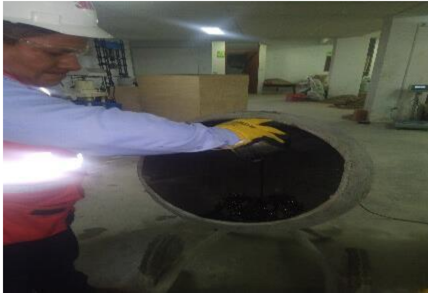
Fotografía 5 adiciones de aceite residual automotriz al concreto
