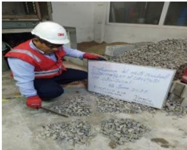
FIGURA N° 5. 11: Toma de muestras del agregado grueso para el ensayo granulométrico.
