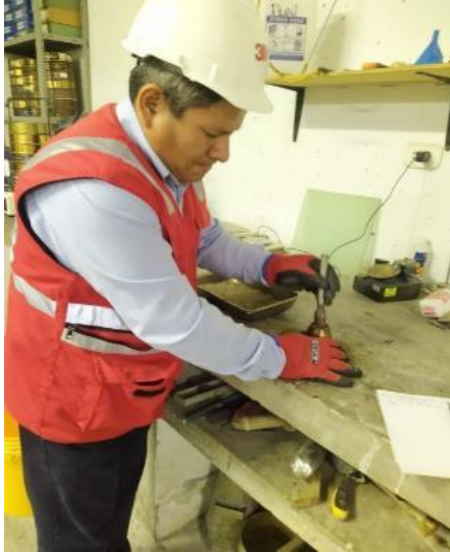
FIGURA N° 5. 10: Ensayo de absorción del agregado fino
