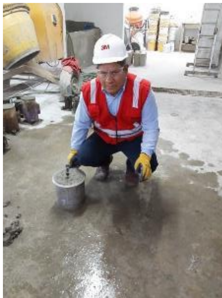
FIGURA N° 5. 26: Vista de la toma de muestras experimental de impermeabilización del concreto f'c = 175 \text{ kg/cm}^2 .
