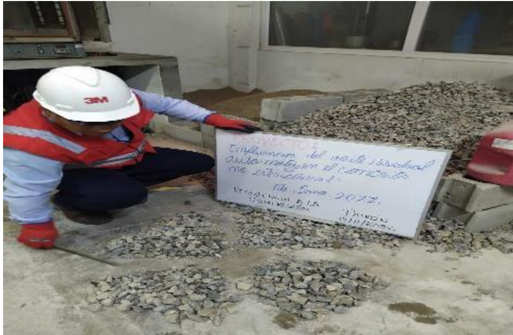
Fotografía 3 cuarteo de agregado fin
