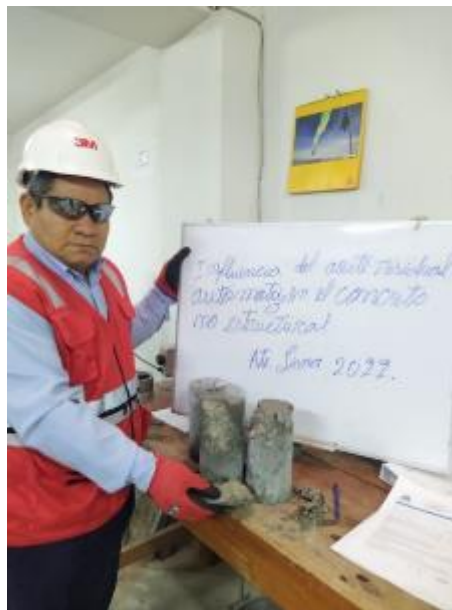
FIGURA N° 5. 30: Rotura a compresión de probetas con adición del 3% de aceite residual automotriz.
