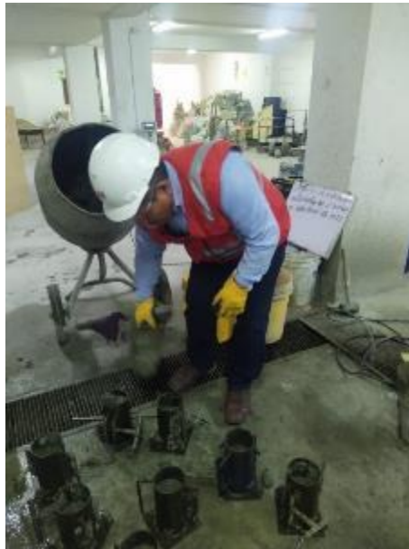
FIGURA N° 5. 23: Vista de llenado de probetas para las los ensayos
