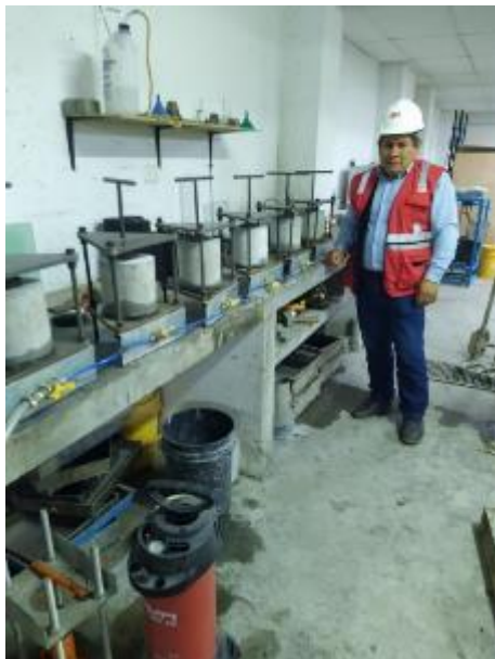
FIGURA N° 5. 32: Vista de Ensayo De Profundidad De Penetración De Agua Bajo Presión de probetas de concreto f'c=175 kg/cm 2 .
