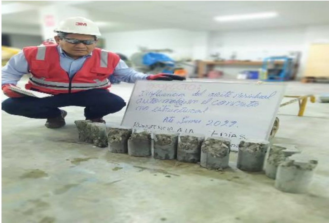
fotografía 11 rotura de muestra a compresión
