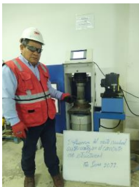
FIGURA N° 5. 28: Vista colocación del espécimen a la compresión de concreto f^c=175 kg/cm 2 .
