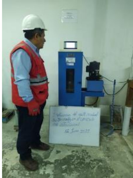
FIGURA N° 5. 29: Toma de datos del ensayo a compresión de probetas de concreto f'c=175 kg/cm 2 .
