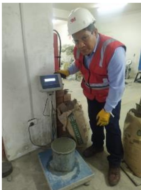
FIGURA N° 5. 27: peso del concreto en estado fresco muestras del concreto f'c=175 \text{ kg/cm}^2 .
