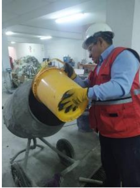
FIGURA N° 5. 18: Vista de la preparación del concreto f'c = 175 \text{ kg/cm}^2 de acuerdo con el diseño de mezcla, para la muestra de diseño patrón y muestras experimentales.
