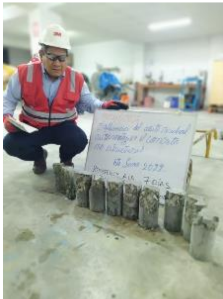
FIGURA N° 5. 31: Rotura a compresión de probetas con adición del 3% y el 5% de aceite residual automotriz. Ensayo De Profundidad De Penetración De Agua Bajo Presión (UNE 12390 – 8 – 2009)
