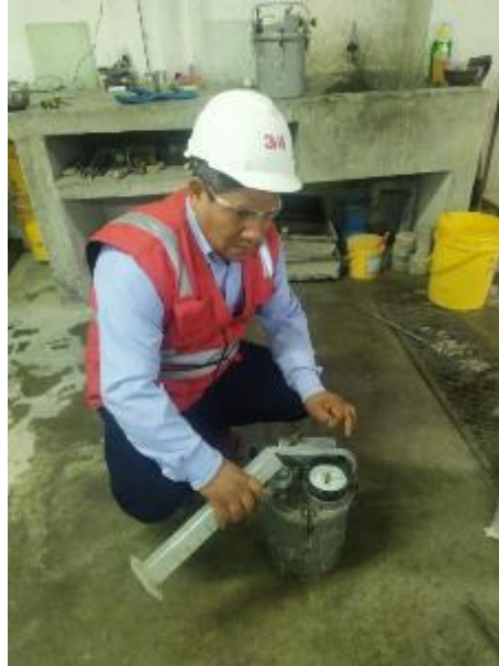
FIGURA N° 5. 24: Vista de control del contenido de aire del concreto f'c=175 kg/cm 2 experimental
