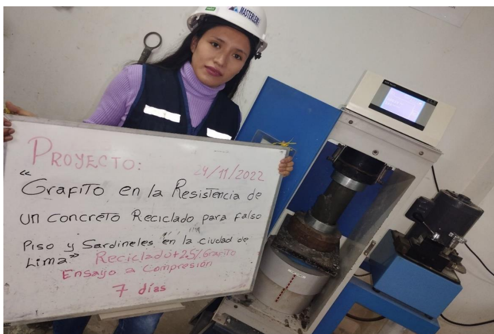
Fotografía N° 26: Resistencia a la compresión del concreto reciclado con 2.5% de grafito
