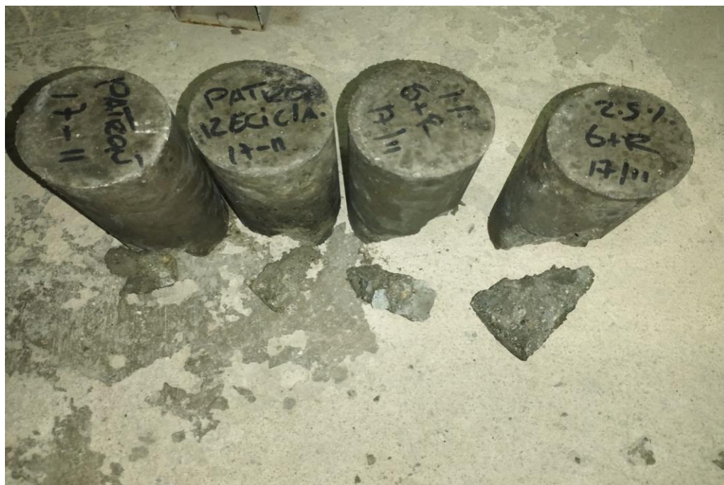
Fotografía N° 27: Rotura de las probetas a la resistencia a la compresión
