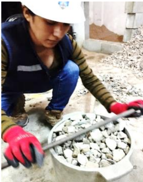
Figura N° 5. 8: Calculo del peso unitario suelto.
