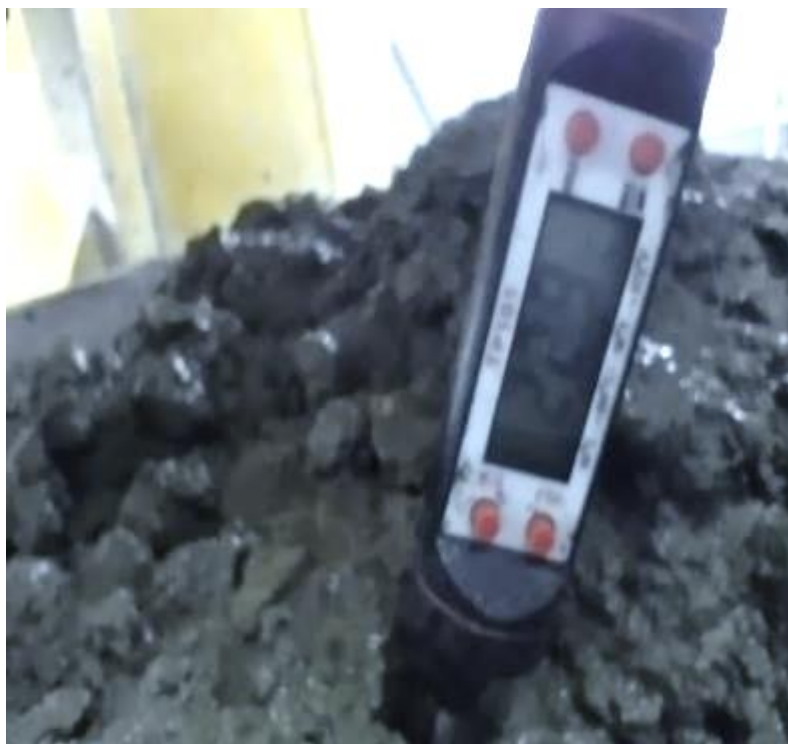
Figura N° 5. 39: Temperatura del concreto con reemplazo de 100% de agregado grueso por agregado reciclado + 1% Grafito.
