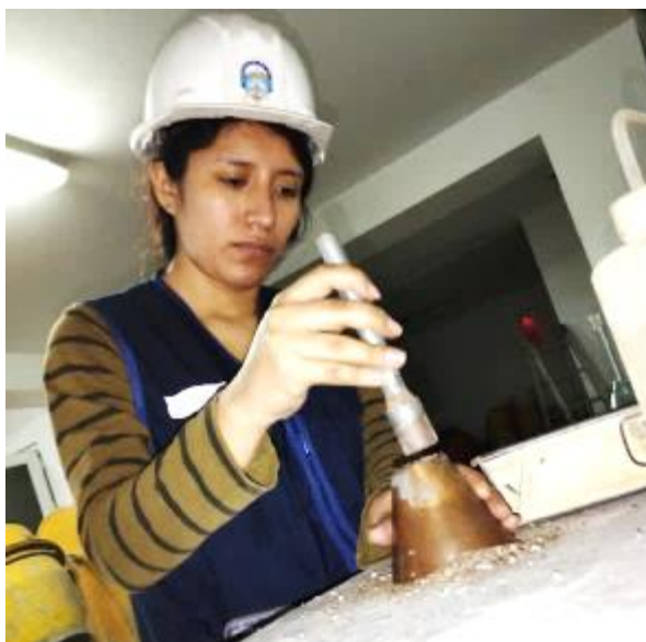
Figura N° 5. 24: Apisonado del agregado fino
