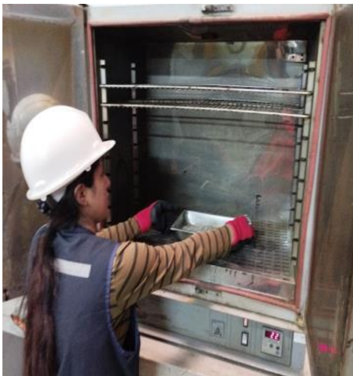
Figura N° 5. 10: Secado del Agregado grueso por 24 horas
