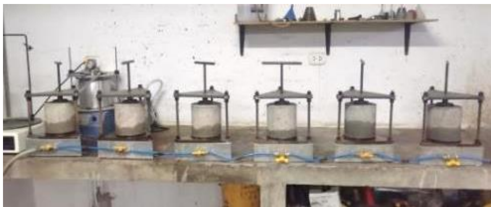
Figura N° 5. 45: Ensayo de Permeabilidad
