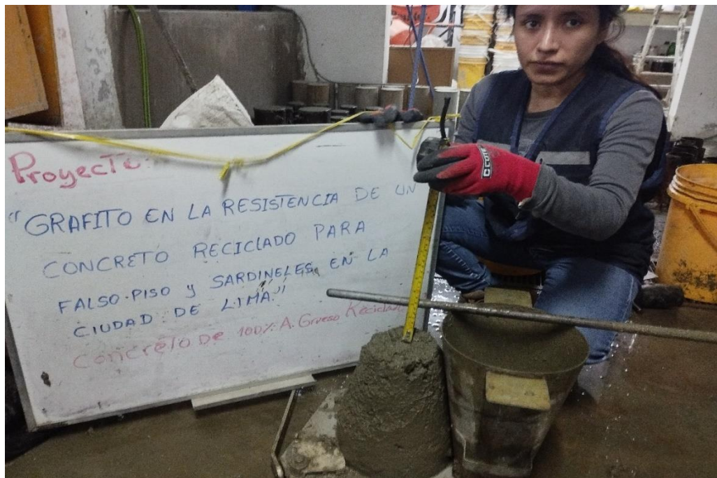
Fotografía N° 18: Slump del concreto reciclado
