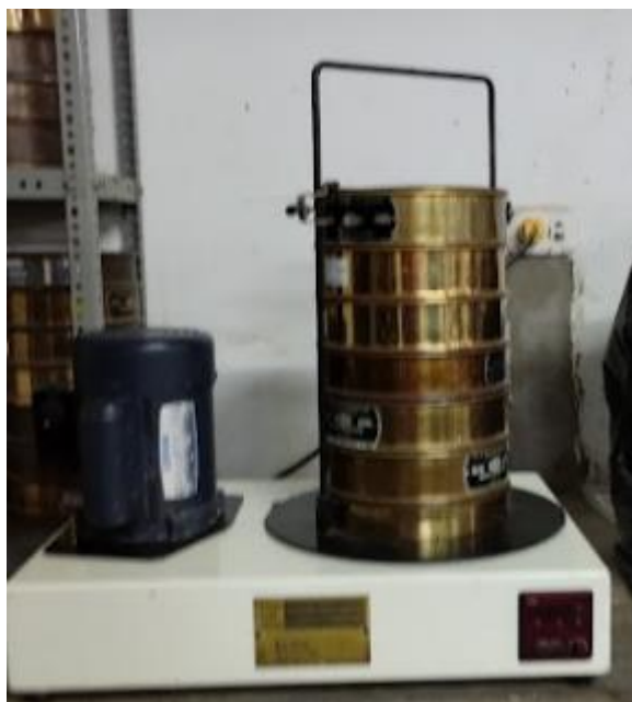
Figura N° 5. 19: Tamizado del agregado Fino
