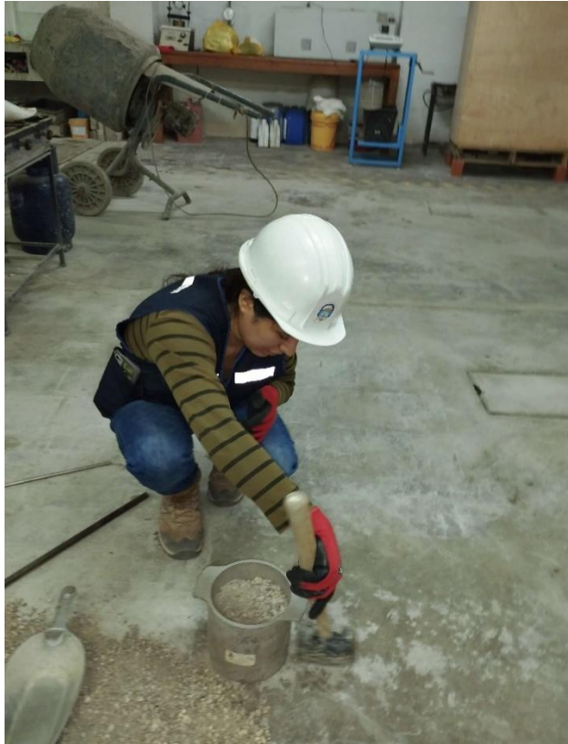
Fotografía N° 5: Peso compactado del agregado
