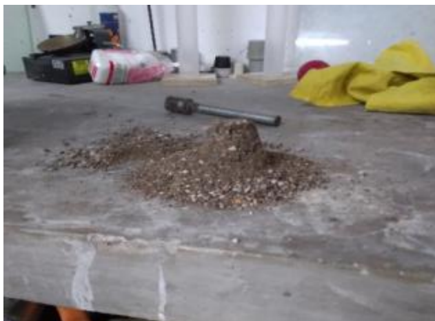
Figura N° 5. 25: Prueba del cono para el agregado fino
