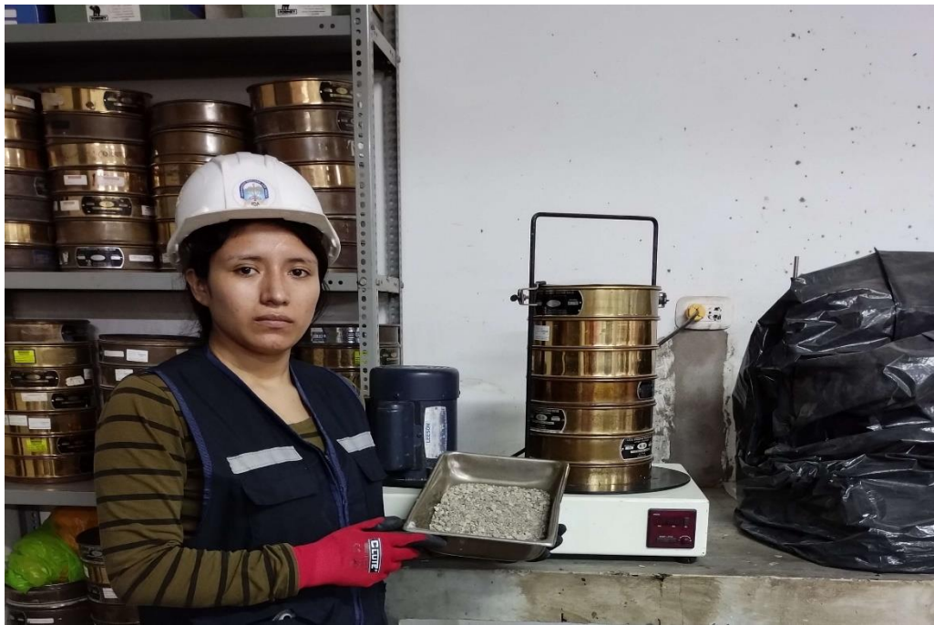
Fotografía N°4: Tamizado del agregado
