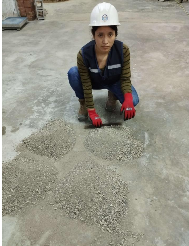
Fotografía N° 1: Cuarteo del agregado fino
