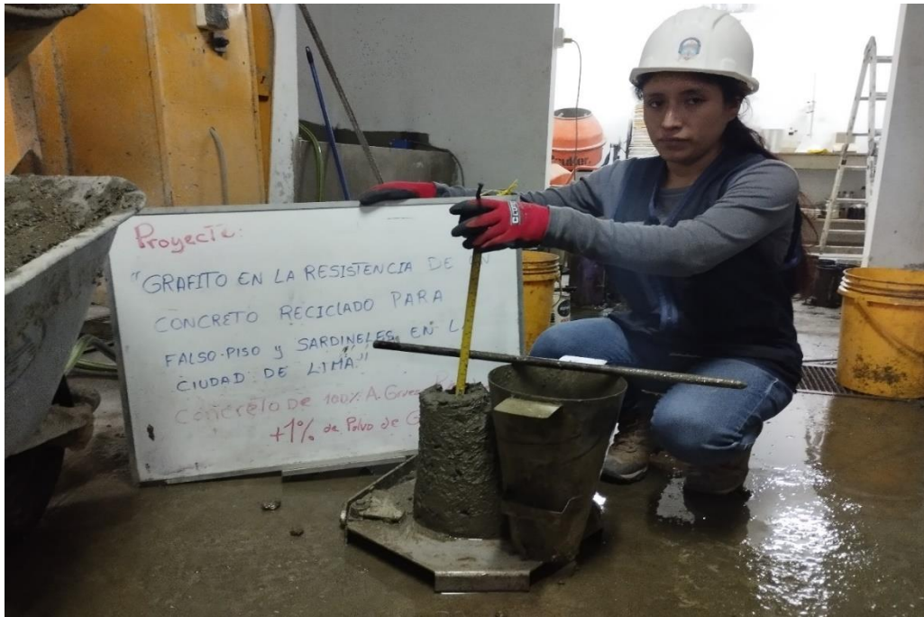
Fotografía N° 19: Slump del concreto reciclado con adición del 1% de grafito
