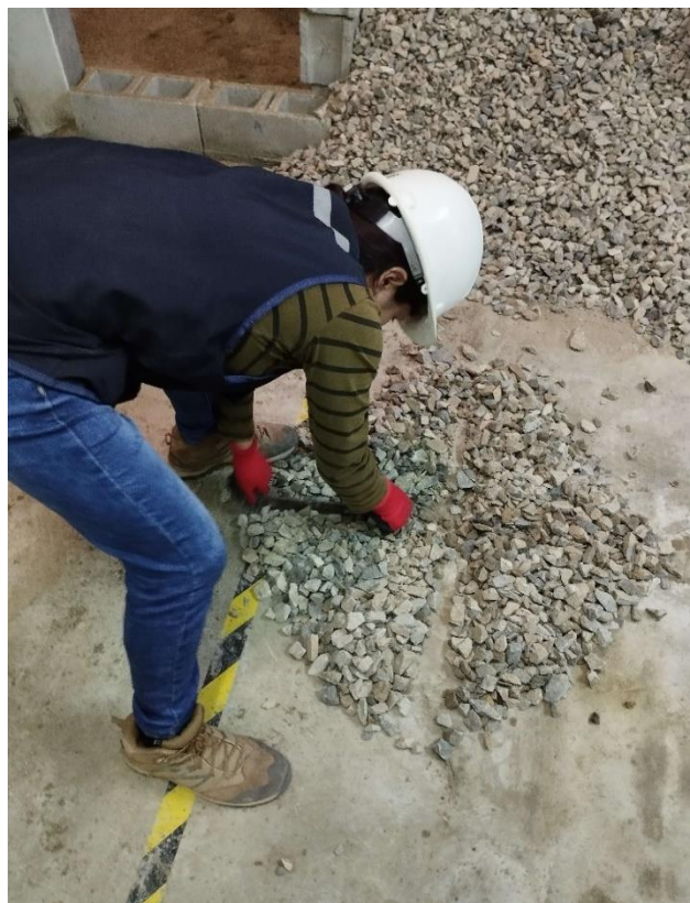
Fotografía N° 2: Cuarteo del agregado grueso
