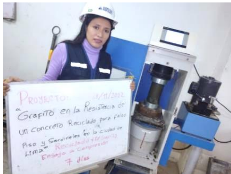
Figura N° 5. 44: Rotura de Probeta por Compresión a los 7 días
