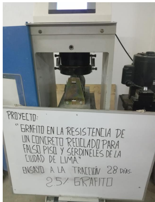
Fotografía N° 29: Ensayo de resistencia a la tracción del concreto reciclado y 1% de grafito
