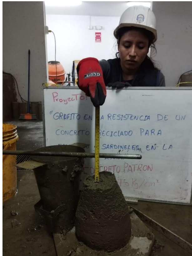
Fotografía N° 17: Prueba de Slump concreto patrón
