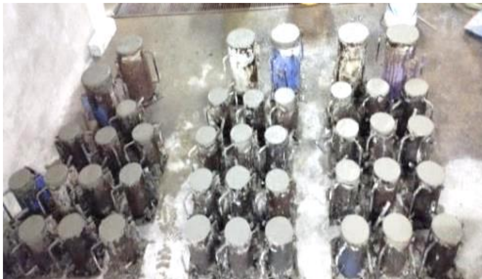
Figura N° 5. 46: Probetas para los Ensayos de Resistencia y Permeabilidad
