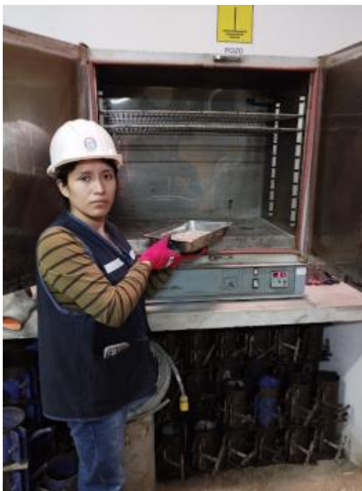
Figura N° 5. 18: Muestra de agregado fino para secado
