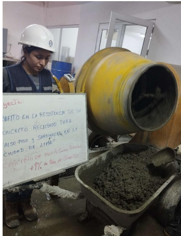
Fotografía N° 15: Mezcla del concreto reciclado con 1% de grafito
