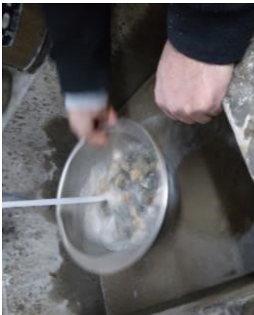
Figura N° 5. 4: Lavado del agregado grueso
