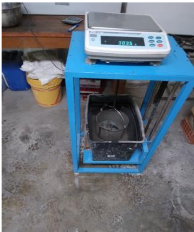
Figura N° 5. 15: Pesado del agregado sumergido.
