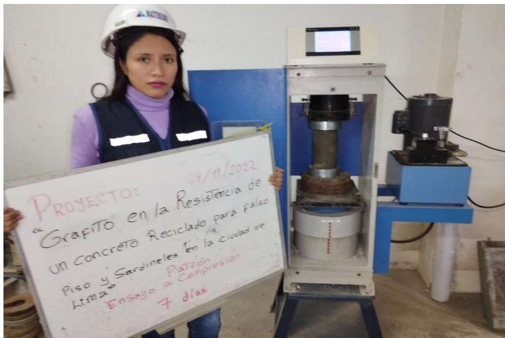
Fotografía N° 23: Resistencia a la compresión del concreto patrón
