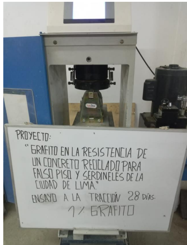
Fotografía N° 29: Ensayo de resistencia a la tracción del concreto reciclado y 1% de grafito
