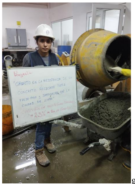
Figura N° 5. 38: Mezcla de concreto con 100% de Agregado Grueso Reciclado y la adición del 2.5% de polvo de grafito.
