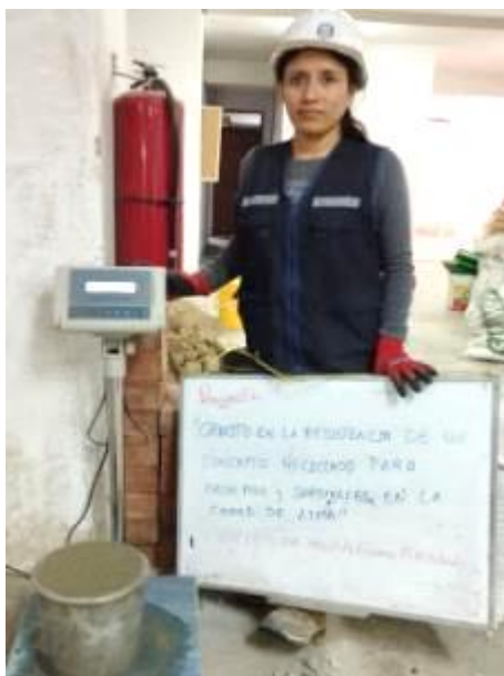
Figura N° 5. 41: Peso Unitario del concreto con 100% agregado grueso reciclado
