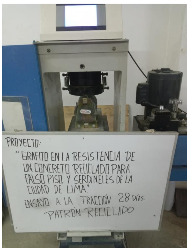
Fotografía N° 28: Ensayo de resistencia a la tracción
