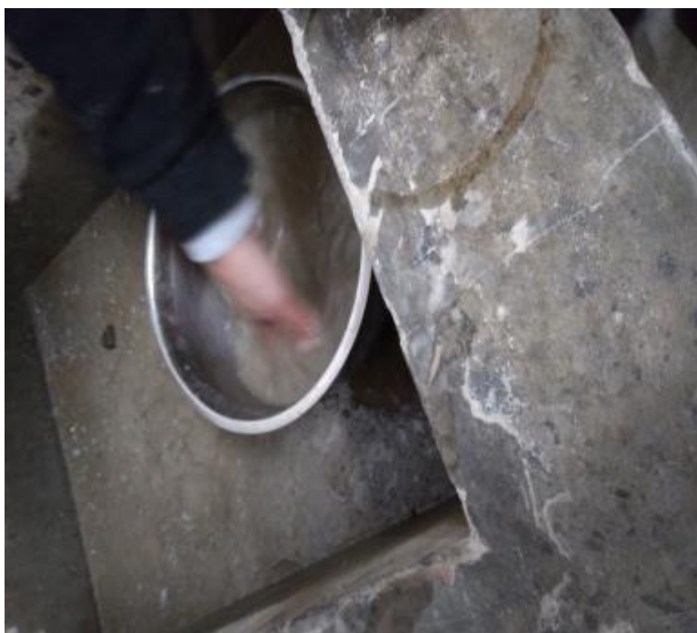
Figura N° 5. 12: Lavado del agregado grueso.
