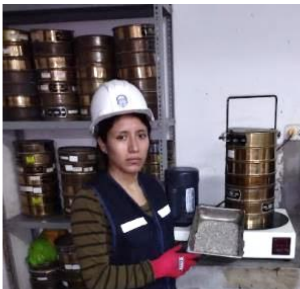
Figura N° 5. 6: Tamizado del agregado grueso
