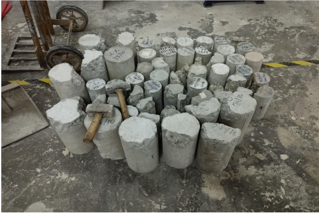
Fotografía N° 7: Probetas seleccionadas para el chancado
