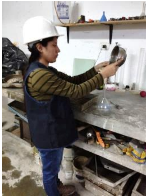
Figura N° 5. 27: Llenado del agregado fino al Picnómetro
