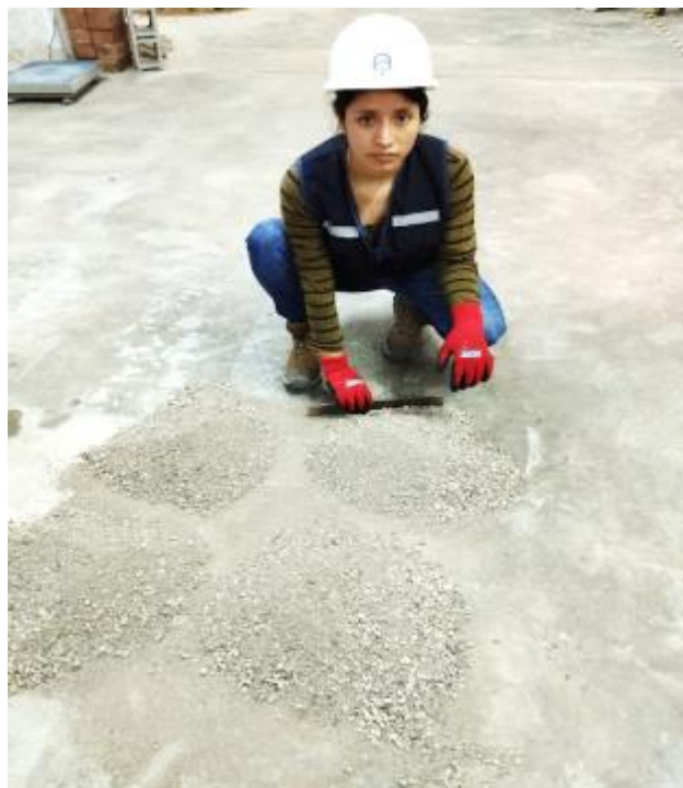
Figura N° 5. 16: Cuarteo del agregado fino.
