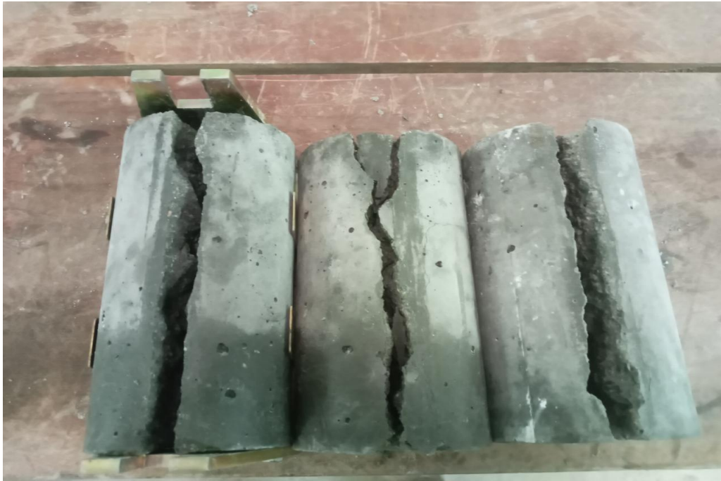
Fotografía N° 31: Rotura de probetas en resistencia a la tracción
