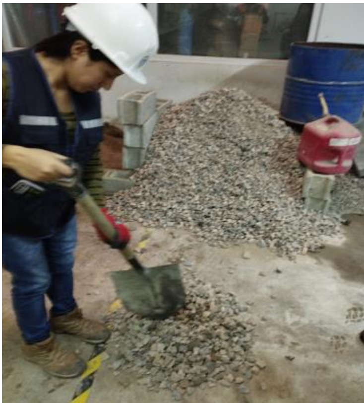
Figura N° 5. 11: Cuarteo del agregado
