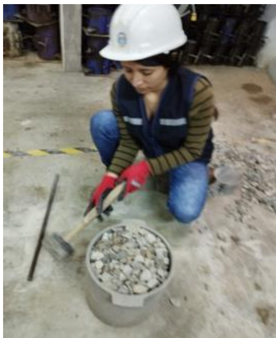
Figura N° 5. 9: Calculo del peso unitario Compactado
