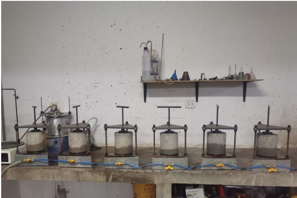
Fotografía N° 32: Ensayo de Permeabilidad de las probetas
