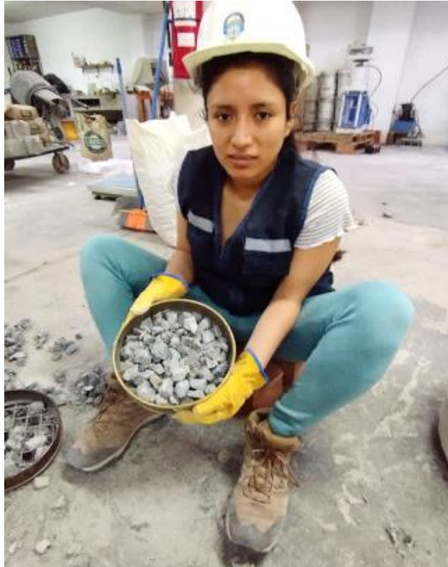
Figura N° 5. 32: Tamizado del agregado grueso reciclado.
