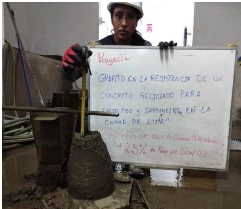
Figura N° 5. 40: Prueba del Cono de Abrams para el diseño con 2.5% de grafito.
