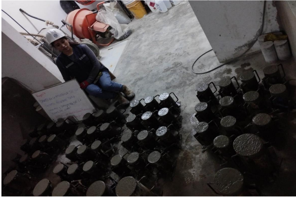
Fotografía N° 21: Probetas de los 4 diseños de concreto
