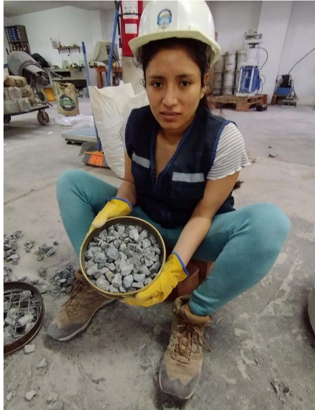
Fotografía N° 9: Tamizado del agregado reciclado
