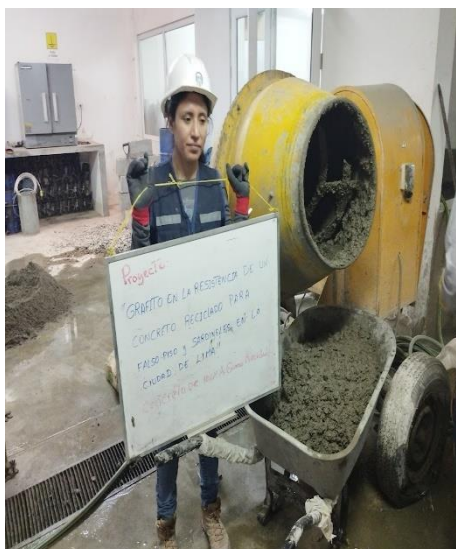
Figura N° 5. 36: Mezcla de concreto con 100% de Agregado Grueso Reciclado
