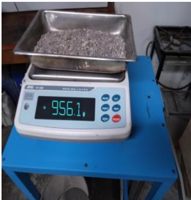
Figura N° 5. 17: Peso del agregado fino
