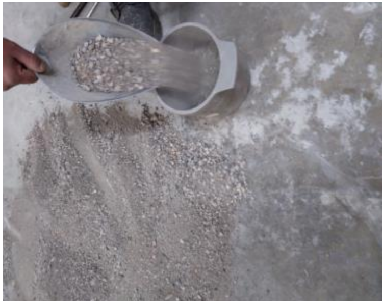
Figura N° 5. 22: Llenado del molde sin compactar
