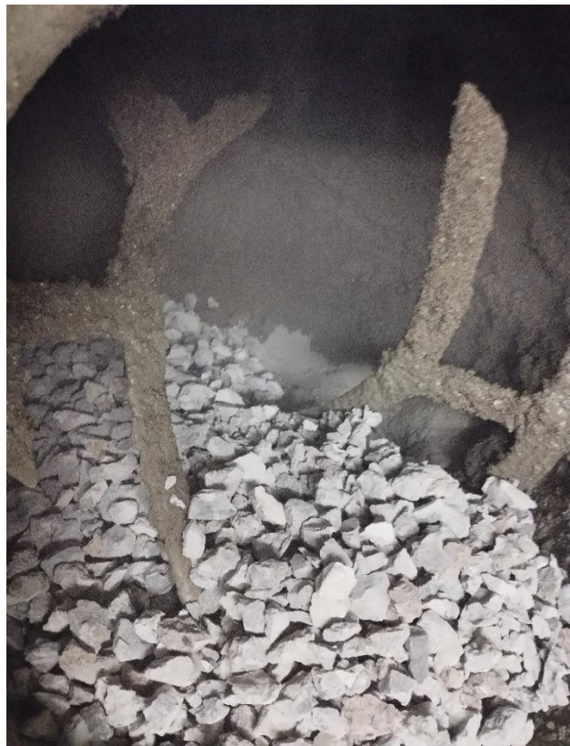
Fotografía N° 12: Agregado grueso reciclado para la mezcla
