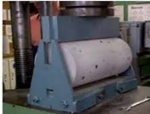
Figura N° 2. 3: Ensayo de Resistencia a la Tracción
