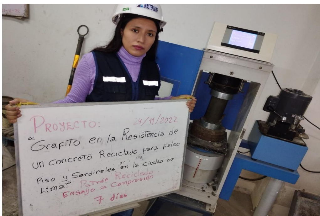
Fotografía N° 24: Resistencia a la compresión del concreto reciclado
