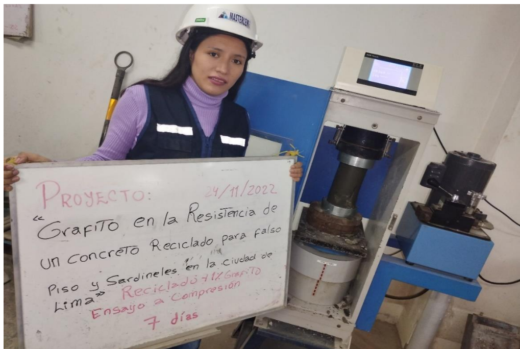
Fotografía N° 25: Resistencia a la compresión del concreto reciclado con 1% de grafito
