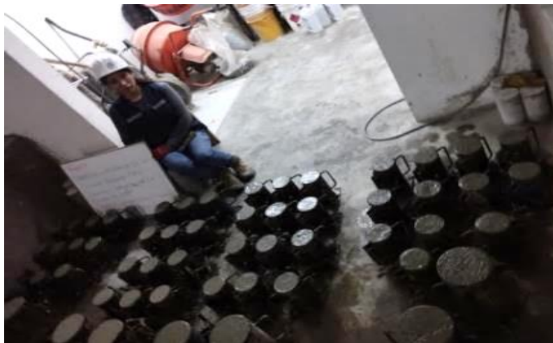
Figura N° 5. 43: Probetas para los Ensayos Recién Vaciados.
