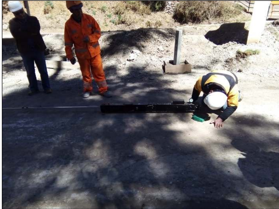
Fotografía 7. Medición de la deflexión del pavimento por medio de la viga Benkelman en el carril izquierdo de la vía.
