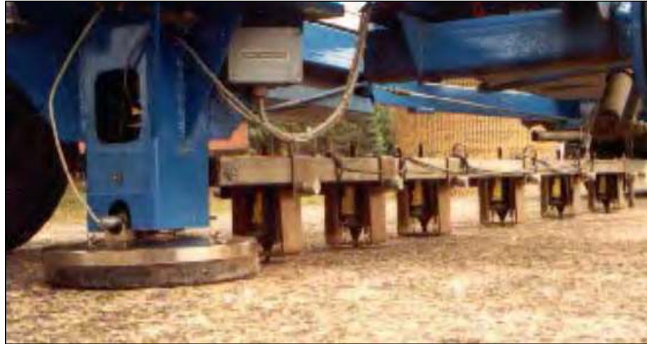
Figura 4. Ensayo de deflexión con el deflectómetro de impacto FWD. Fuente: Balarezo-Zapata (2017).
