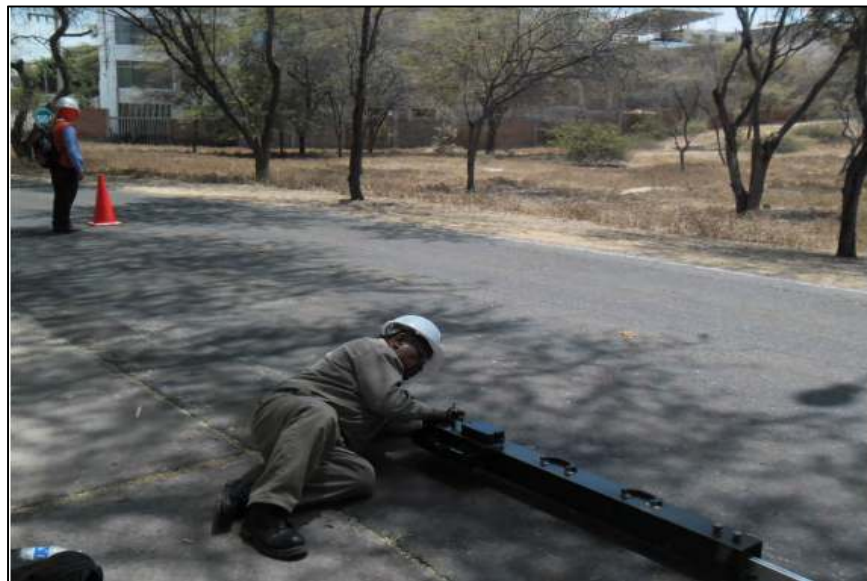
Figura 3. Ensayo de deflexión con viga Benkelman. Fuente: Balarezo-Zapata (2017).
