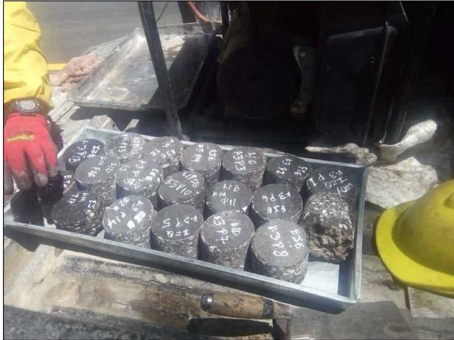
Fotografía 5. Vista de especímenes de diamantina extraídos en la vía.
