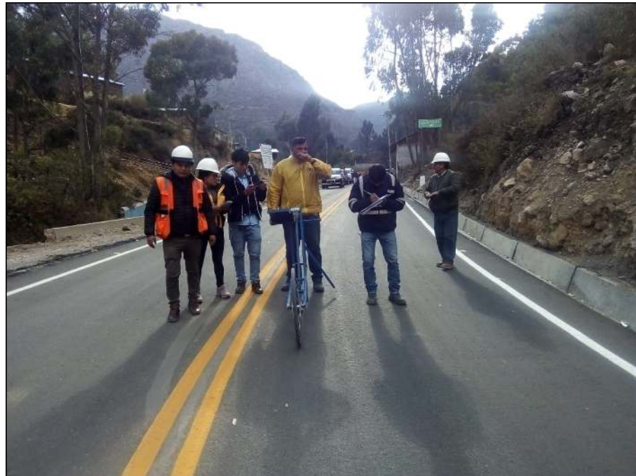
Fotografía 2. Medición de la rugosidad de la vía por medio del rugosímetro de Berlín.
