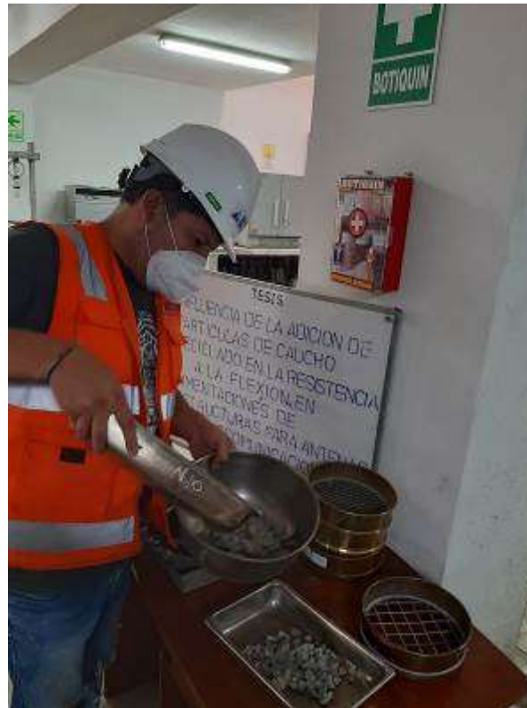
Figura 6 Tamizado manual del agregado grueso
