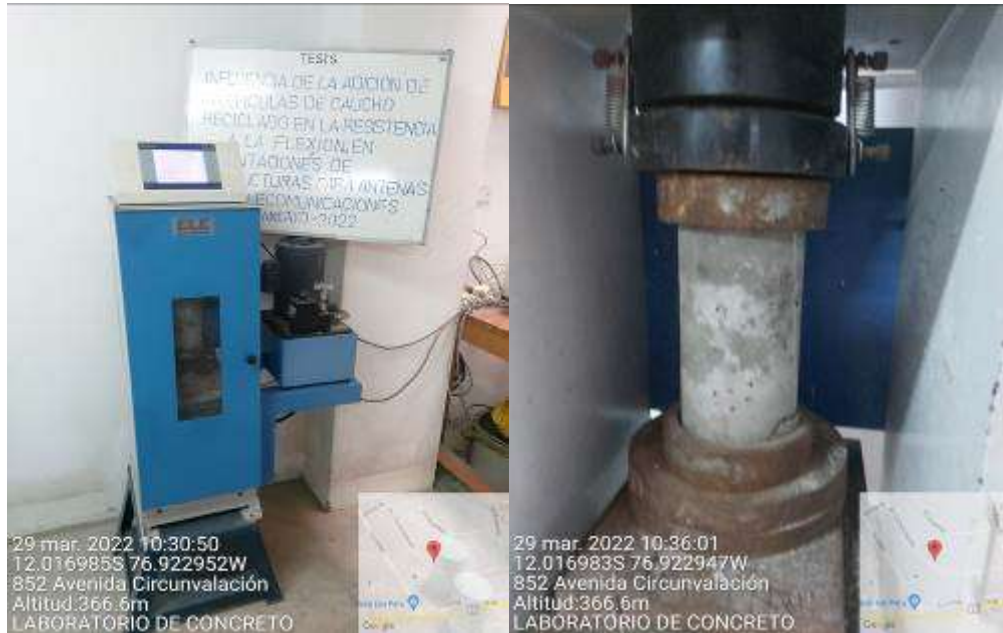
Figura 31- Rotura a compresión F'c:210 \text{ kg/cm}^2 – diseño patrón, 4%, 6%, 8%, 20% a los 14 días
