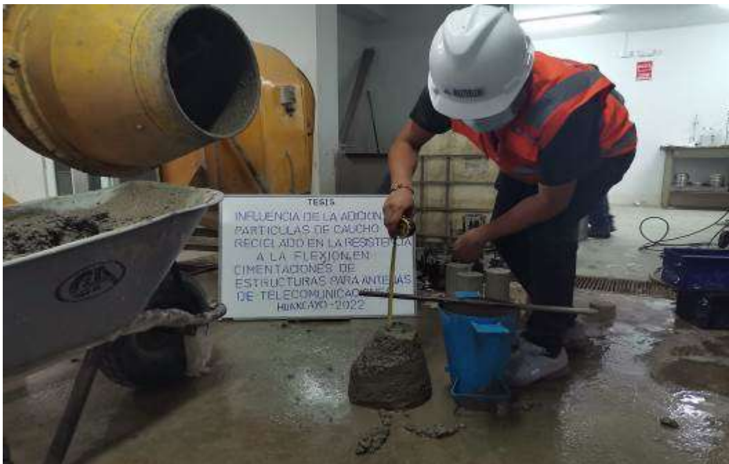
Figura 21 Verificación de slump de acuerdo con diseño de 3 a 4” - Diseño de Mezcla Patrón, 4%, 6%. 8% 20%
