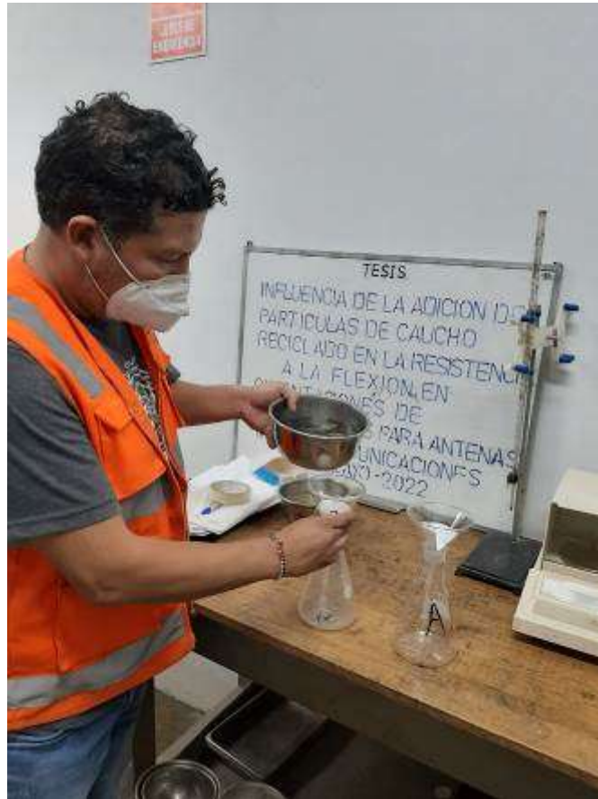
Figura 13 Lavado de agregado fino con sulfato de magnesio para ensayo de durabilidad de agregado
