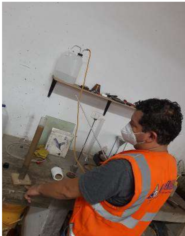
Figura 14 Ensayo de equivalente de arena en agregado fino para concreto – finos y arenas
