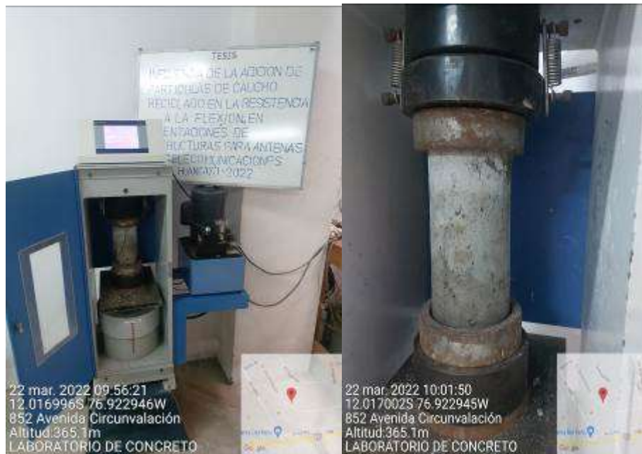
Figura 30 - Rotura a compresión F'_c :210 kg/cm 2 – diseño patrón, 4%, 6%, 8%, 20% a los 7 días
