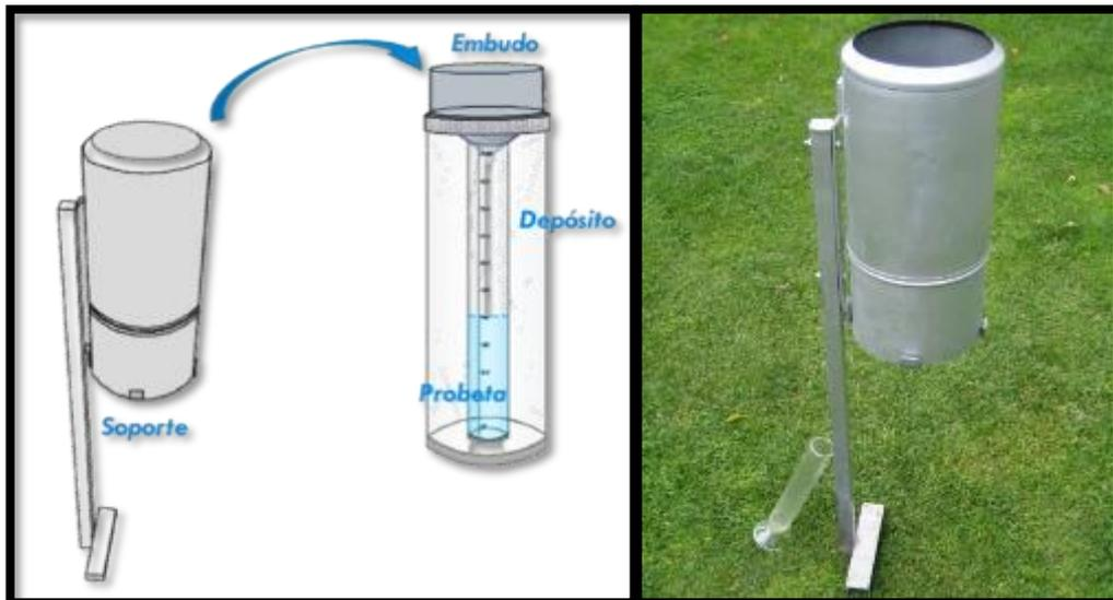
**Figura 10.** Instrumento meteorológico - pluviómetro
