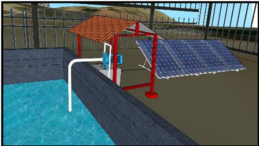
**Figura 21.** Modelamiento de los paneles solares y bomba de agua
