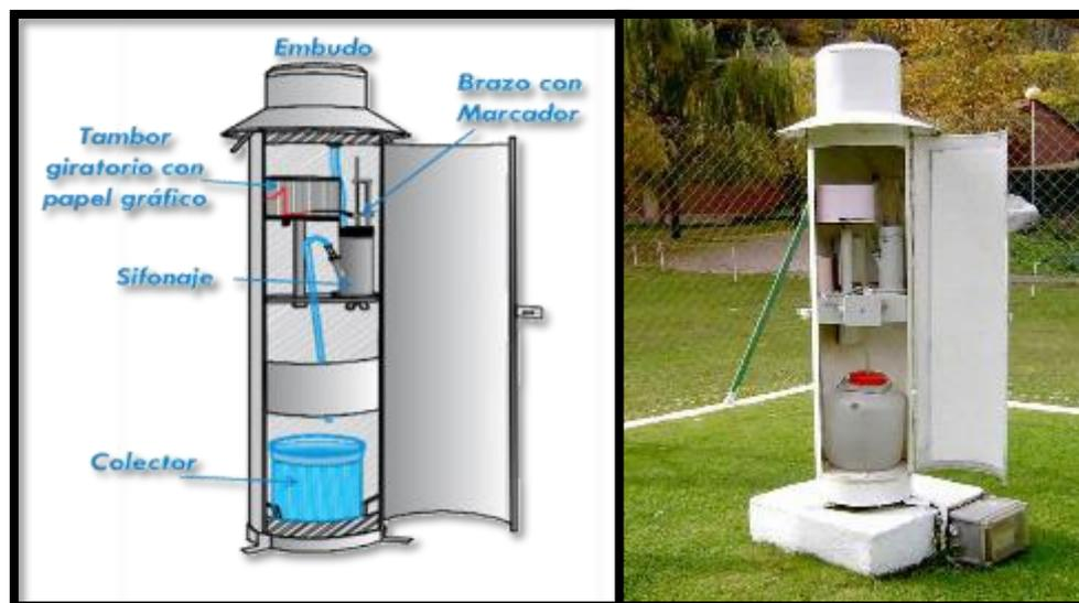
**Figura 11.** Instrumento meteorológico - pluviógrafo
