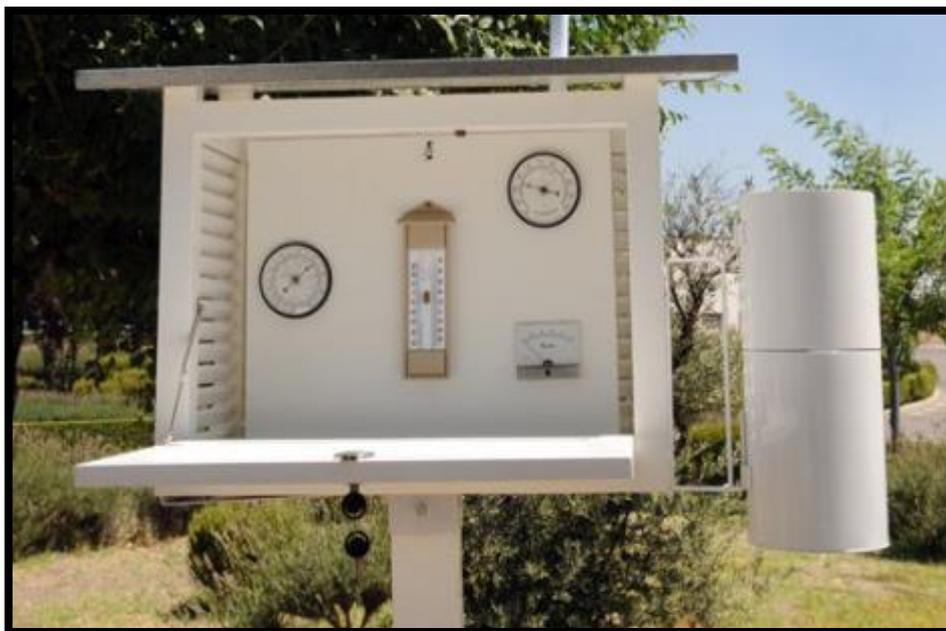
**Figura 12.** Caseta meteorológica con termómetro en su interior
