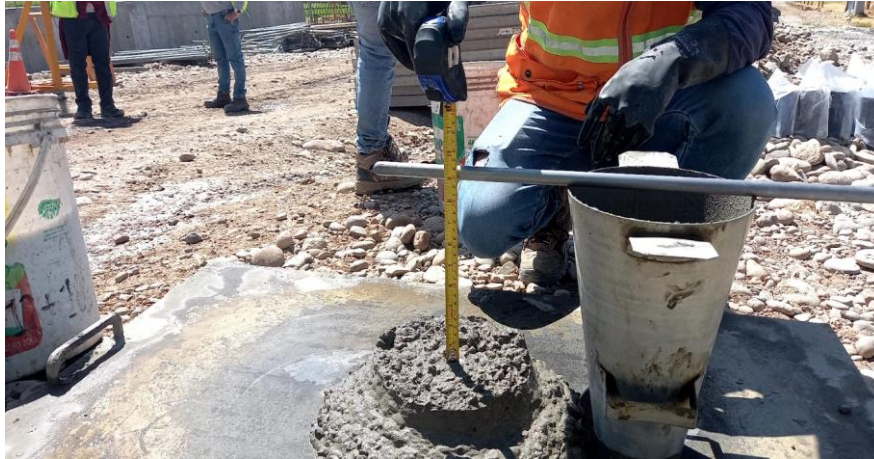
Anexo N°1 Ensayo de Slump en obra.
