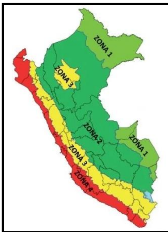
Figura 28 Determinación de la zona de sísmica en el Perú Fuente: E030 norma técnica peruana
