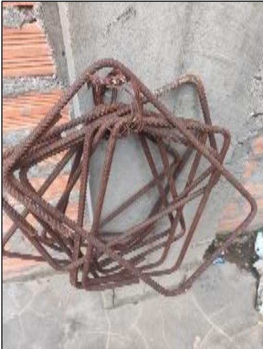
Fotografía 20: Acero de estribos a punto de ser utilizados en estado de oxidación debido a su exposición al ambiente.
