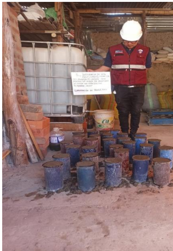
Ilustración 41. Elaboración de probetas para pruebas de tracción.
