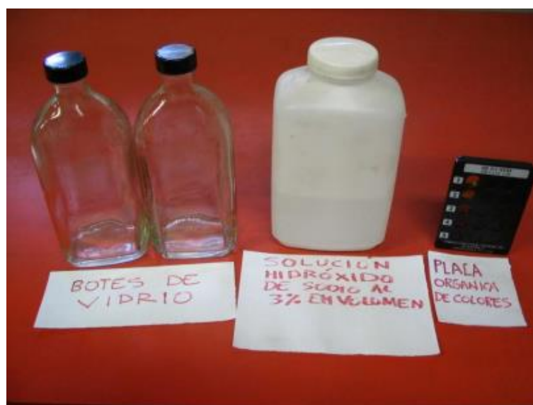
Ilustración 18. Equipo requerido para la realización del ensayo de impurezas orgánicas.
