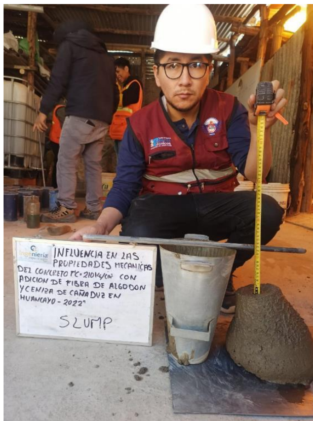
Ilustración 43. Medición de asentamiento de concreto (Slump).
