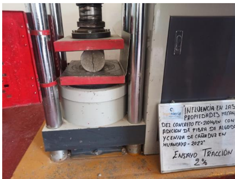
Ilustración 51. Rotura de espécimen por tracción para una probeta adicionada.
