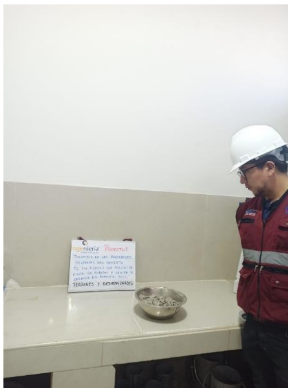
Ilustración 15. Ensayo del contenido de terrones de arcilla y partículas desmenuzables para los agregados.
