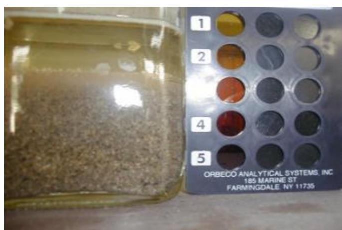
Ilustración 19. Comparación de colores por medio de una placa orgánica de colores.
