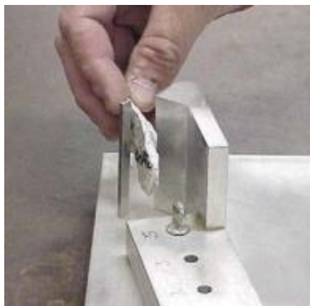
Ilustración 38. Comprobación de planeidad.
