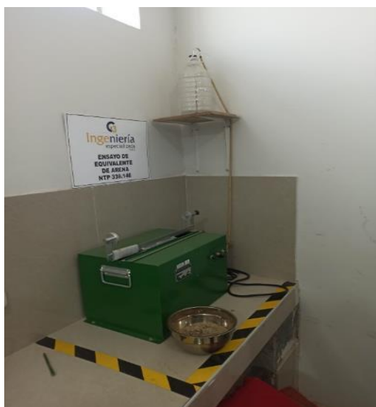
Ilustración 33. Maquinaria de apoyo para el ensayo de Equivalente de Arena.
