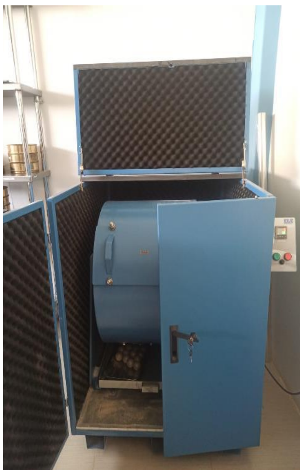
Ilustración 22. Maquina calibrada para ensayo de Abrasión Los Ángeles.
