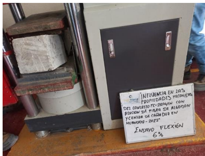
Ilustración 48. Rotura de vigas por flexión de un espécimen adicionado.
