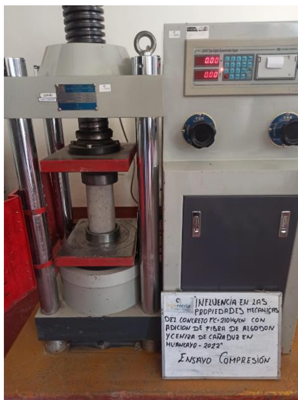
Ilustración 80. Maquinaria para rotura de probetas y vigas.
