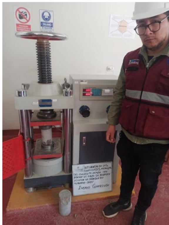
Ilustración 45. Rotura de testigo a compresión.
