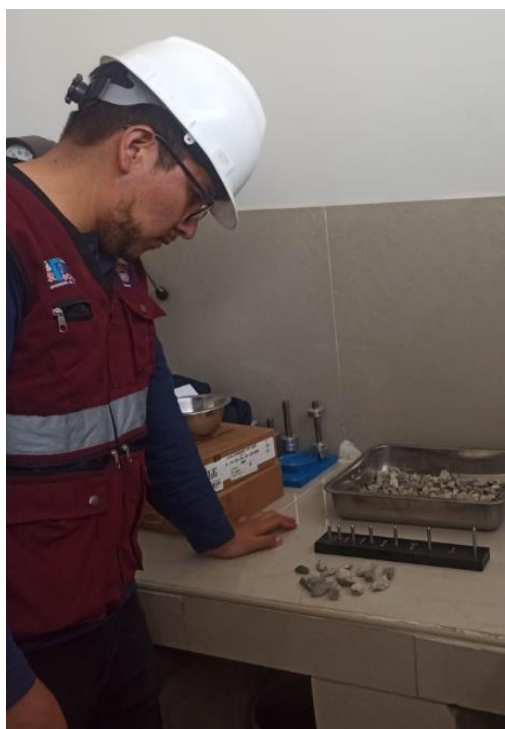
Ilustración 35. Caras fracturadas del Agregado Grueso.
