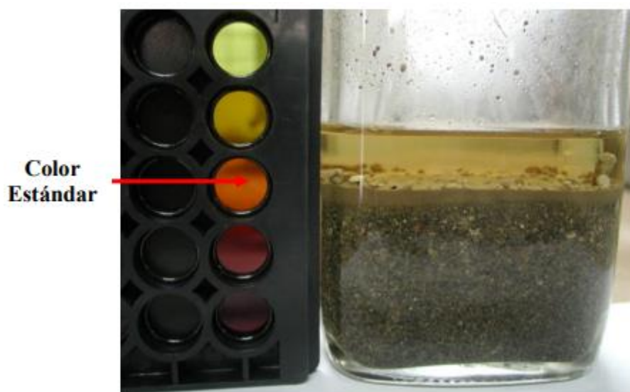
Ilustración 17. Comparación de colores entre la solución con arena (luego de 24 horas) y colores Gardner.
