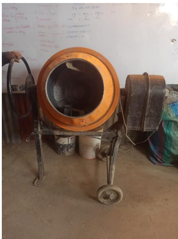
Ilustración 79. Mezclador eléctrico para elaboración de probetas y vigas a ensayar.
