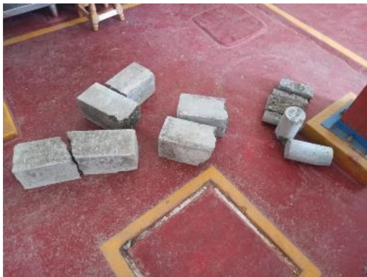
Ilustración 83. Especímenes roturados a compresión, flexión y tracción.
