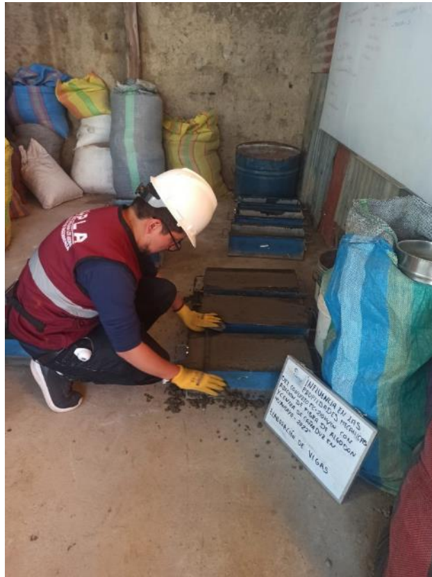
Ilustración 40. Elaboración de vigas para pruebas de flexión.
