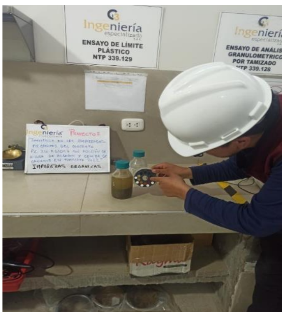
Ilustración 20. Ensayo para la determinación cualitativa de las impurezas para el agregado fino.
