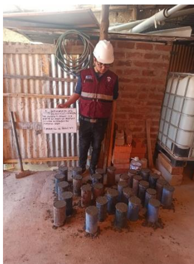
Ilustración 39. Elaboración de probetas para pruebas de compresión.
