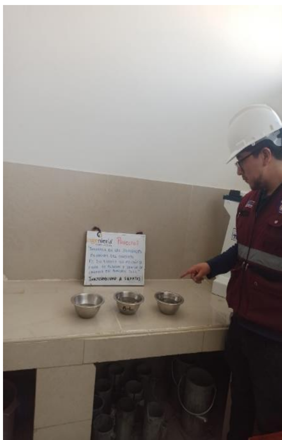
Ilustración 21. Inalterabilidad de los agregados por sulfato de sodio y sulfato de magnesio.
