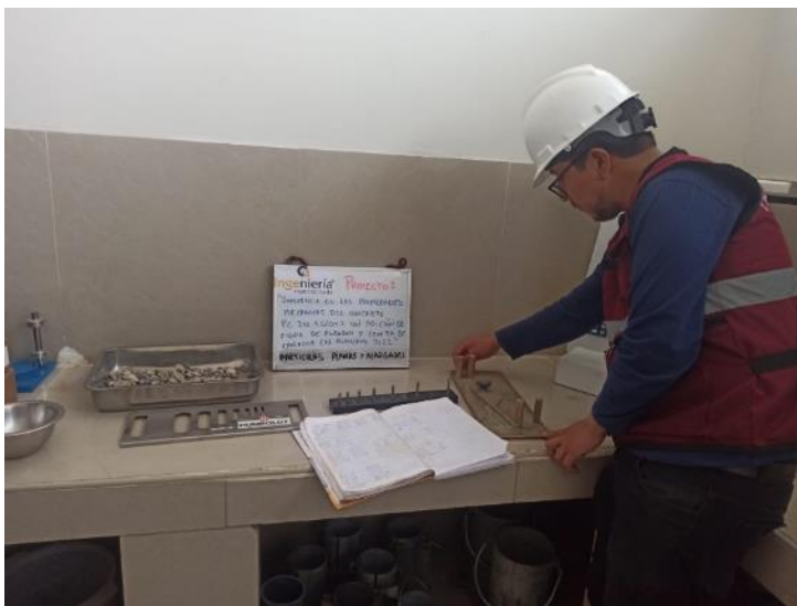
Ilustración 36. Ensayo para identificar las partículas planas y alargadas del Agregado Grueso.
