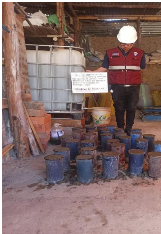
Ilustración 81. Elaboración de testigos para ensayos de compresivos y traccionarios.
