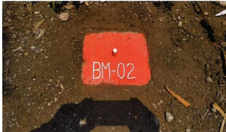
Figura N° 14: Vista del BM-02 ubicado en la Progresiva O+ 190.00 en la margen izquierda del río, al lado de la vía Oxapampa - Paucartambo.
