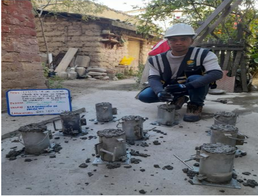
Fotografía N° 5: La fotografía muestra la elaboración de las probetas cilíndricas, se realizó para poder verificar a la resistencia a la compresión. (Se demuestra que se está trabajando con una buena dosificación de un concreto de 210 kg/cm 2 ).
