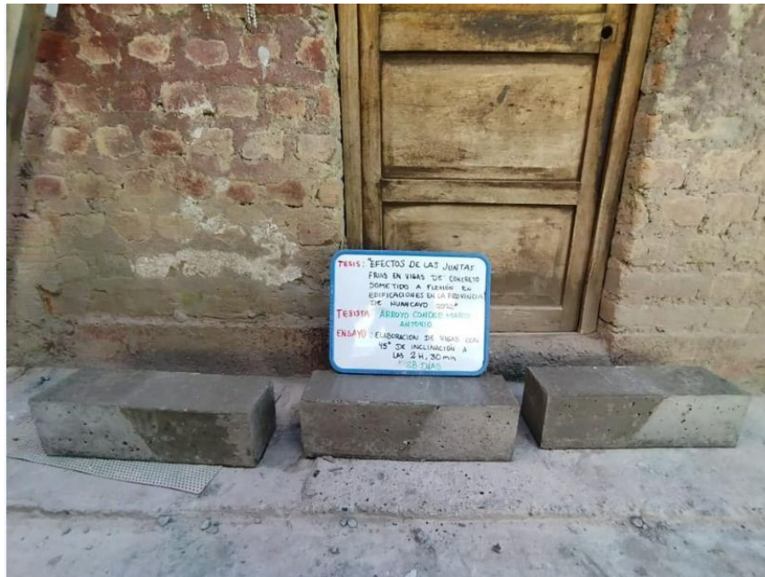
Fotografía N° 13: En la fotografía se puede observar que cuando se llena en dos tiempos las probetas prismáticas diagonales se puede evidenciar una línea dando lugar al vaciado en dos tiempos.
