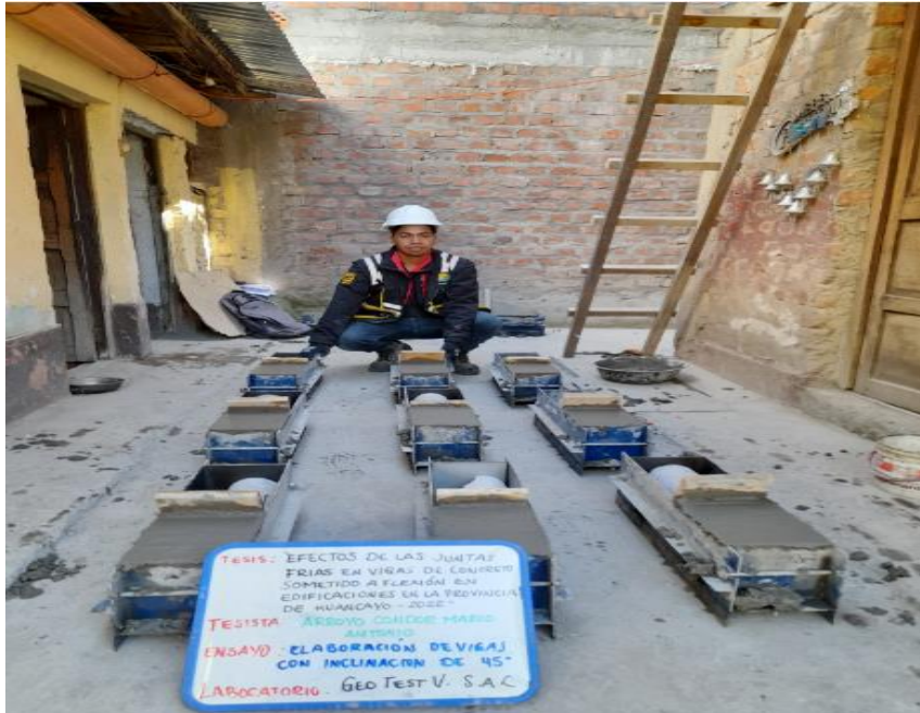
Fotografía N° 7: Se muestra la elaboración de las probetas prismáticas diagonales con interrupciones de llenado en horas, ( 2\frac{1}{2} , 5\frac{1}{2} y 24\frac{1}{2} ).
