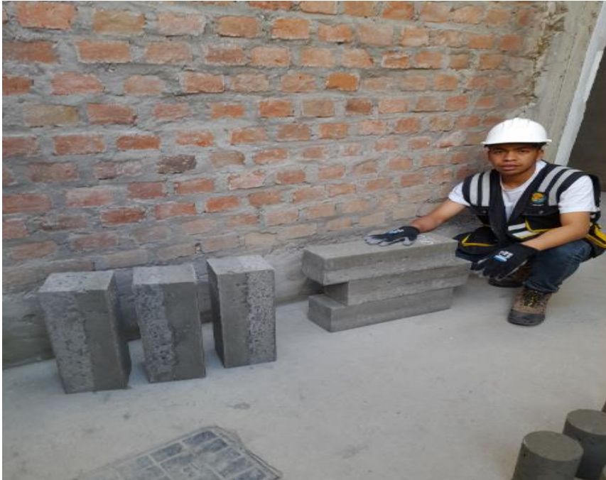
Fotografía N° 12: En la fotografía se puede observar que cuando se llena en dos tiempos las probetas prismáticas horizontales se puede evidenciar una línea dando lugar al vaciado en dos tiempos.
