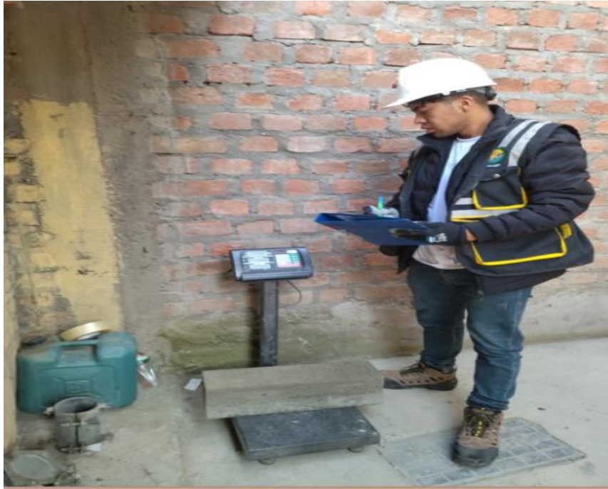
Fotografía N° 11: Se verifico el peso de la probeta prismática antes y después del curado (para poder constatar que se está cumpliendo con las medidas estándares por la norma).
