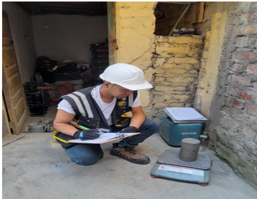
Fotografía N° 10: Se verifico el peso de la probeta cilíndrica antes y después del curado (Para poder constatar que se está cumpliendo con las medidas estándares establecidas por la norma).
