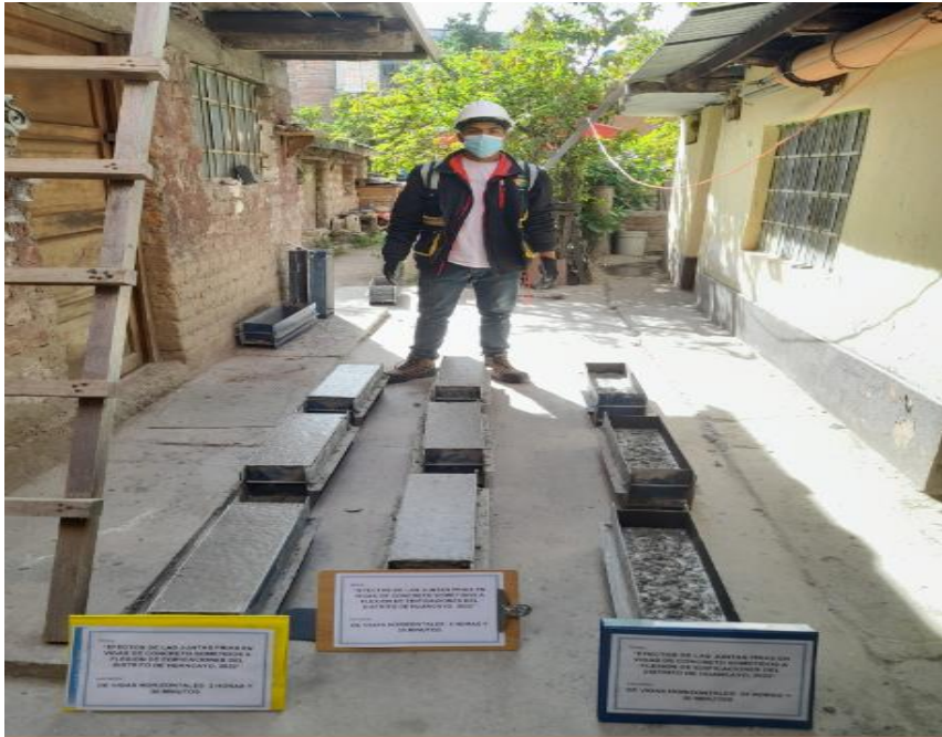
Fotografía N° 6: Se muestra la elaboración de las probetas prismáticas horizontal con interrupciones de llenado en horas, (2 ½, 5 ½ y 24 ½).
