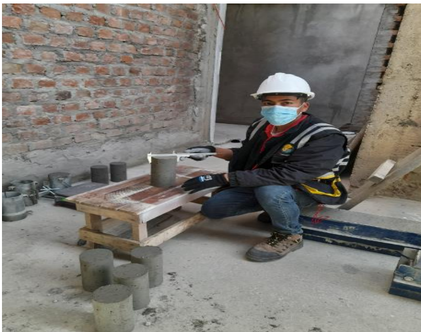
Fotografía N° 8: Se verifico las Medida de las probetas cilíndricas con el Vernier para poder comprobar si efectivamente cumple con las medidas estándares de 4" x 8" antes de ser sometido al ensayo de la resistencia a la compresión.
