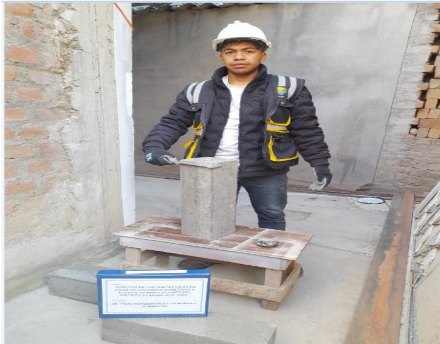
Fotografía N° 9: Se verifico las Medida de las probetas prismáticas con el Vernier para poder comprobar si efectivamente cumple con las medidas estándares de 50*15*15 cm antes de ser sometido al ensayo de la resistencia a la flexión.
