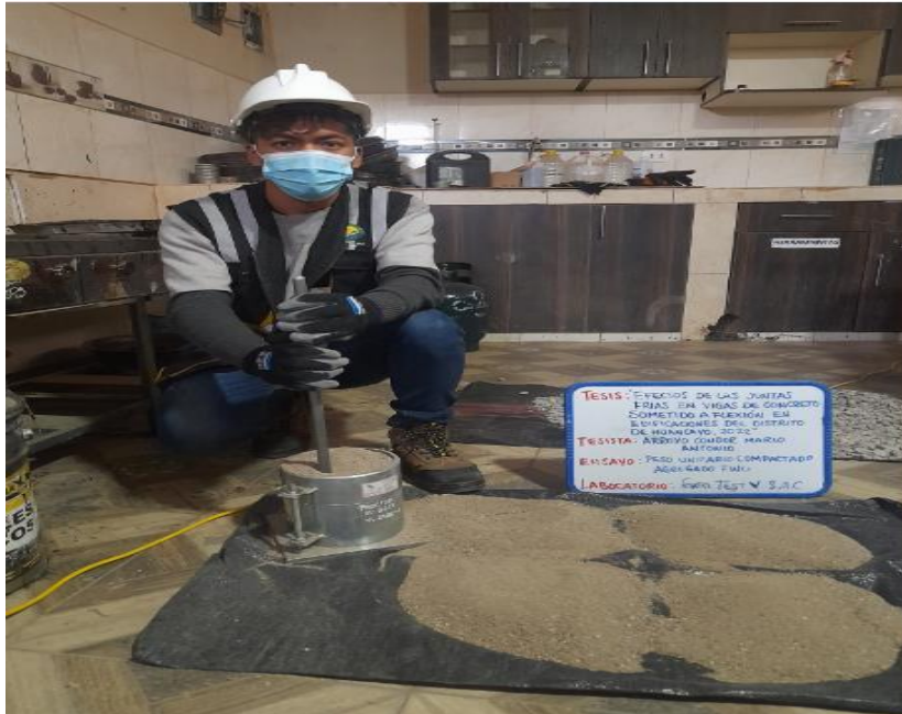
Fotografía N° 2: Se realizó el peso unitario suelto del agregado fino basado en la norma del ASTM C29 para determinar la densidad bulk (peso unitario) del agregado fino en condición compactada y suelta), para calcular los vacíos entre las partículas (agregado fino y agregado grueso).
