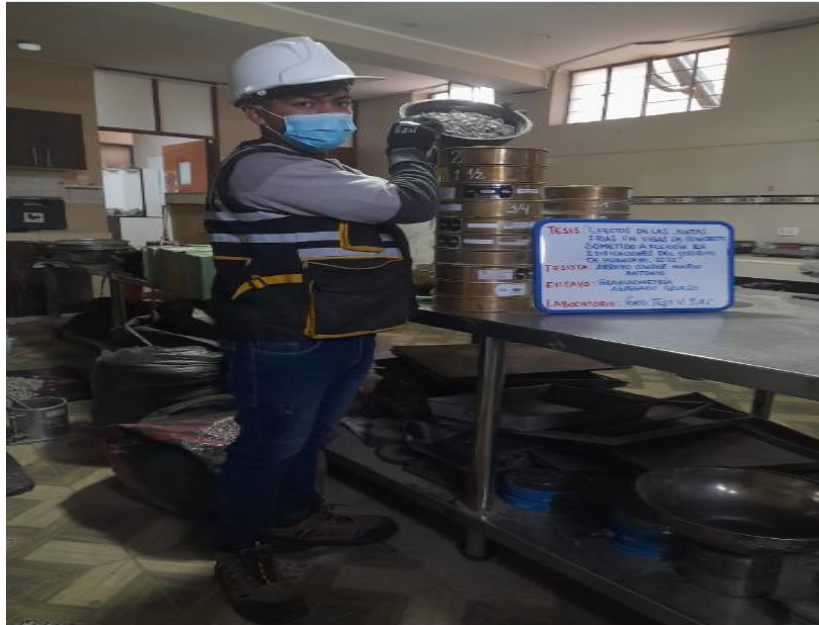
Fotografía N° 1: Se procedió al ensayo de granulometría manual para poder separar las partículas constituidas del agregado según tamaños por tamices. De tal manera que se puedan conocer las cantidades en peso de cada tamaño que aporta el peso total.
