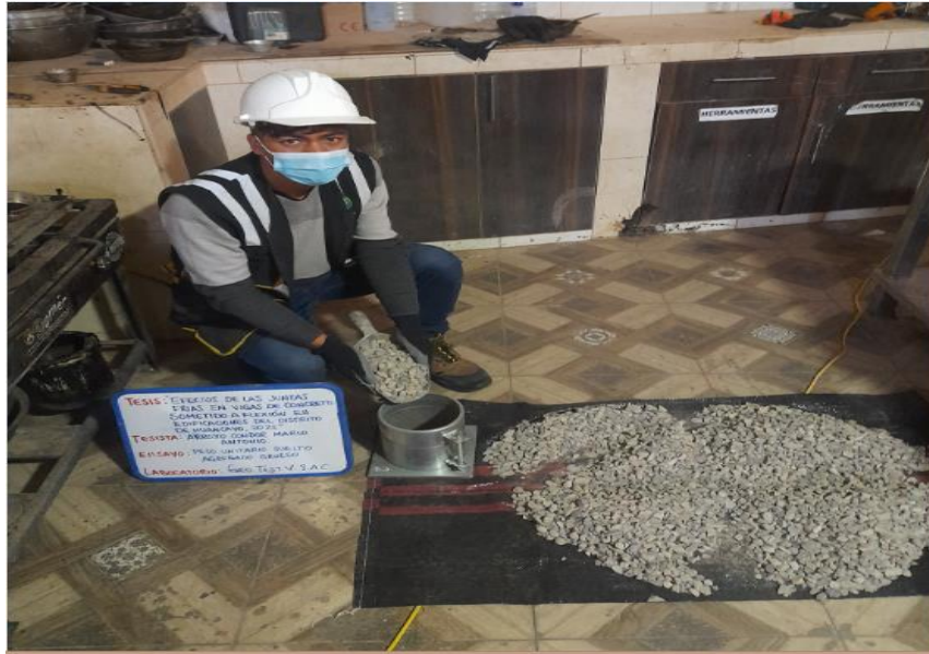
Fotografía N° 3: Se realizó el peso unitario suelto del agregado grueso basado en la norma del ASTM C29 para determinar la densidad bulk (peso unitario) del agregado grueso en condición compactada y suelta), para calcular los vacíos entre las partículas (agregado fino y agregado grueso).
