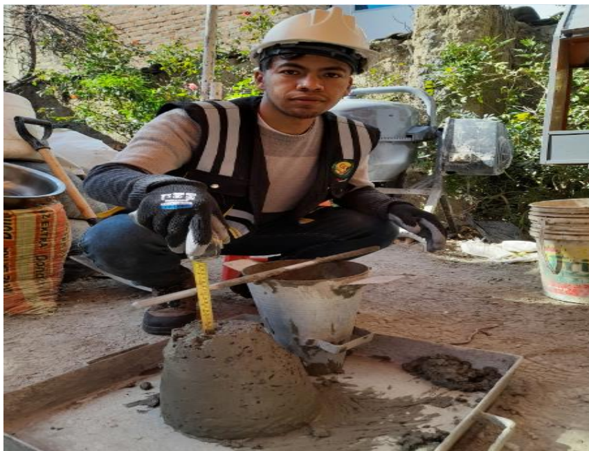
Fotografía N° 4: Se procedió con la Prueba de Slump según la norma ASTM C143-78, el ensayo se realizó para poder determinar la consistencia del concreto y su fluidez, (El asentamiento obtenido fue de 4 pulgadas).
