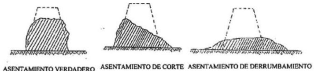
Figura N° 14: Ensayo de consistencia del hormigón
