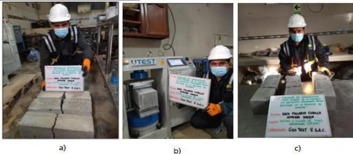
Fotografía N° 23: Viguetas impuestas a esfuerzos a flexotracción en un periodo de: a) 168 hr, b) 366hr y c) 672 hr.
