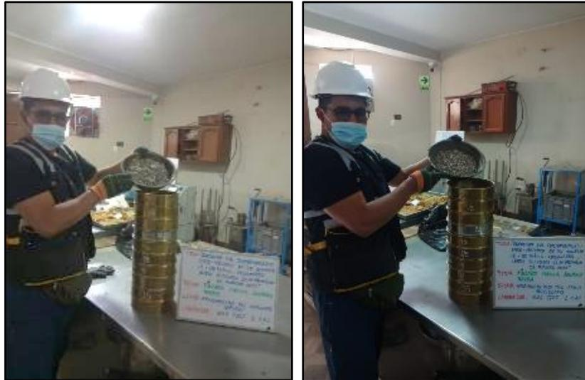
Fotografía N°3: Evaluación de los agregados gruesos y análisis de agregados reciclados
