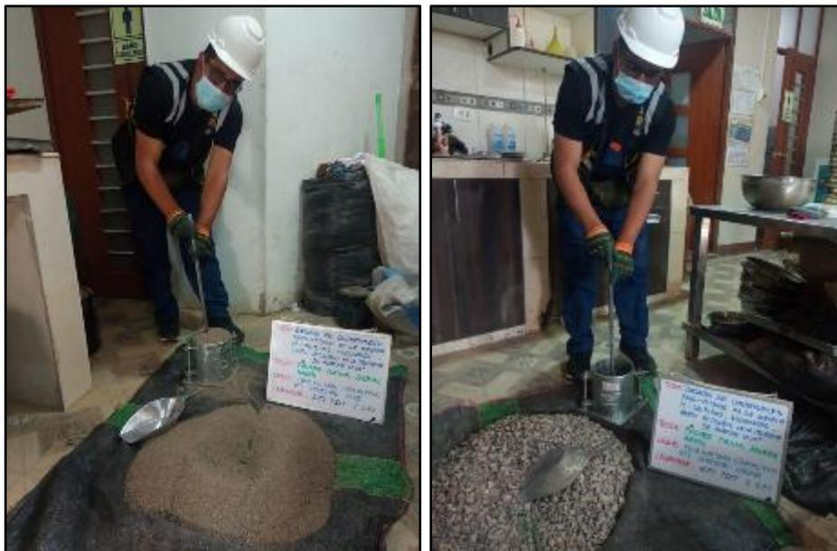
Fotografía N° 6: Compactado del agregado fino y grueso para el análisis del porcentaje de los vacíos
