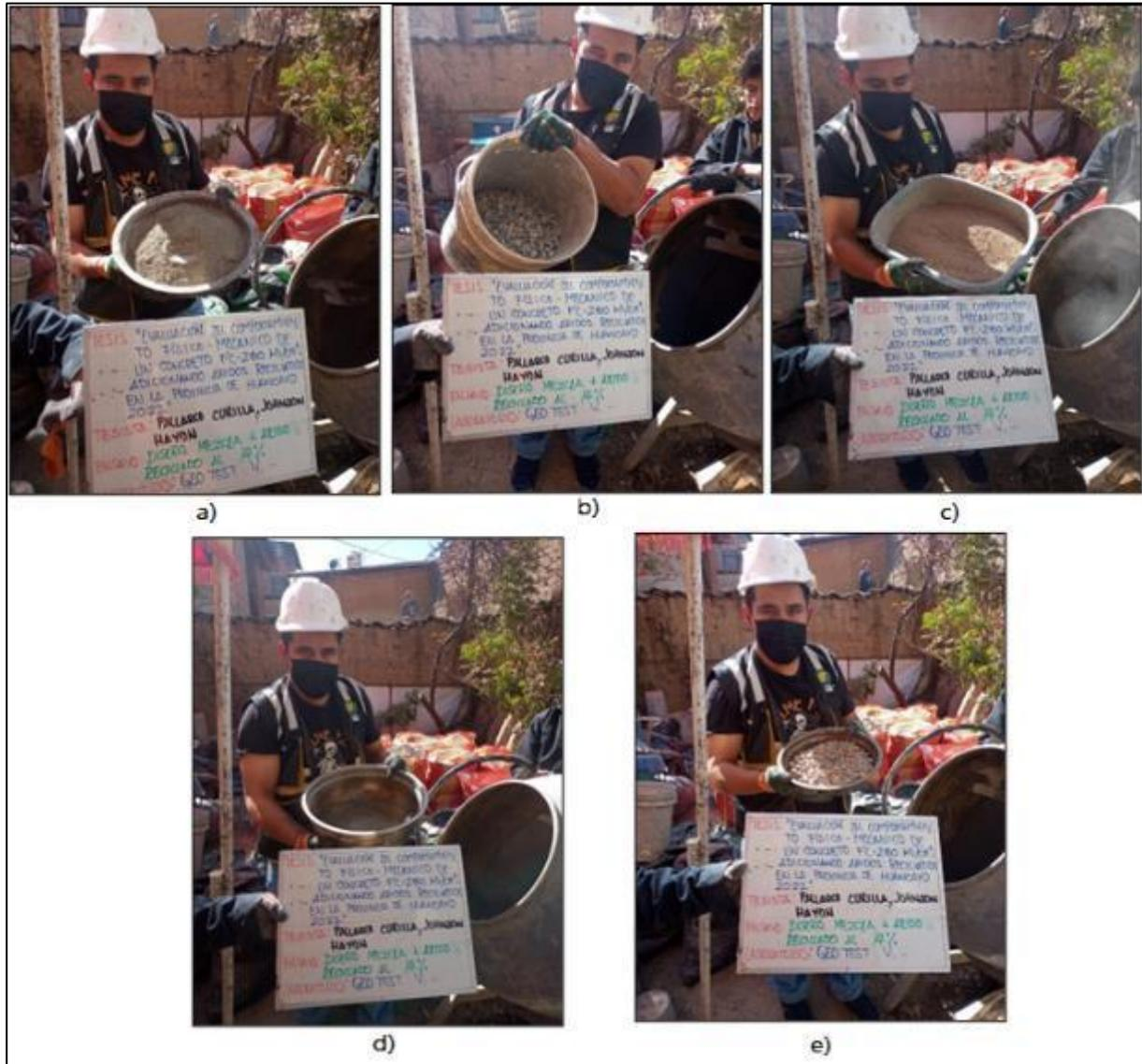
Fotografía N° 17: a) Cemento, b) AG, C) AF, d) Agua y e) Agregado reciclado
