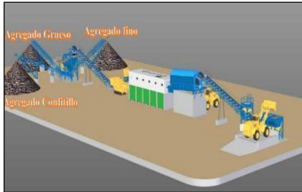
Figura N° 7: Planta de producción del árido reciclado
