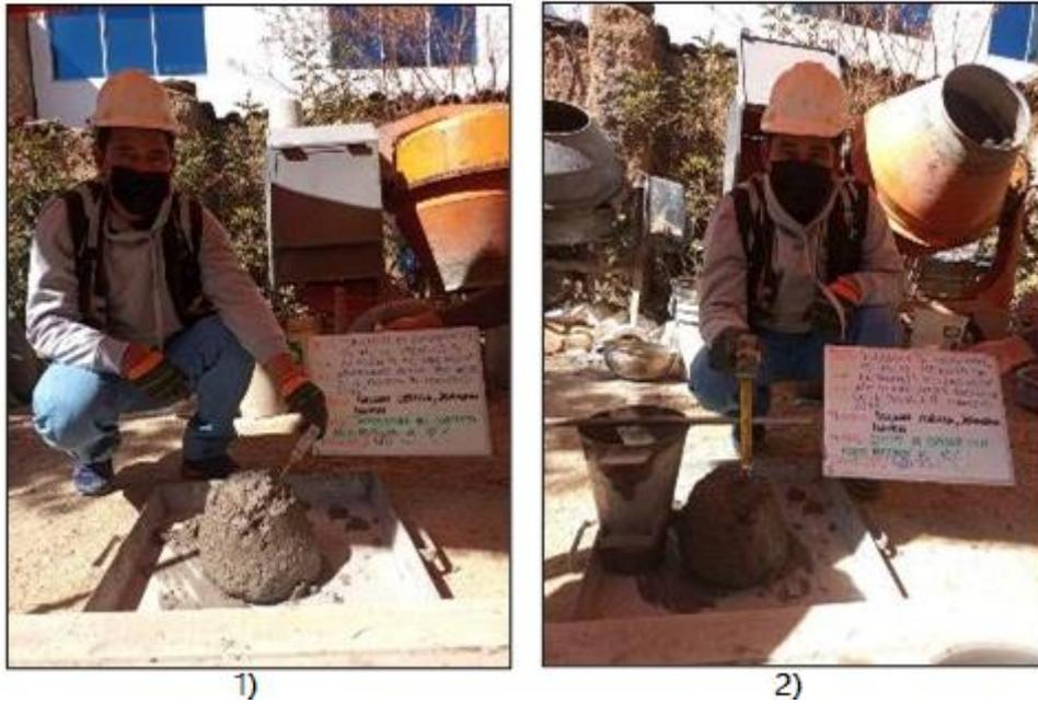
Fotografía N° 12: Temperatura de la mezcla con 10% de árido y 2) asentamiento
