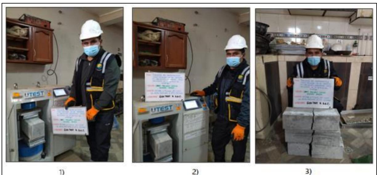
Fotografía N° 26: Viguetas impuestas a esfuerzos s flexotracción en: 1) 168 hr, 2) 366hr y 3) 672 hr.
