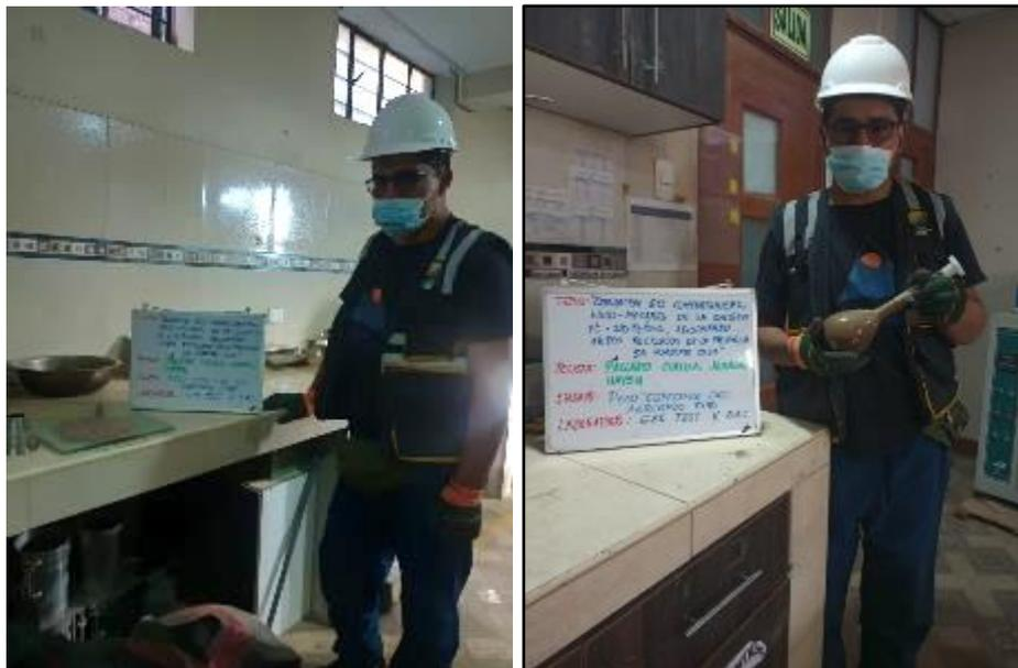
Fotografía N° 4: Uso de molde cónico metálico con un diámetro de  $40\pm 3$ mm de diámetro, para evaluar el peso específico y absorción del agregado fino.
