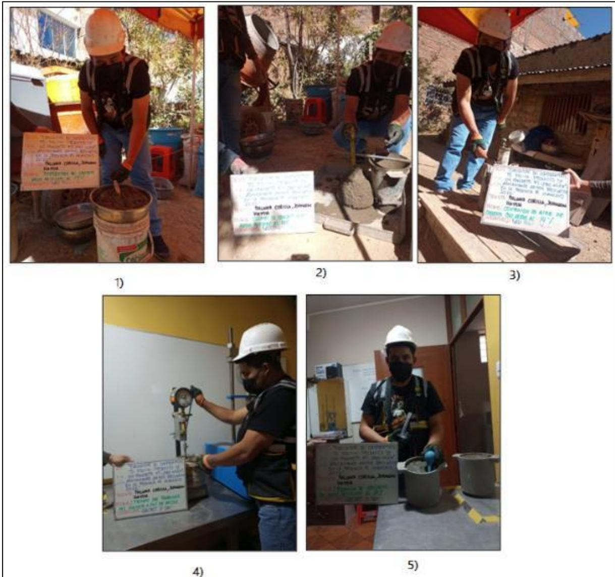
Fotografía N° 18: Evaluación de: 1) Temperatura, 2) Asentamiento, 3) Contenido de aire, 4) Tiempo de fragua y 5) Exudación
