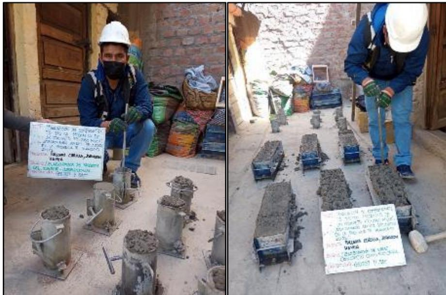
Fotografía N° 10: La mezcla en fresco se llenará en tres capas al molde hasta lograr un molde perfecto y proceso de elaboración de vigas de concreto.
