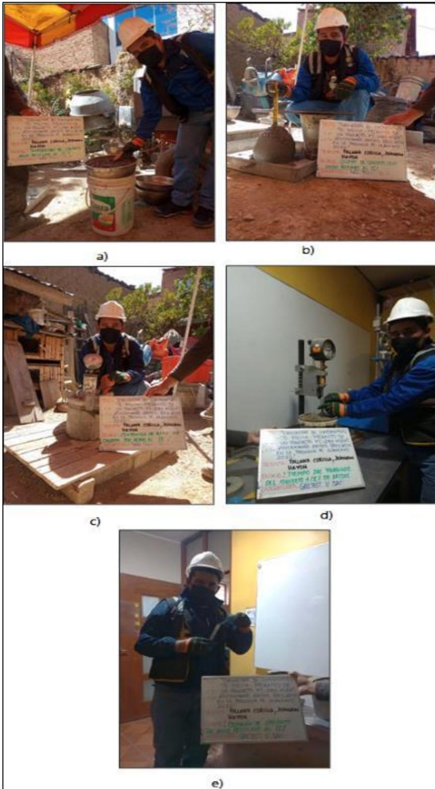
Fotografía N° 16: a) Medición de la temperatura, b) evaluación del asentamiento, c) contenido de aire, d) Tiempo de fragua, e) exudación del concreto
