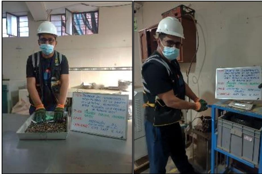
Fotografía N° 5: Evaluación del agregado grueso a emplear en la mezcla, agregado sumergido en canastilla a 23°C.
