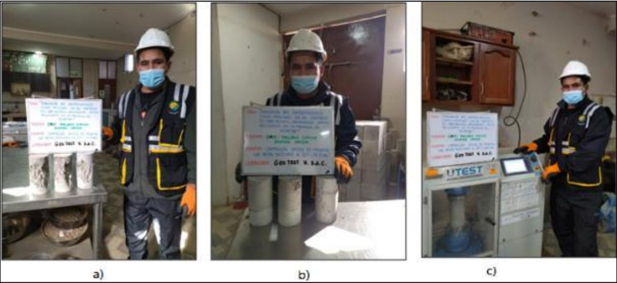
Fotografía N° 20: Pruebas cilíndricas en un periodo de: a) 7 días, b) 14 días y c) 28 días
