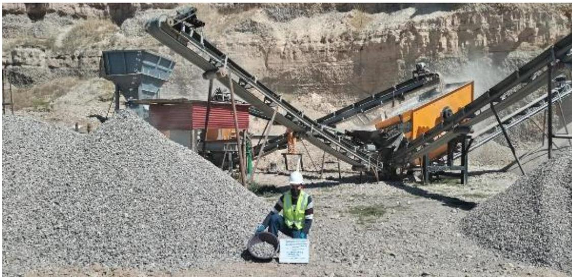
Fotografía N° 1: Trituradora de material de residuo de construcciones.
