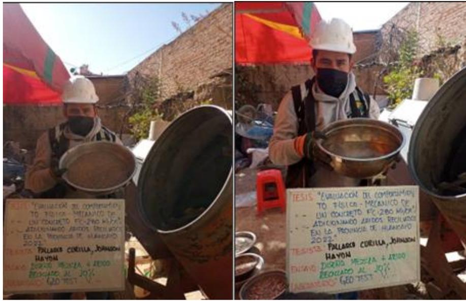
Fotografía N° 11: Cemento, agregado fino y grueso, agua y áridos reciclados
