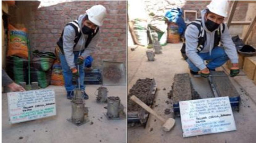
Fotografía N° 14: Proceso de preparación de vigas y probetas de concreto.
