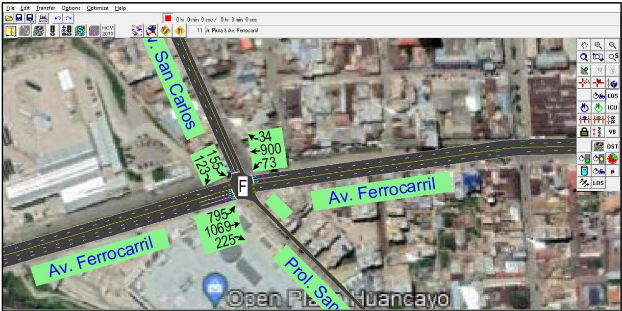
Nivel de Servicio en el que está operando la Intersección de la Av. Ferrocarril y la Jr. Piura, según parámetros del synchro 8.0 es igual a F.
