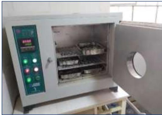
Fotografía 5. Agregados puestos en el horno para determinar el contenido de humedad en los mismos.
