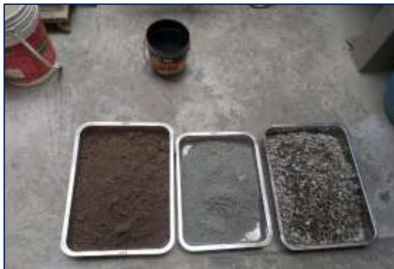
Fotografía 19. Vista de los materiales para la elaboración de la mezcla de concreto convencional.
