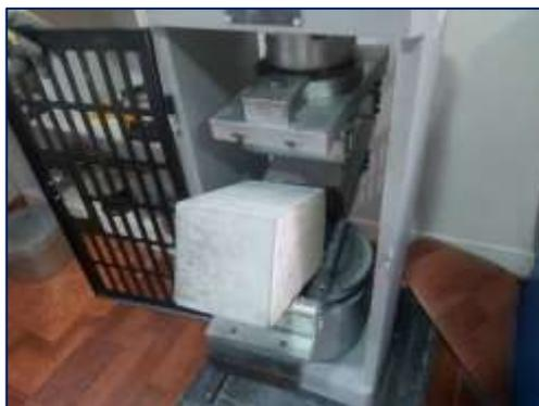
Figura 5. Vista del ensayo para determinar la resistencia a flexo tracción del concreto autocompactante.
