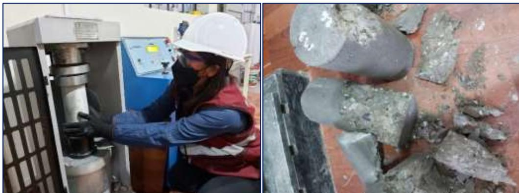
Fotografía 39. Rotura de probetas de concreto con 20 % de PVC.
