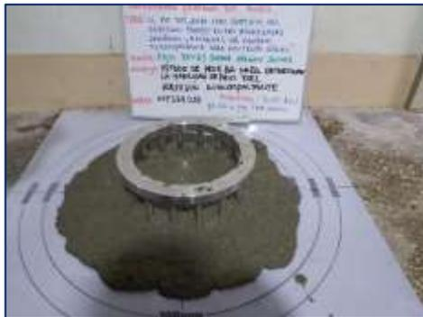
Fotografía 31. Medición de la habilidad de paso del concreto autocompactante con 20 % de PVC.
