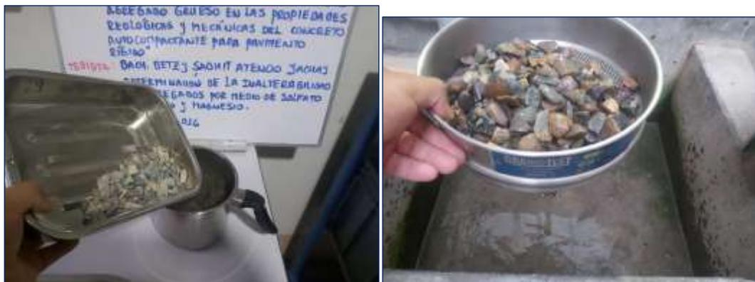
Fotografía 12. Ensayo de inalterabilidad de los agregados ante los sulfatos de sodio y de magnesio.
