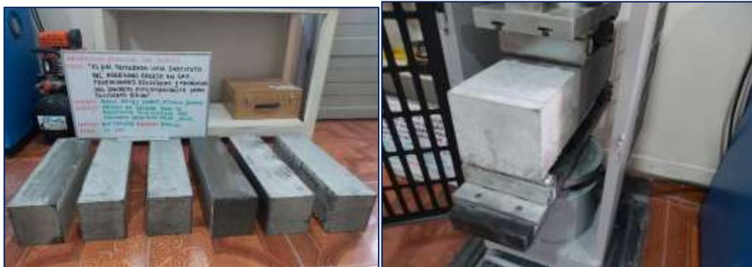
Fotografía 41. Rotura de vigas del concreto autocompactante convencional.
