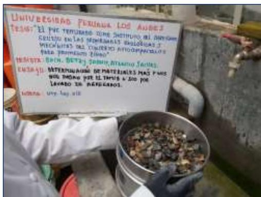
Fotografía 17. Ensayo para determinar la cantidad de agregados finos menores al tamiz N° 200.
