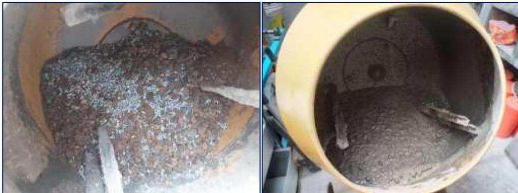
Fotografía 24. Elaboración del concreto autocompactante con 5 % de PVC.
