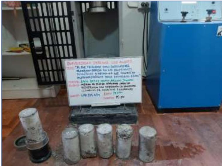
Fotografía 40. Rotura de probetas de concreto con 40 % de PVC.
