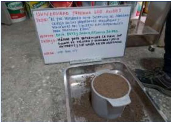
Fotografía 9. Vista de la determinación del peso unitario e índice de vacíos del agregado fino.
