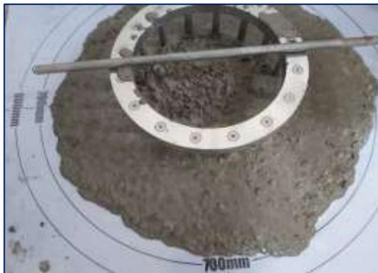
Fotografía 27. Medición de la habilidad de paso del concreto autocompactante con 5 % de PVC.
