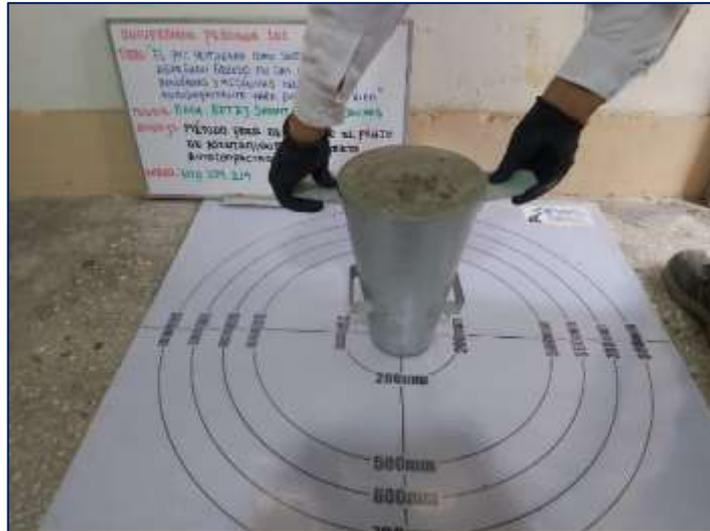
Figura 2. Vista del ensayo de flujo de asentamiento en el concreto autocompactante.
