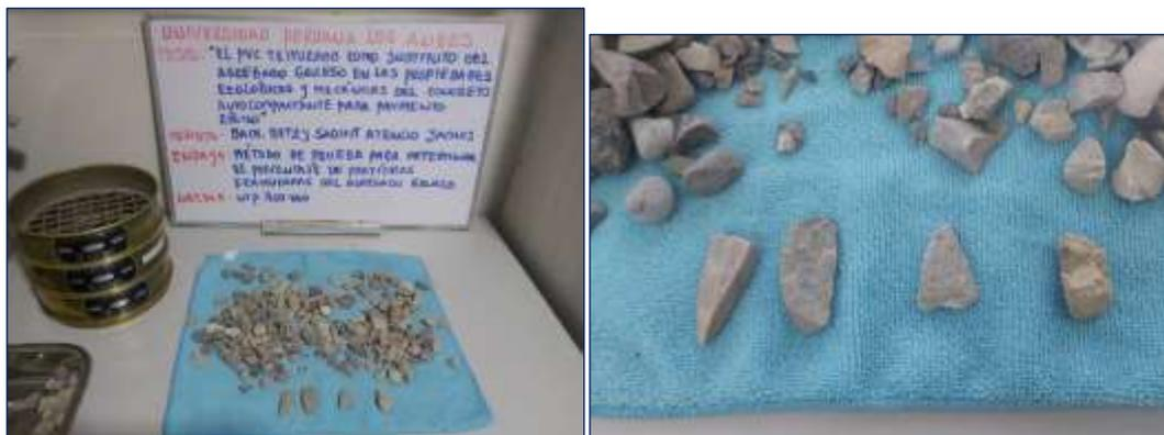
Fotografía 13. Ensayo para determinar el porcentaje de partículas fracturadas del agregado grueso.
