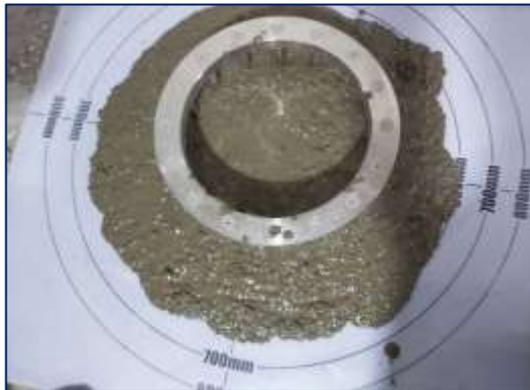
Fotografía 35. Medición de la habilidad de paso del concreto autocompactante con 40 % de PVC.
