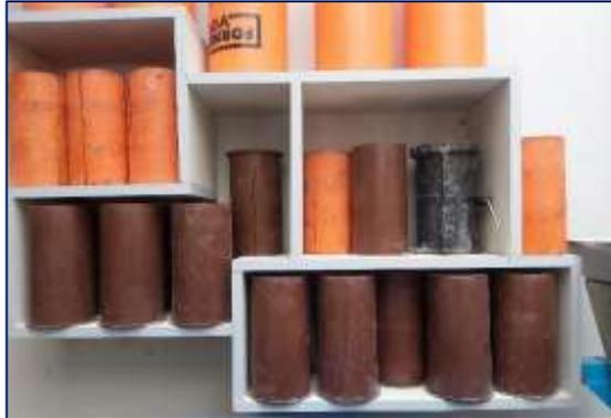
Fotografía 18. Vista de los moldes para las probetas de concreto.
