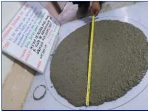
Fotografía 34. Medición del flujo de asentamiento del concreto autocompactante con 40 % de PVC.
