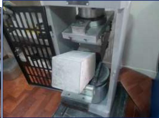
Fotografía 43. Rotura de vigas del concreto autocompactante con 20 % de PVC.
