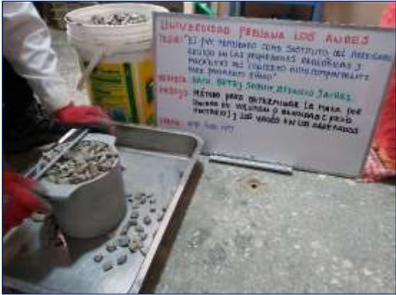
Fotografía 8. Vista de la determinación del peso unitario e índice de vacíos del agregado grueso.
