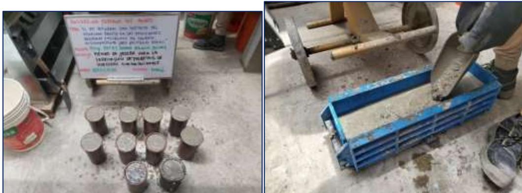
Fotografía 21. Probetas y vigas del concreto convencional.
