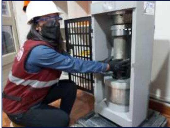
Figura 4. Vista del ensayo para la obtención de la resistencia a compresión del concreto autocompactante.
