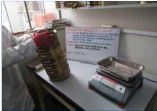
Fotografía 6. Análisis granulométrico del agregado fino.
