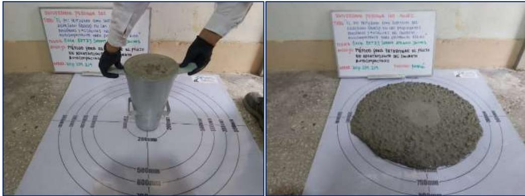
Fotografía 22. Medición del flujo de asentamiento del concreto convencional.
