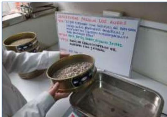
Fotografía 7. Análisis granulométrico del agregado grueso.
