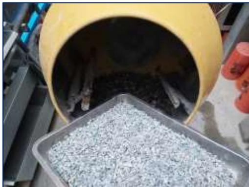
Fotografía 28. Elaboración del concreto autocompactante con 20 % de PVC.
