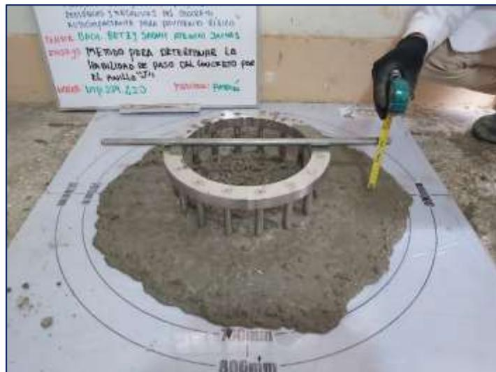
Figura 3. Vista del ensayo de habilidad de paso del concreto autocompactante.
