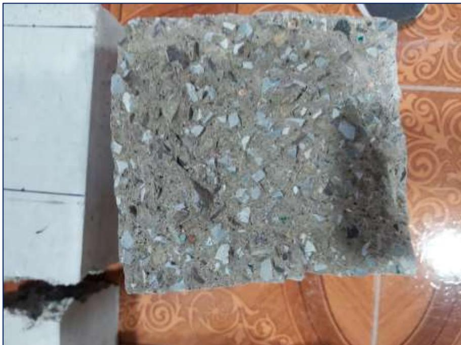
Fotografía 45. Vista del concreto autocompactante con reemplazo del agregado por PVC.
