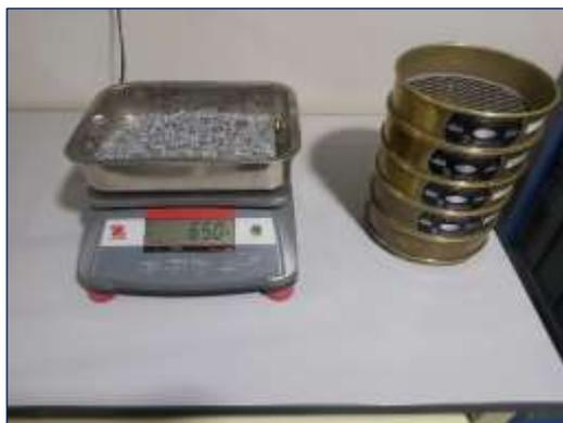
Fotografía 16. Análisis granulométrico del PVC triturado.
