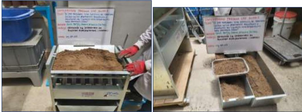
Fotografía 4. Vista del cuarteo del agregado fino.
