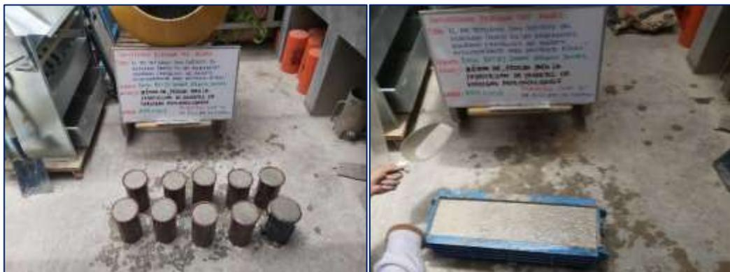
Fotografía 25. Vista de las probetas y vigas de concreto autocompactante con 5 % de PVC.
