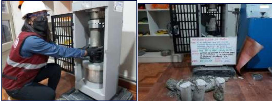
Fotografía 37. Rotura de probetas de concreto autocompactante convencional.
