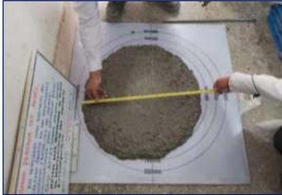
Fotografía 26. Medición del flujo de asentamiento del concreto autocompactante con 5 % de PVC.
