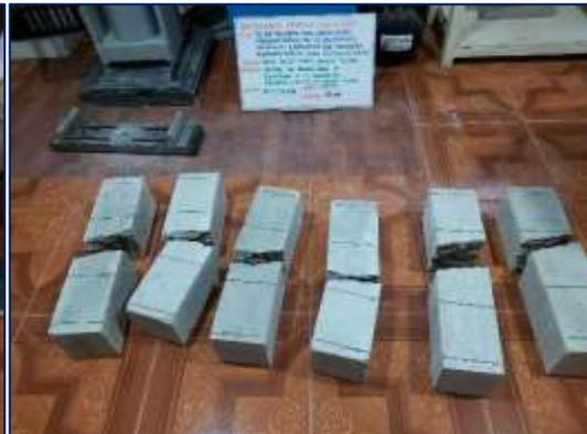
Fotografía 44. Rotura de vigas del concreto autocompactante con 40 % de PVC.
