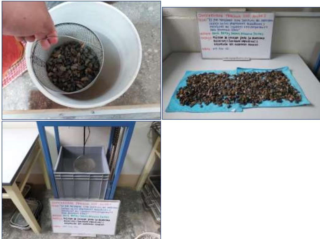
Fotografía 11. Vista del ensayo para determinar la densidad, gravedad específica y absorción del agregado fino.
