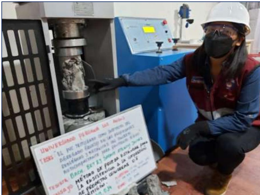
Fotografía 38. Rotura de probetas de concreto autocompactante con 5 % de PVC.
