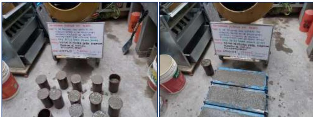
Fotografía 29. Vista de las probetas y vigas del concreto autocompactante con 20 % de PVC.
