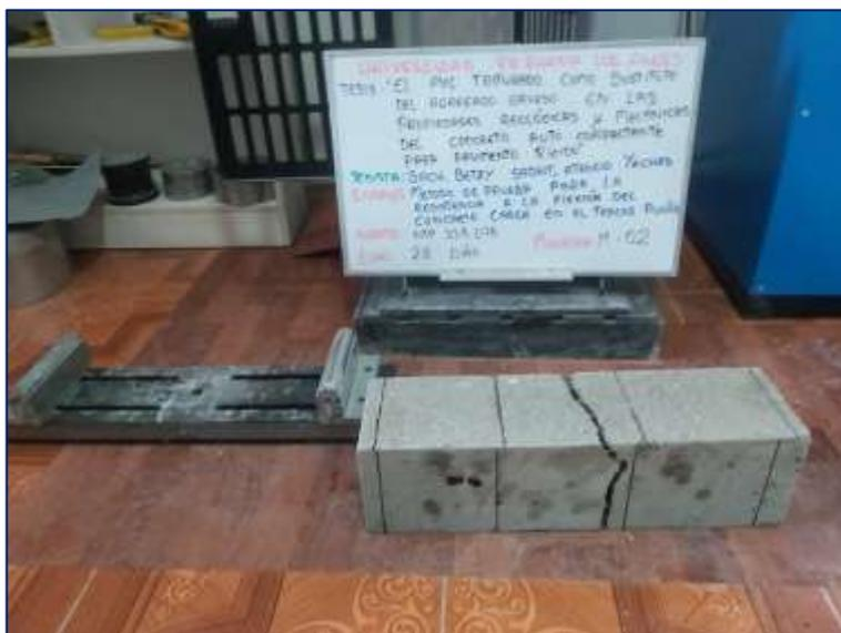
Fotografía 42. Rotura de vigas del concreto autocompactante con 5 % de PVC.
