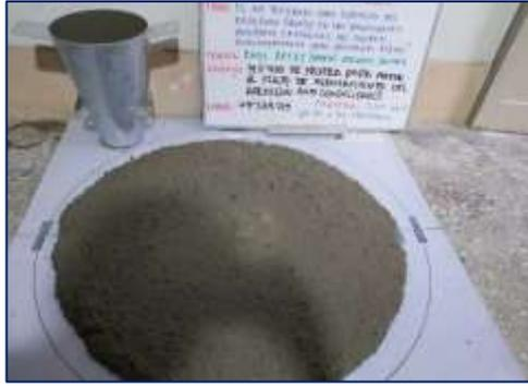
Fotografía 30. Medición del flujo de asentamiento del concreto autocompactante con 20 % de PVC.
