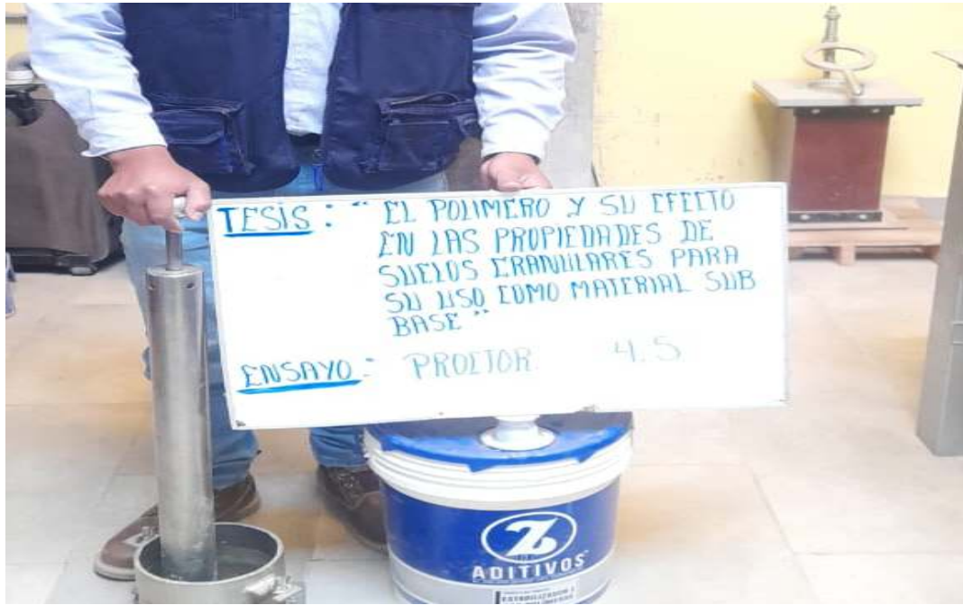
Fotografía 39. Ensayo de Proctor modificado para el material con aditivo de la relación 4.5 a 1.
