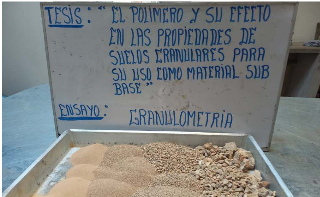
Fotografía 4. Resultados derivados de la evaluación granulométrico en la TR-1.
