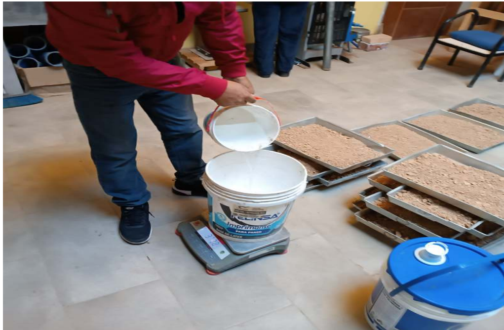
Fotografía 19. Control de la cantidad de agua utilizada en los ensayos.
