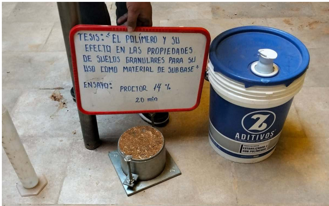
Fotografía 32. Proctor modificado del material con aditivo de la relación 4.0 a 1 de 20 minutos de tiempo de reposo con 14 % de agua.
