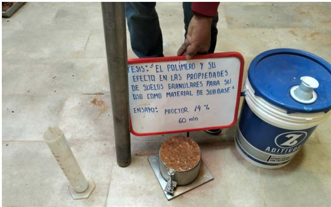
Fotografía 26. Proctor modificado del material con aditivo de la relación 4.0 a 1 de 60 minutos de tiempo de reposo con 14 % de agua.
