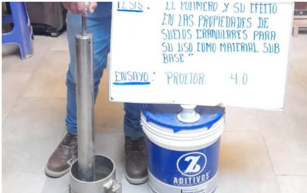
Fotografía 38. Ensayo de Proctor modificado para el material con aditivo de la relación 4.0 a 1.
