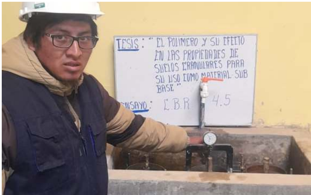
Fotografía 36. Muestras sumergidas para CBR de material con aditivo de la relación 4.5 a 1.
