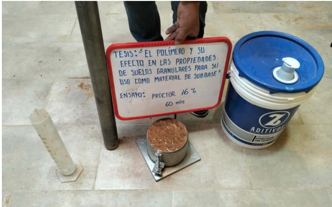
Fotografía 27. Proctor modificado del material con aditivo de la relación 4.0 a 1 de 60 minutos de tiempo de reposo con 16 % de agua.
