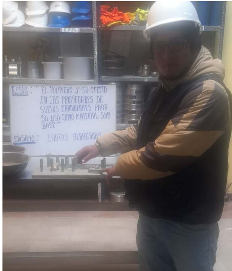
Fotografía 12. Ensayo de partículas aplanadas y alargadas de los materiales – Tr-2.
