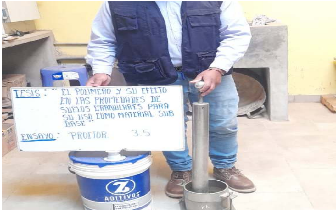
Fotografía 37. Ensayo de Proctor modificado para el material con aditivo de la relación 3.5 a 1.
