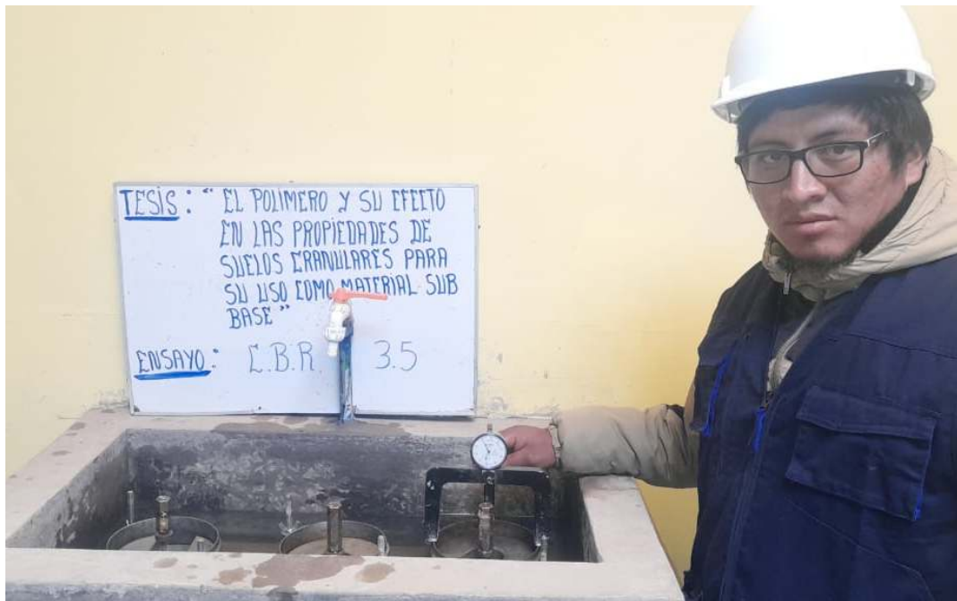
Fotografía 34. Muestras sumergidas para CBR de material con aditivo de la relación 3.5 a 1.
