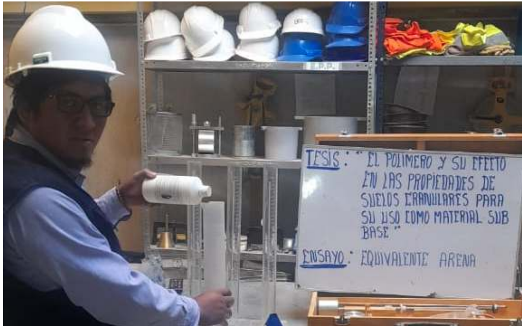
Fotografía 15. Ensayo del índice de equivalencia con arena – Tr-1.
