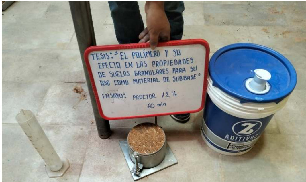
Fotografía 25. Proctor modificado del material con aditivo de la relación 4.0 a 1 de 60 minutos de tiempo de reposo con 12 % de agua.
