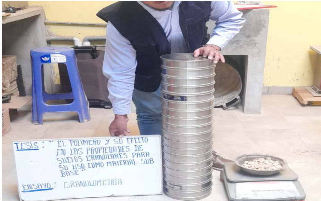
Fotografía 3. Análisis granulométrico de material natural.
