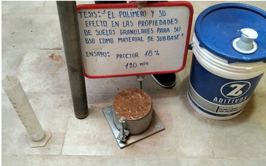
Fotografía 23. Proctor modificado del material con aditivo de la relación 4.0 a 1 de 120 minutos de tiempo de reposo con 18 % de agua.
