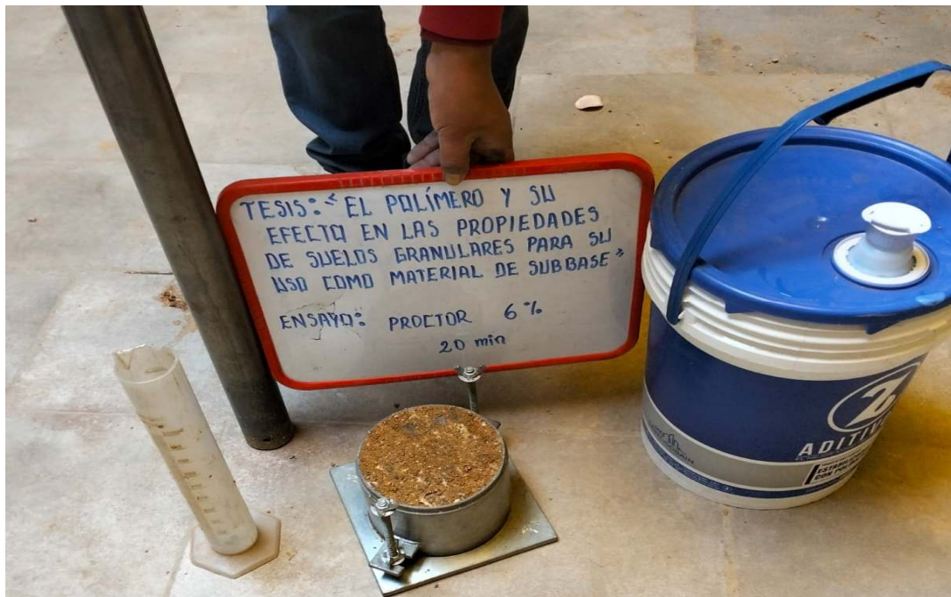
Fotografía 28. Proctor modificado del material con aditivo de la relación 4.0 a 1 de 20 minutos de tiempo de reposo con 6 % de agua.
