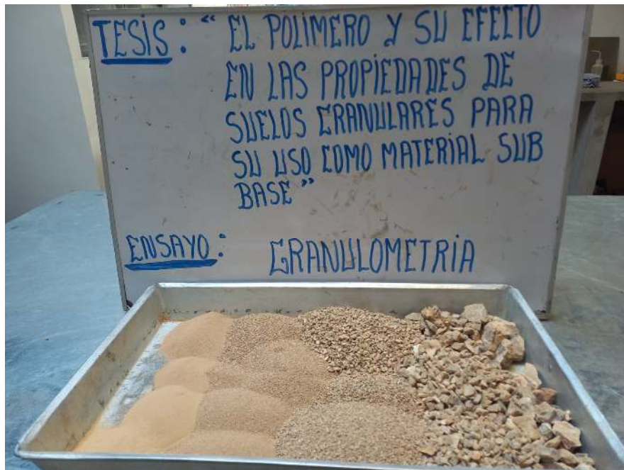
Fotografía 6. Resultados derivados de la evaluación granulométrico en la TR-3.
