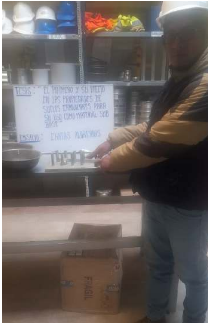
Fotografía 13. Ensayo de partículas aplanadas y alargadas de los materiales – Tr-3.
