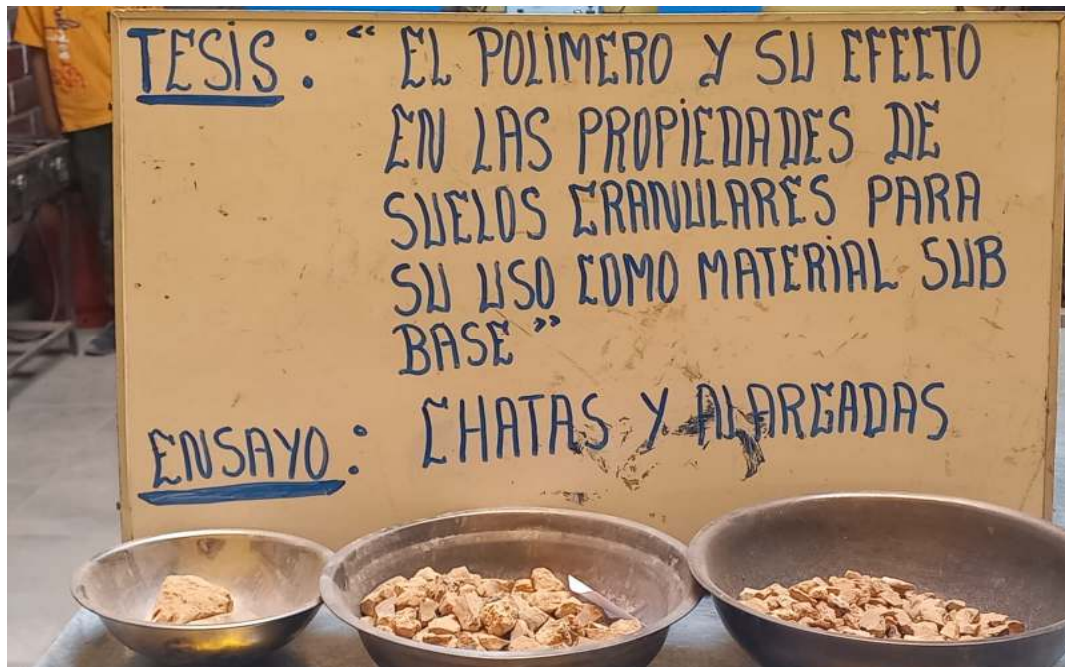
Fotografía 14. Resultados del ensayo de partículas chatas y alargadas.
