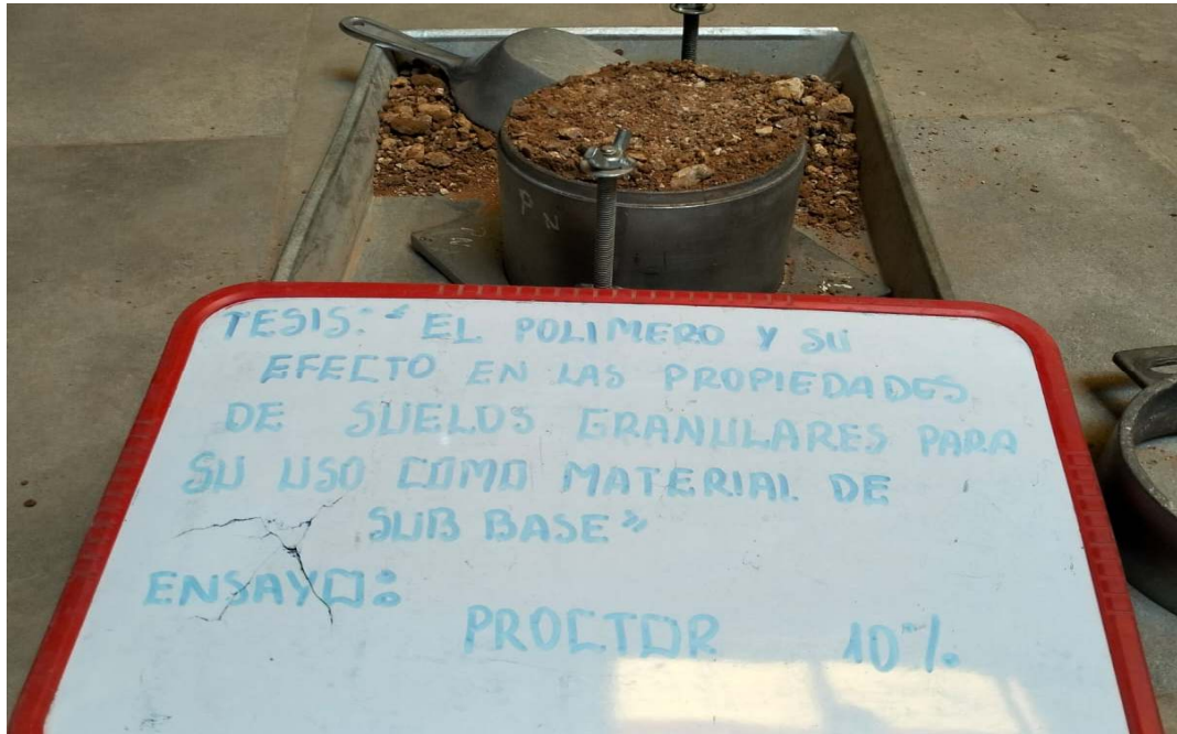
Fotografía 33. Proctor modificado del material con aditivo de la relación 4.0 a 1 de 20 minutos de tiempo de reposo con 10 % de agua.
