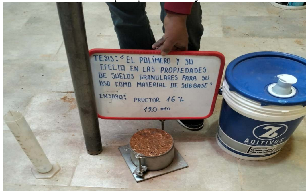
Fotografía 22. Proctor modificado del material con aditivo de la relación 4.0 a 1 de 120 minutos de tiempo de reposo con 16 % de agua.
