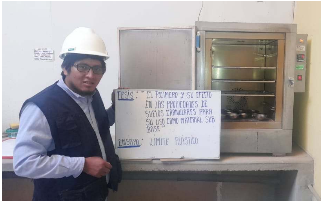
Fotografía 9. Ensayo de límite plástico de los materiales.
