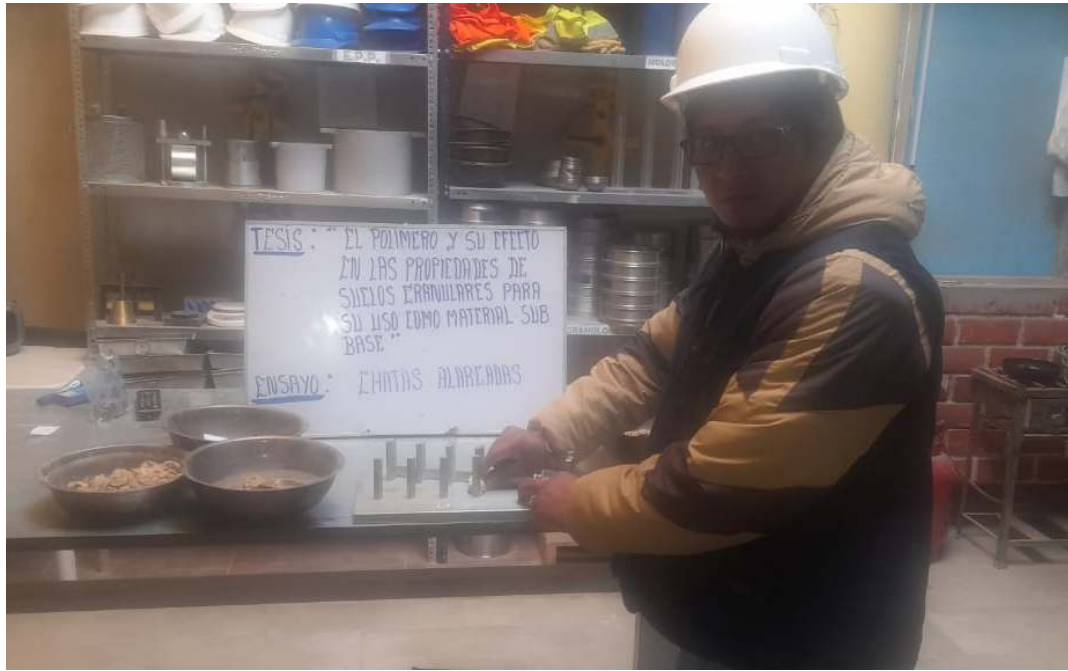
Fotografía 11. Ensayo de partículas chatas y alargadas de los materiales – Tr-1.
