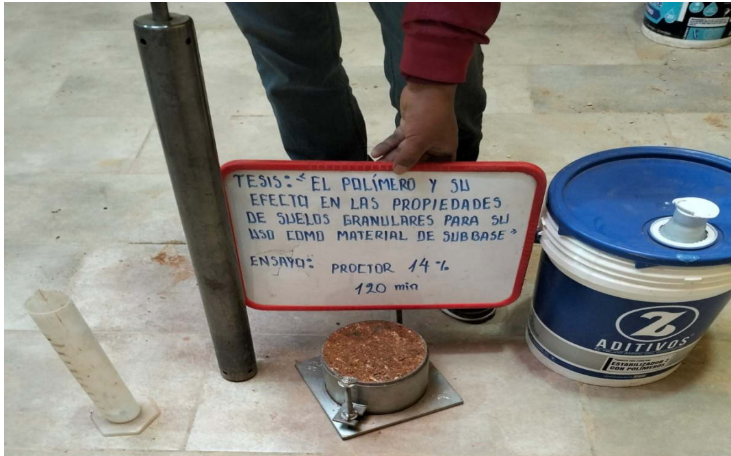
Fotografía 21. Proctor modificado del material con aditivo de la relación 4.0 a 1 de 120 minutos de tiempo de reposo con 14 % de agua.
