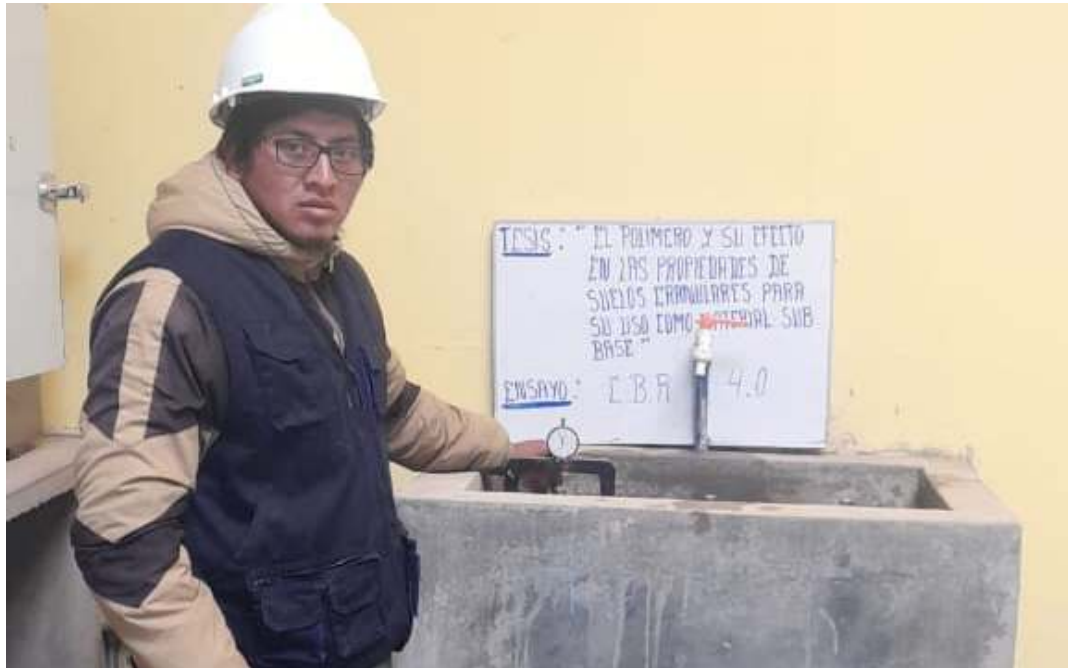
Fotografía 35. Muestras sumergidas para CBR de material con aditivo de la relación 4.0 a 1.
