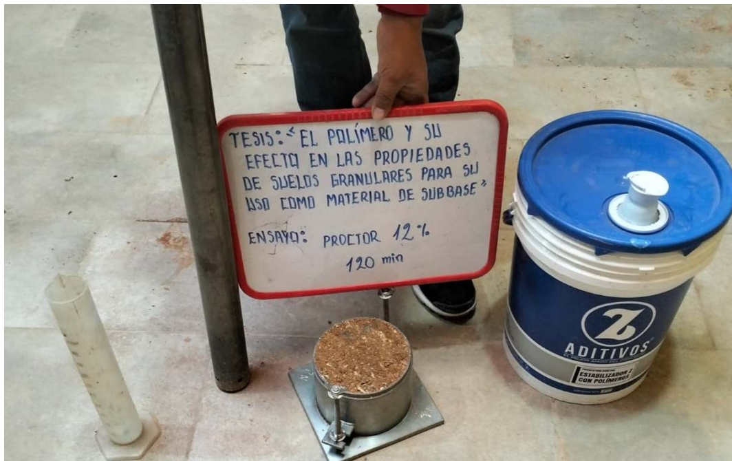
Fotografía 20. Proctor modificado del material con aditivo de la relación 4.0 a 1 de 120 minutos de tiempo de reposo con 12 % de agua.
