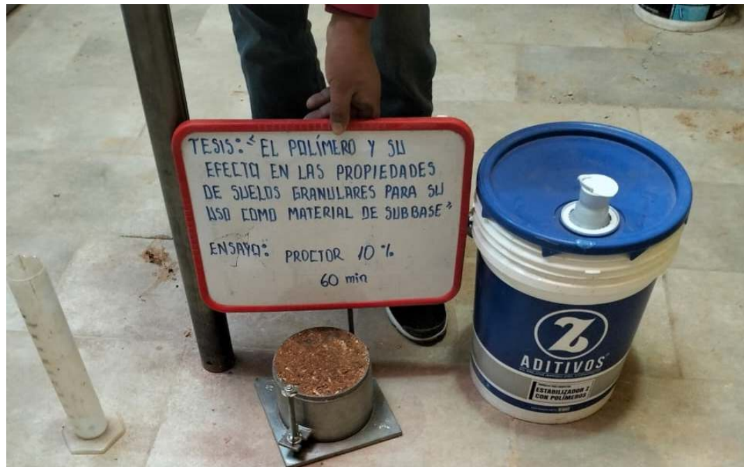
Fotografía 24. Proctor modificado del material con aditivo de la relación 4.0 a 1 de 60 minutos de tiempo de reposo con 10 % de agua.
