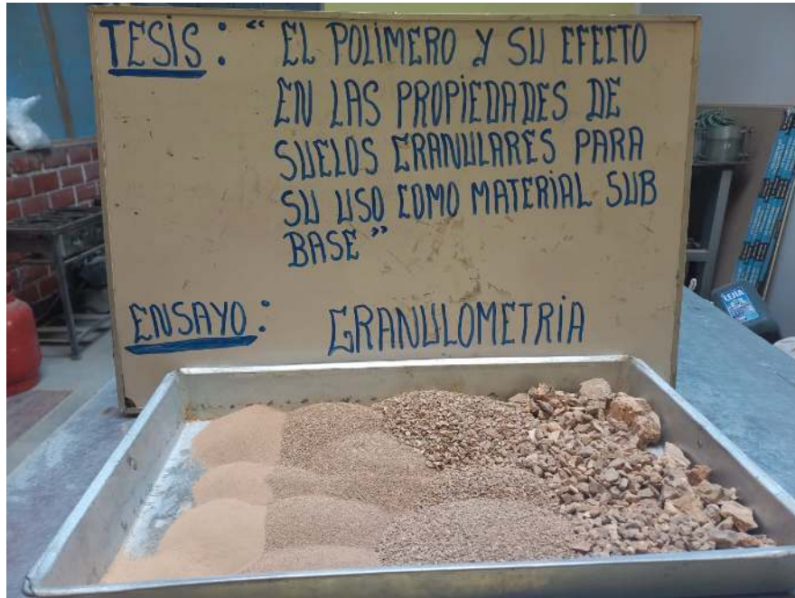
Fotografía 5. Resultados del análisis granulométrico en la TR-2.
