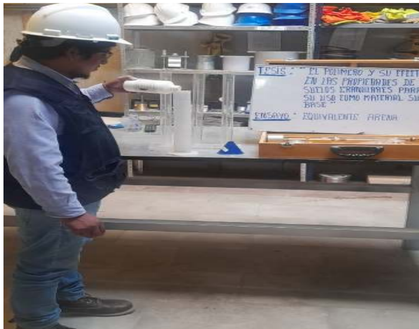
Fotografía 16. Ensayo del índice de equivalencia con arena – Tr-2.
