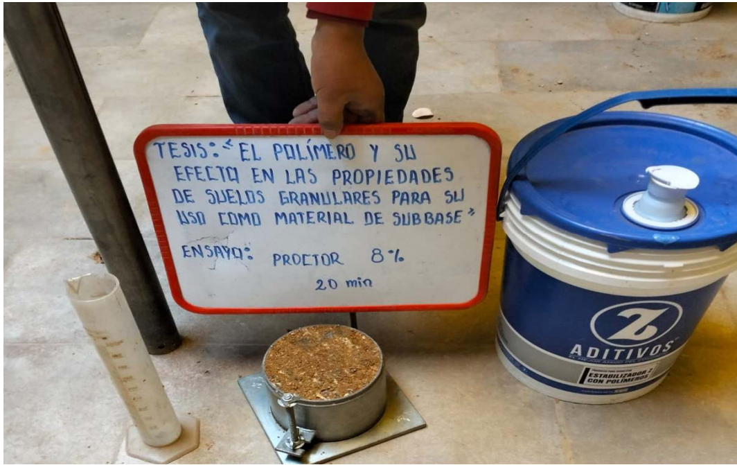
Fotografía 29. Proctor modificado del material con aditivo de la relación 4.0 a 1 de 20 minutos de tiempo de reposo con 8 % de agua.
