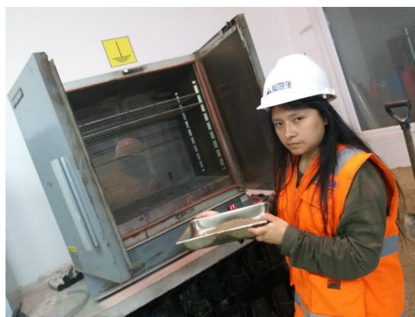
Figura 5.7 Material llevado al horno por 24 horas.
