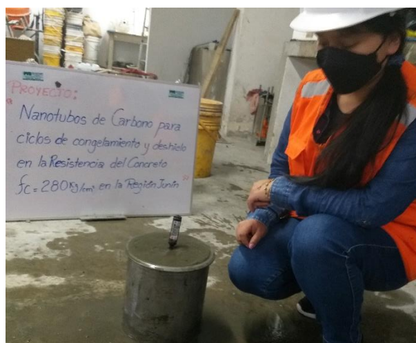
Figura 5.16 Tomando datos de la temperatura del Concreto.
