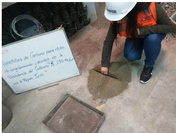
Figura 5.3 Cuarteo del agregado fino.
