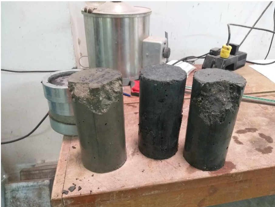
Fotografía 20: Tipos de Roturas.
