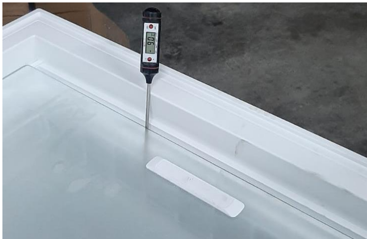
Figura 5.22 Toma de Temperatura de la congeladora -8^{\circ}\text{C} a -10^{\circ}\text{C} .
