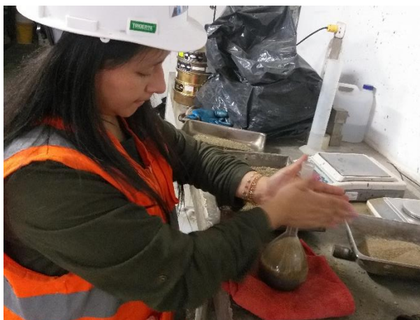
Figura 5.8 Agitamos el picnómetro.
