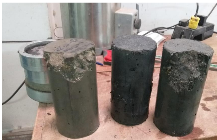
Figura 5.25 Probetas ensayadas a compresión.
