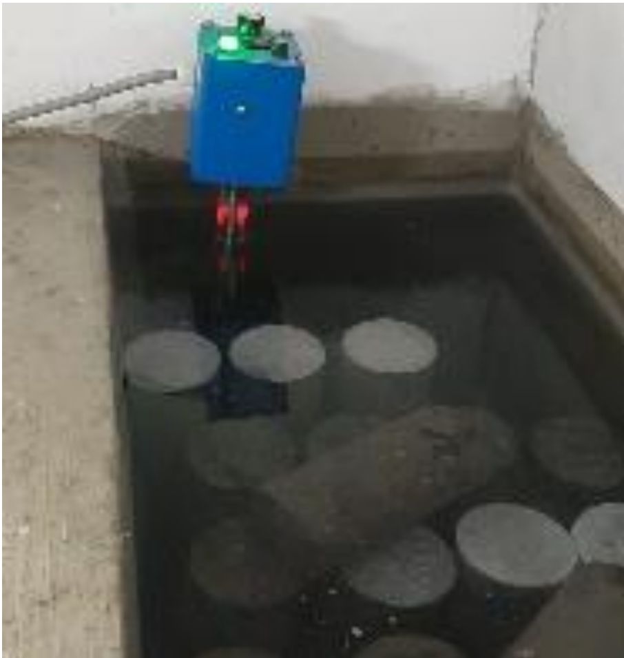
Fotografía 14: Poza de curado con control de temperatura.
