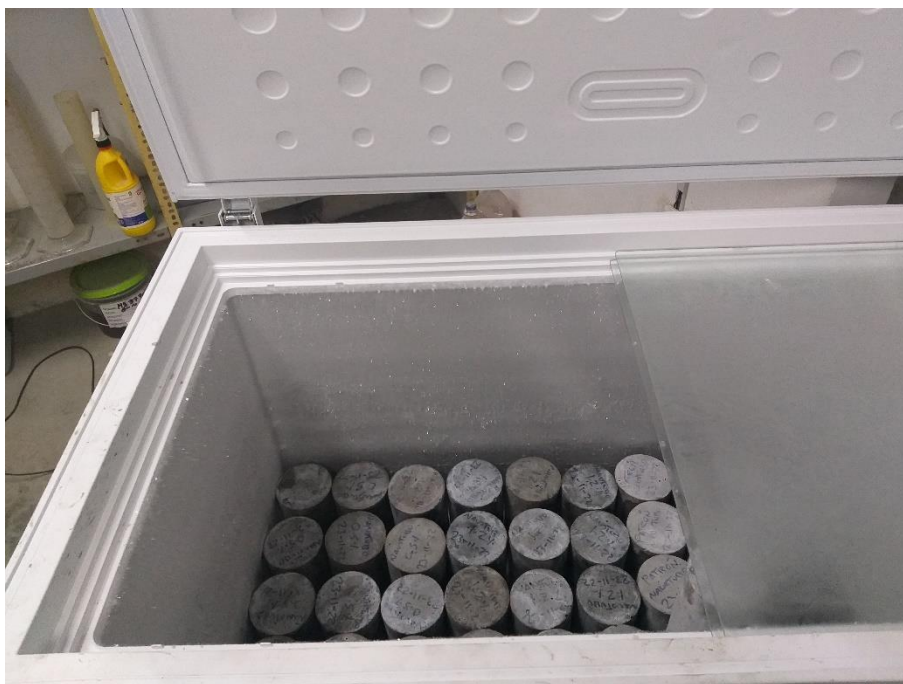
Fotografía 16: Probetas en el congelador por 12 horas.
