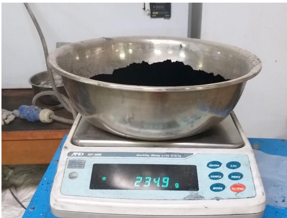
Fotografía 10: 0.5% de NTC, de acuerdo al peso del cemento.
