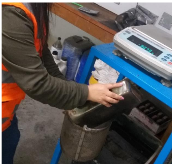
Figura 5.14 Colocando la muestra en la balanza hidrostática.
