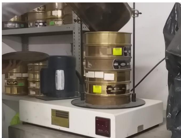
Figura 5.4 Vaciano el agregado a los tamices.
