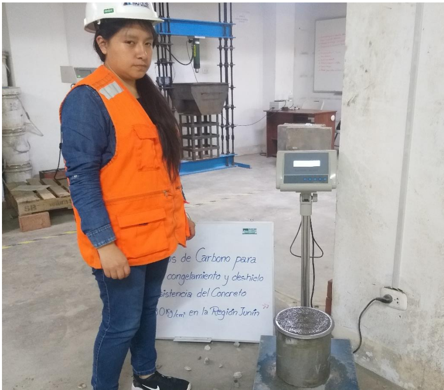
Fotografía 6: Peso del Concreto fresco.
