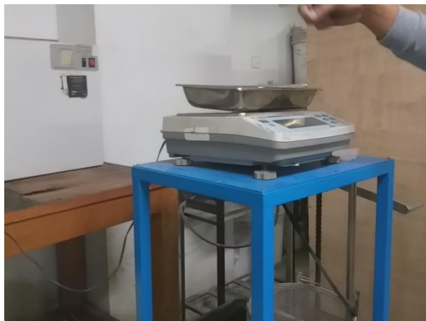
Figura 5.12 Peso de la muestra seca.
