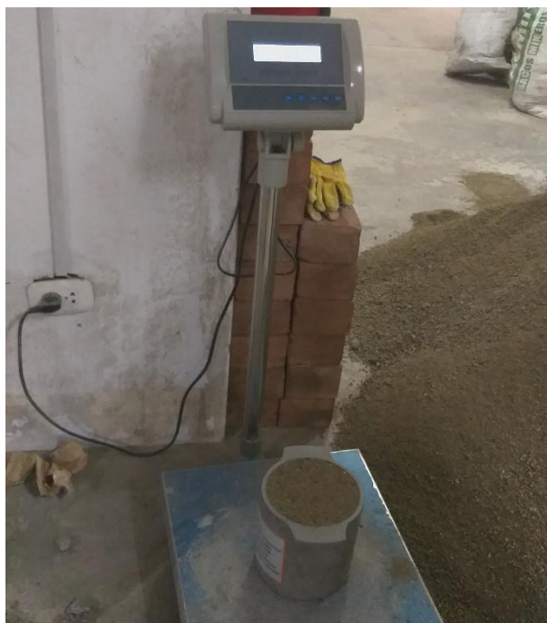
Figura 5.9 Pesamos el material más el molde.
