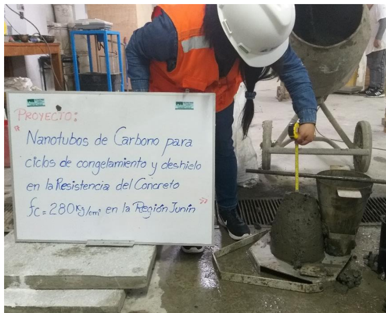
Figura 5.17 Medición del Slump.
