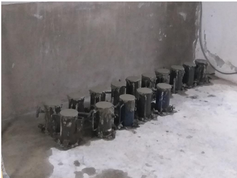
Fotografía 9: Probetas de Concreto.
