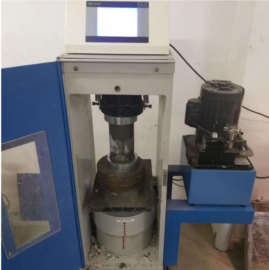
Fotografía 19: Ensayo por compresión.
