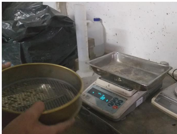
Figura 5.5 Pesando el agregado fino en cada malla.
