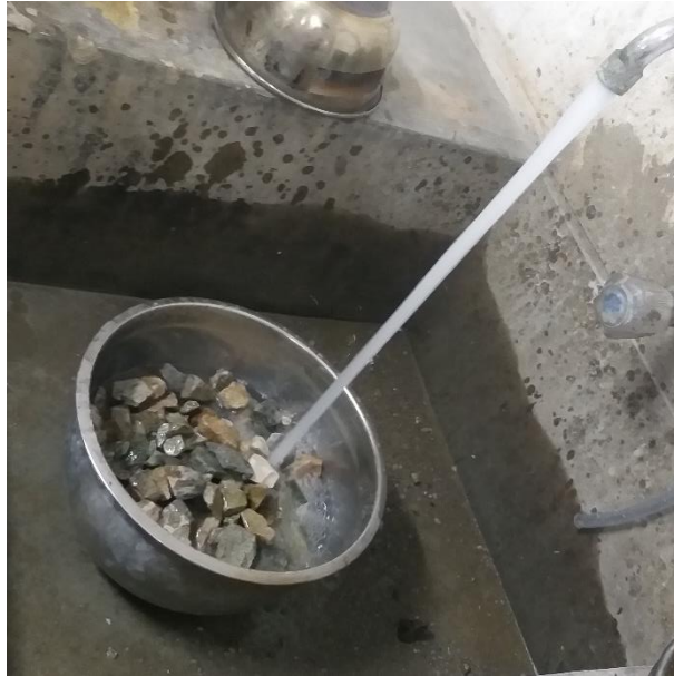
Figura 5.11 Lavado del agregado grueso.
