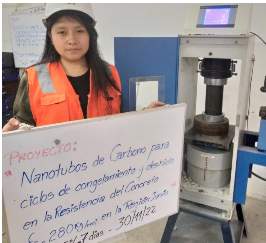
Fotografía 18: Ensayo por compresión.
