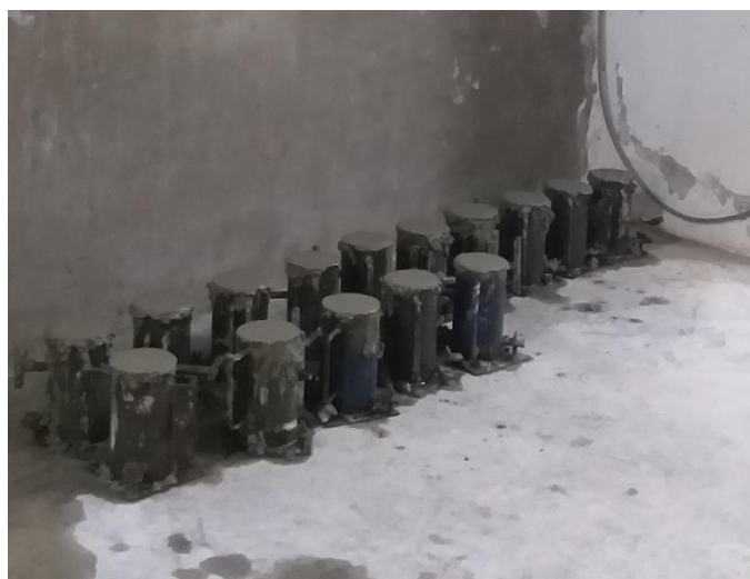
Figura 5.20 Producción de Especímenes.
