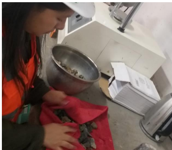
Figura 5.13 Secado de la muestra con una franela.
