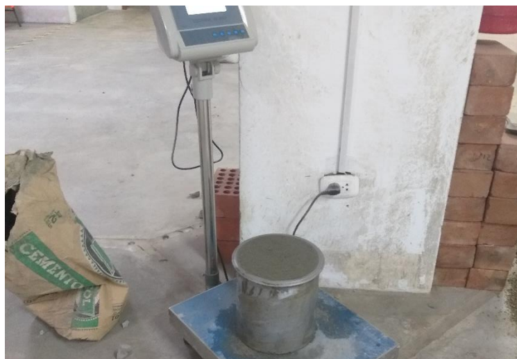
Figura 5.18 Peso del concreto fresco en molde.
