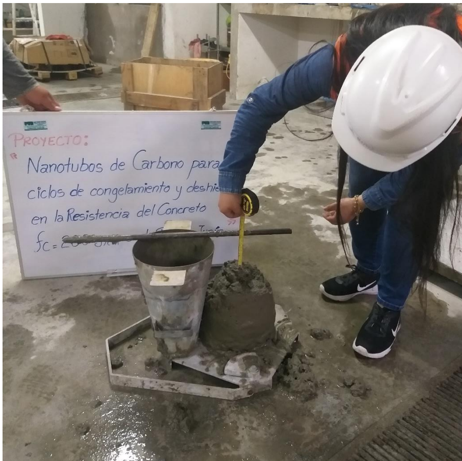
Fotografía 4: Medición del Slump.
