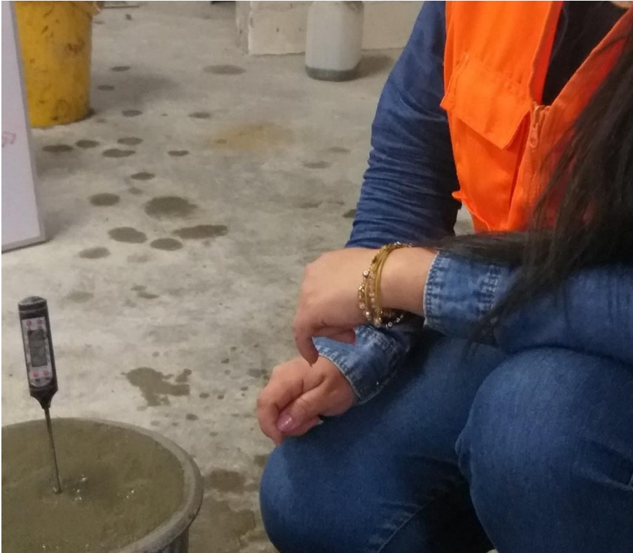
Fotografía 5: Toma de Temperatura del Concreto fresco.
