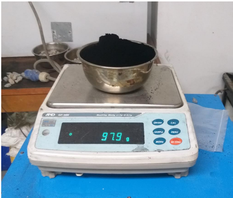
Fotografía 2: NTC suelto para su respectivo peso.
