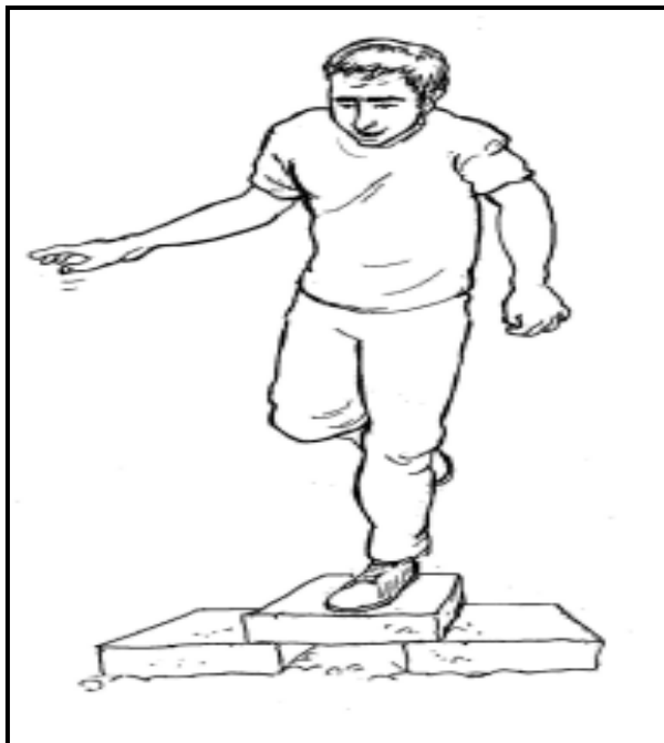
Figura 2. 16 Prueba de resistencia del adobe.
