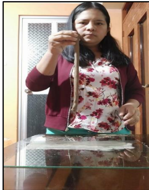
Figura 3. 31 Se muestra la cinta de barro de 25 cm.
