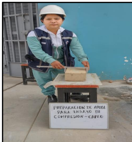
Figura 3. 102 Preparación del espécimen.
