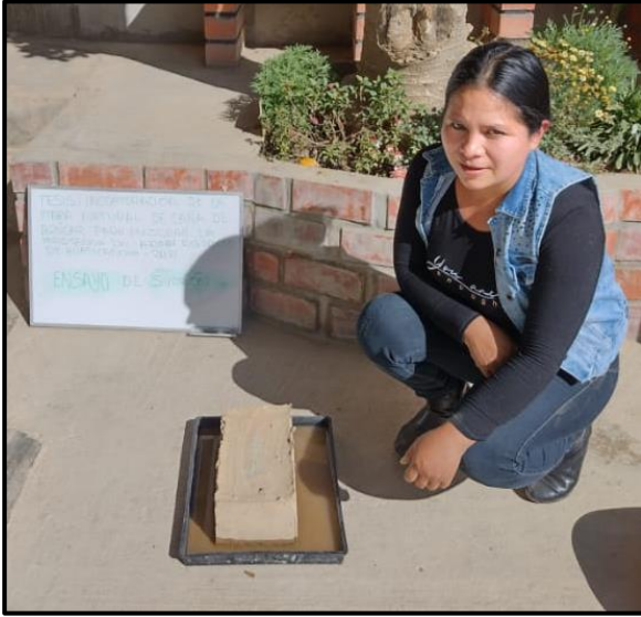
Fotografía 20. Ensayo de succión compresión
