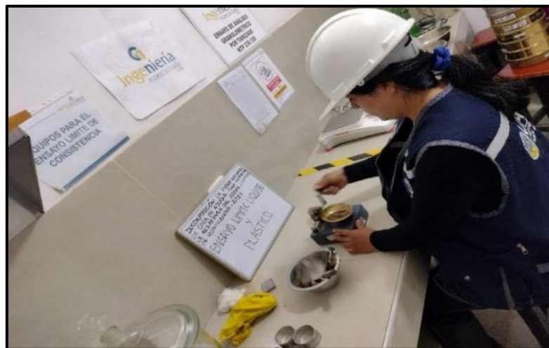
Figura 3. 58 Giro de manivela, para saber en cuantos golpes cierra la muestra.
