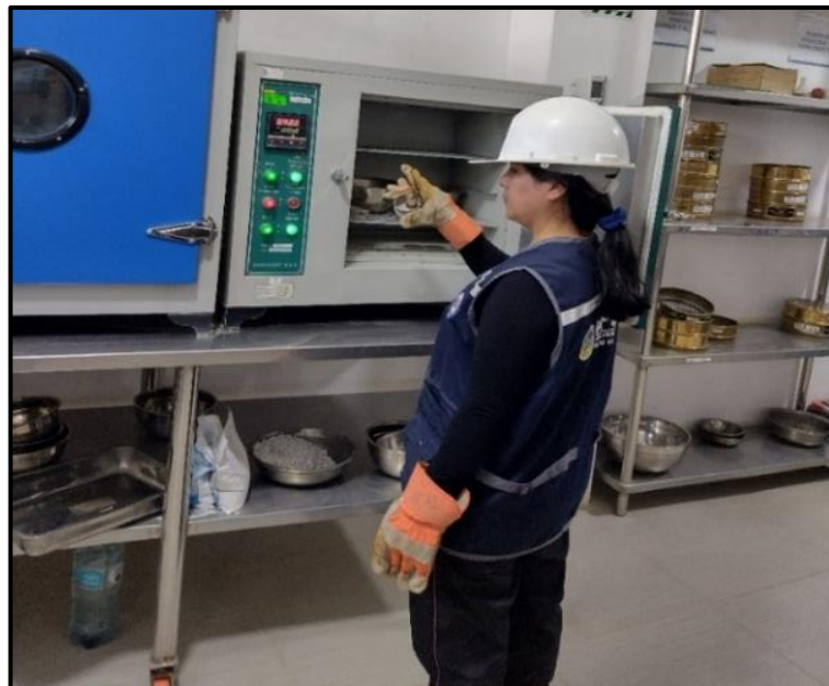
Figura 3. 63 Ingreso de la muestra al horno.
