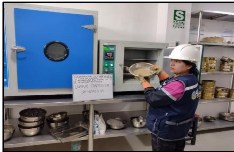
Fotografía 11. Ingreso de la muestra al horno
