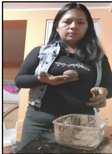
Figura 3. 15 Se forma una pequeña esfera con el barro.
