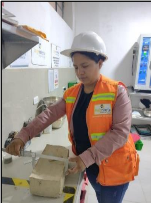
Fotografía 18. Ensayo de alabeo
