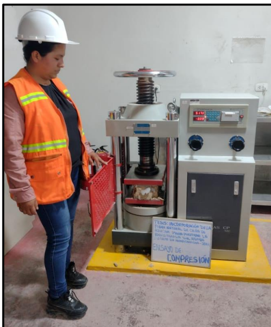
Figura 3. 105 Ensayo de compresión a los especímenes.
