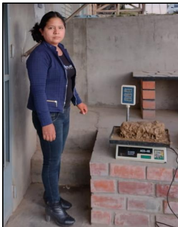
Figura 3. 97 Peso del espécimen en remojo.
