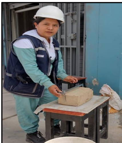
Figura 3. 103 Medidas del espécimen.
