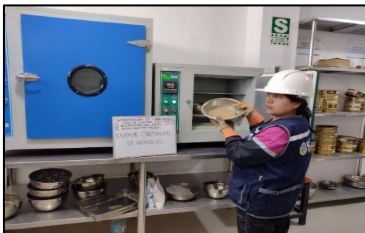
Figura 3. 53 Ingreso de la muestra al horno.
