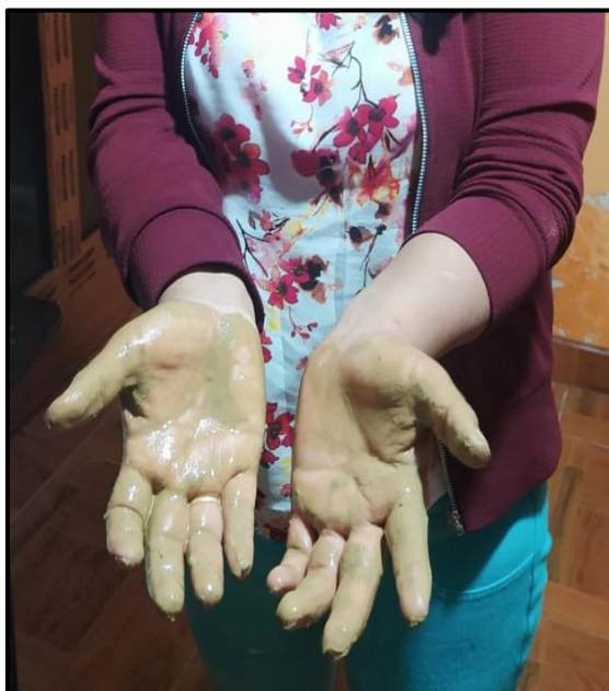
Figura 3. 43 Se hace difícil desprender la arcilla de la mano.
