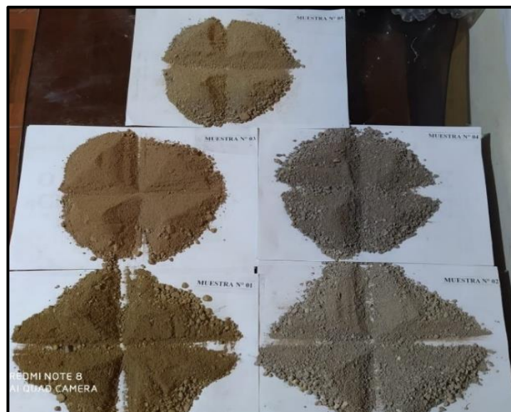
Figura 3. 5 Cuarteo de la muestra de suelos.
