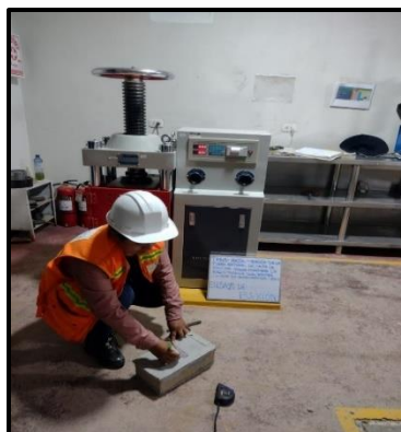
Figura 3. 107 Medición del espécimen para el ensayo de resistencia a la flexión.
