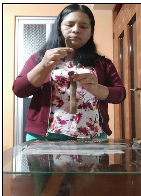
Figura 3. 32 La cinta de barro se rompe a 19 cm.
