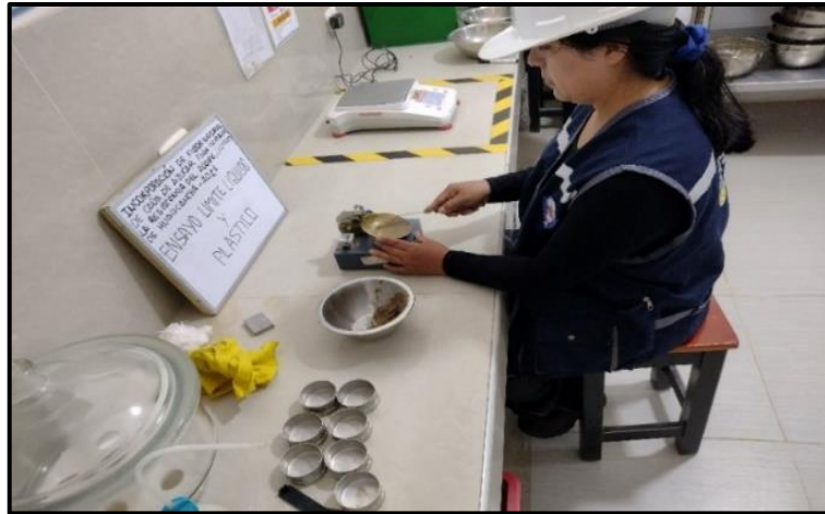
Figura 3. 56 Utilización de la copa Casagrande.
