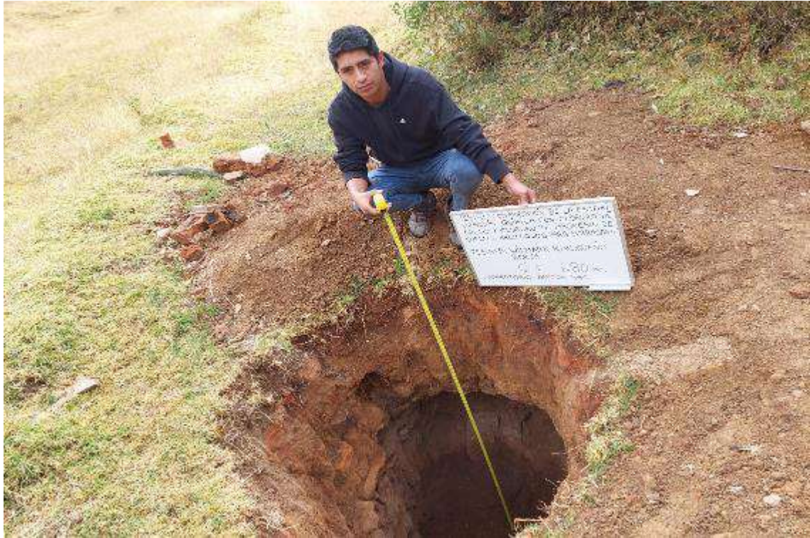
Fotografía 1. Calicata de suelo natural.
