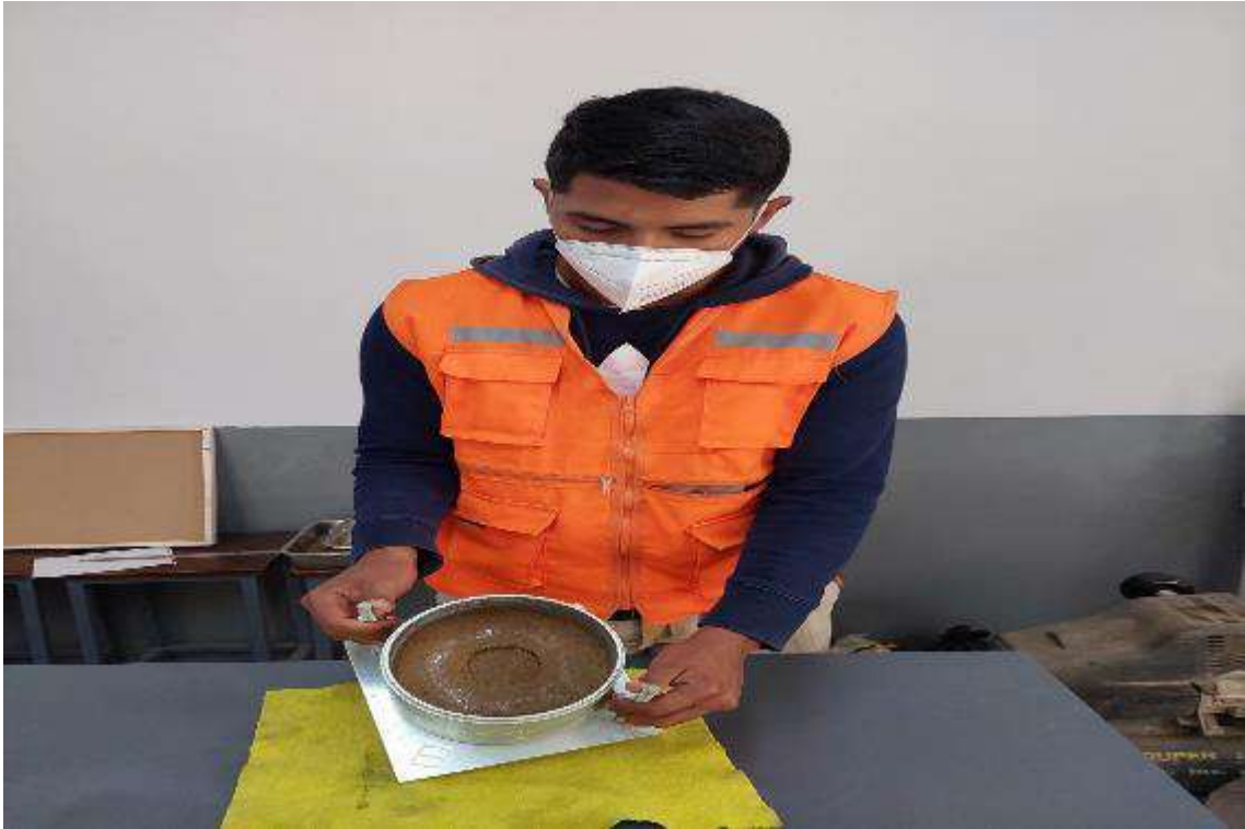
Fotografía 25. Desmoldado de muestra con 6.0 % de cloruro de magnesio después de prueba CBR.
