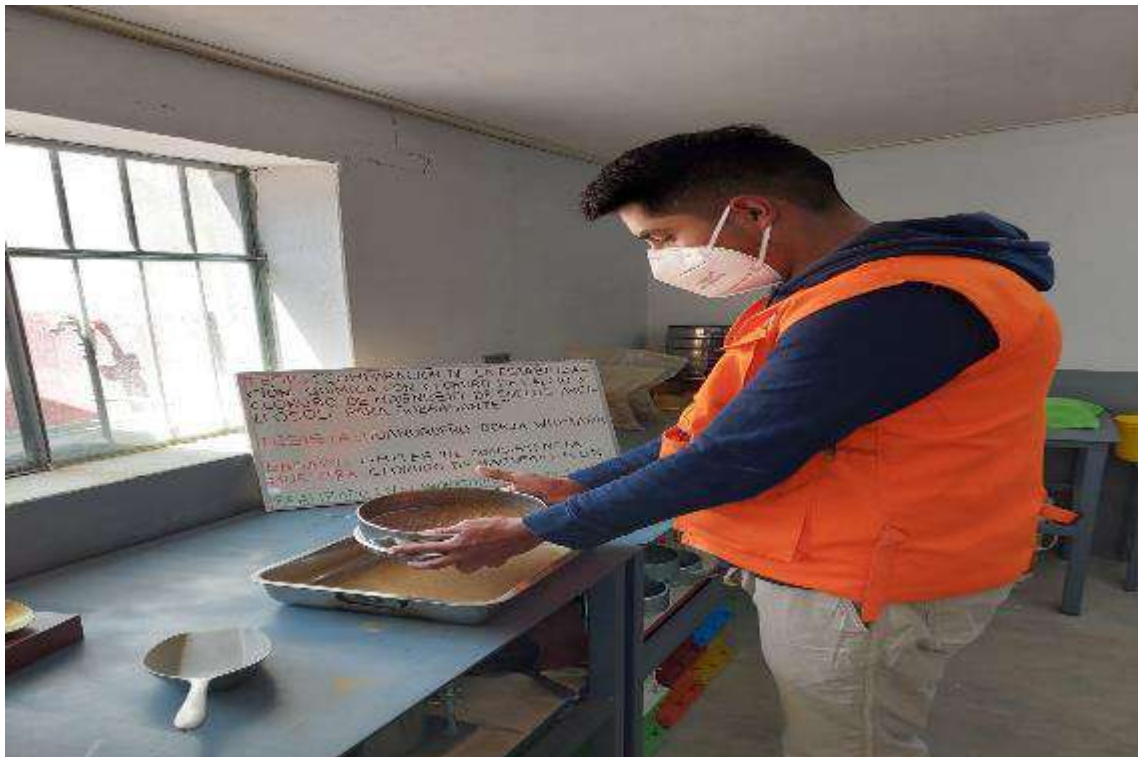
Fotografía 8. Separación de material fino de material con 5.0 % de cloruro de magnesio.
