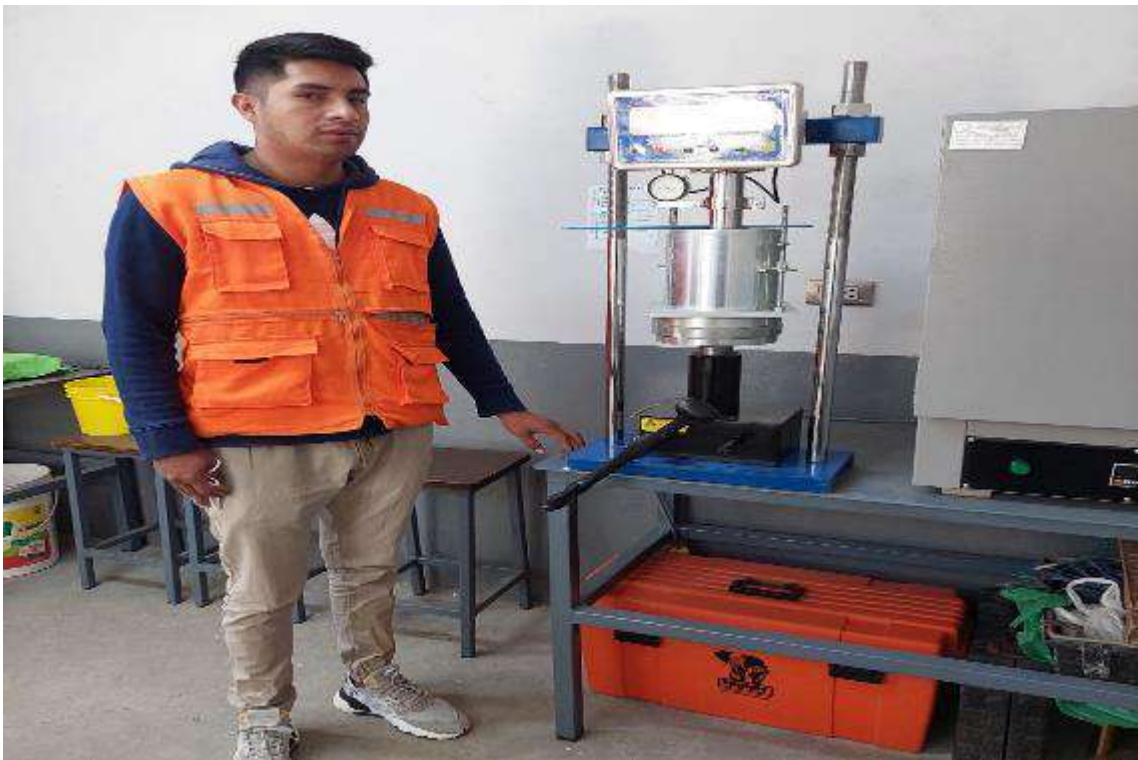
Fotografía 24. Ensayo CBR de material con cloruro de magnesio.
