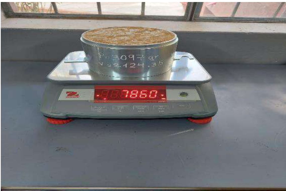
Fotografía 16. Pesaje en ensayo CBR de material con 1.5 % de cloruro de calcio.
