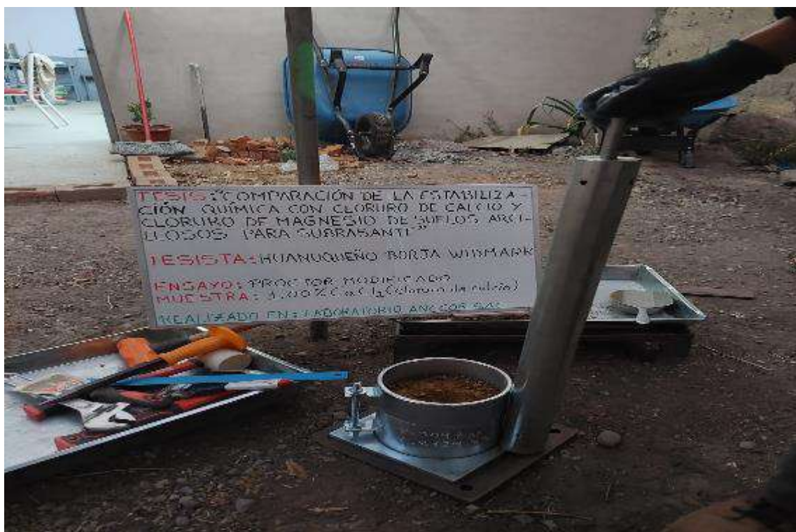
Fotografía 14. Proctor modificado de material con 1.0 % de cloruro de calcio.
