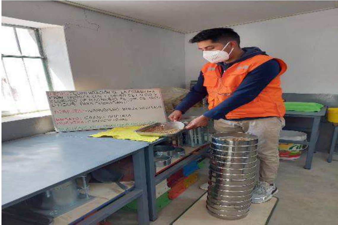
Fotografía 3. Ensayo granulométrico de material convencional.
