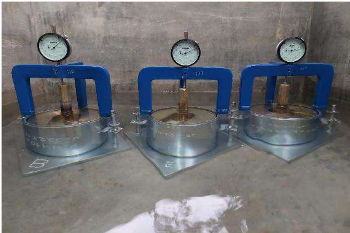
Fotografía 18. Muestras sumergidas para CBR de materiales modificados con cloruro de magnesio.
