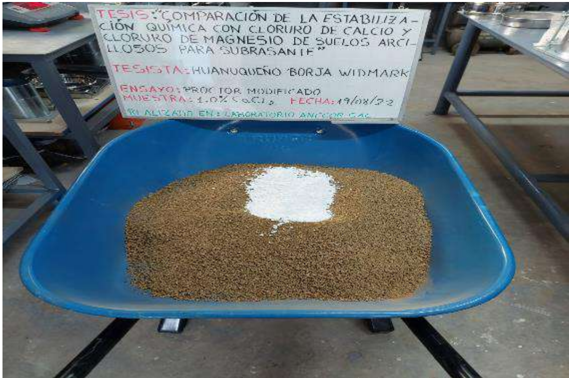
Fotografía 5. Preparación de material con 1.0 % de cloruro de calcio.
