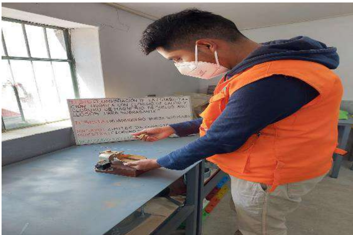
Fotografía 10. Ensayo de límite líquido con la cuchara de Casagrande de material con cloruro de magnesio.
