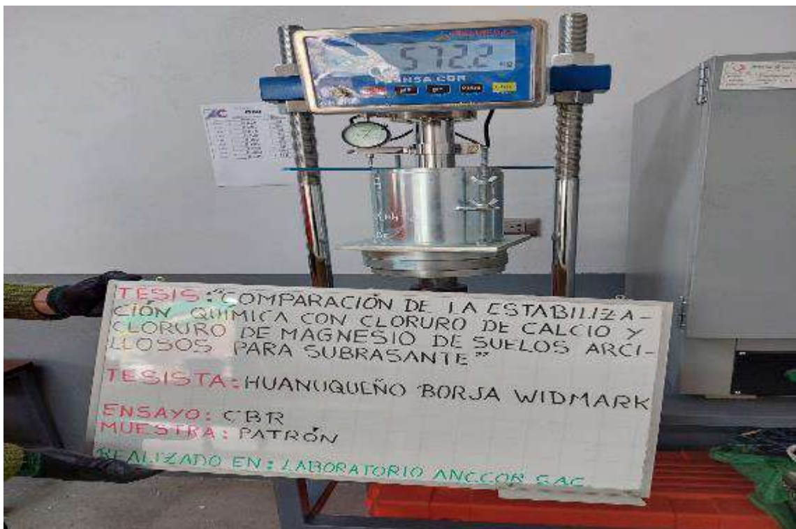
Fotografía 22. Ensayo CBR de material convencional.
