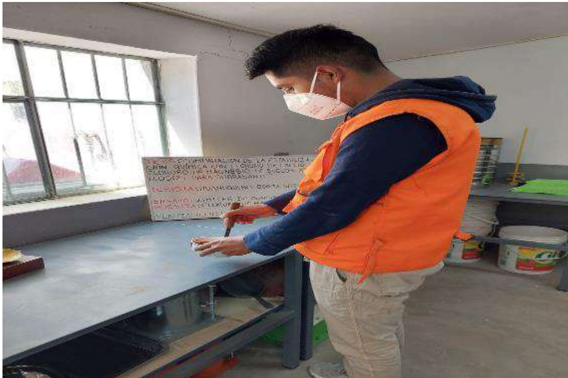
Fotografía 9. Ensayo de límites de consistencia de materiales con cloruro de magnesio.
