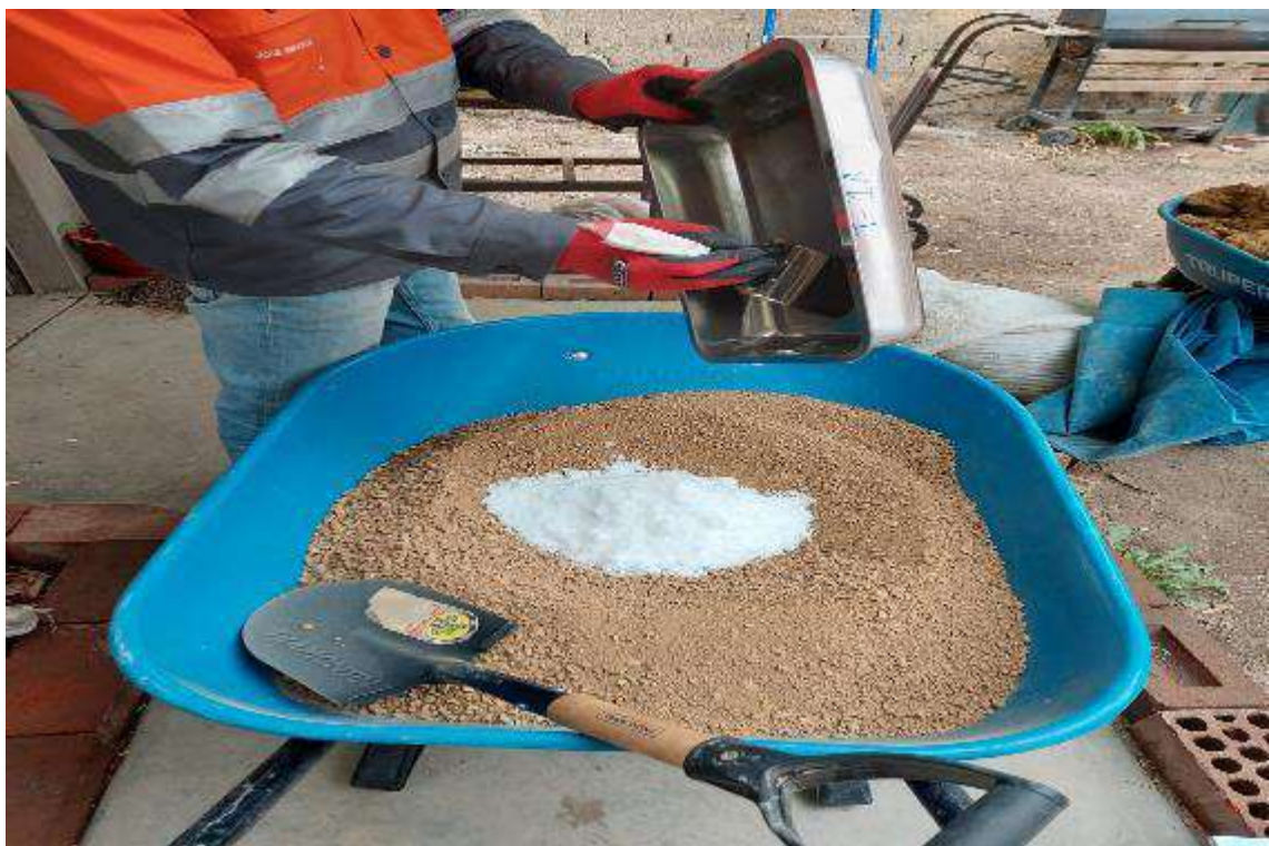
Fotografía 6. Preparación de material con 7.0 % de cloruro de magnesio.
