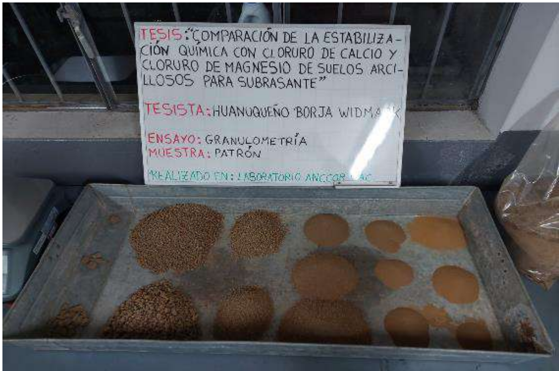
Fotografía 4. Resultado del análisis granulométrico de material convencional.
