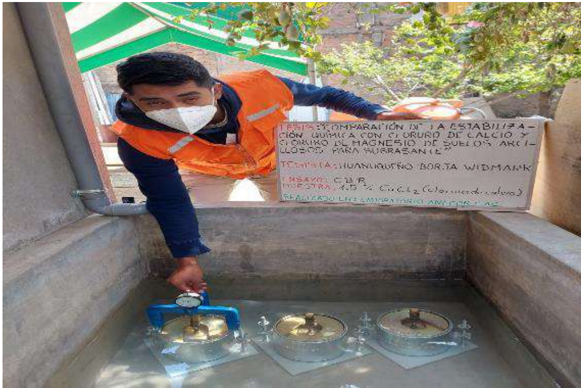
Fotografía 19. Ensayo CBR de material con 1.5 % de cloruro de calcio.
