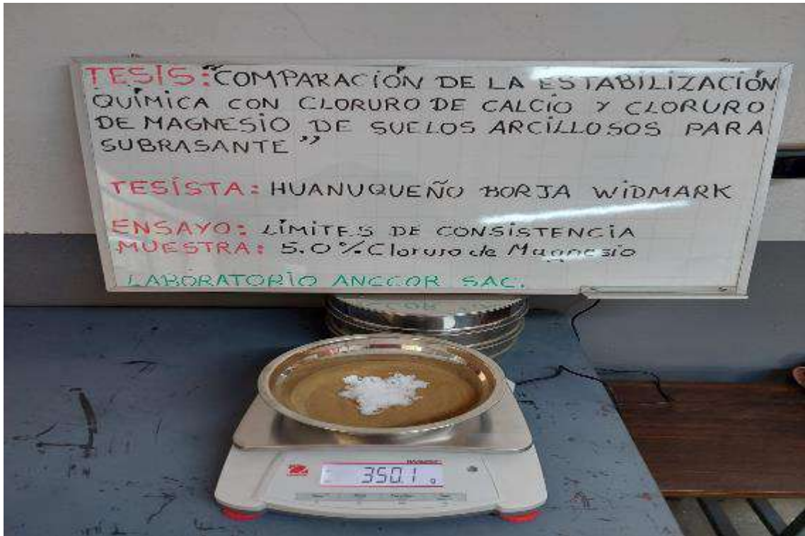
Fotografía 7. Preparación de muestra con 5.0 % de cloruro de magnesio.
