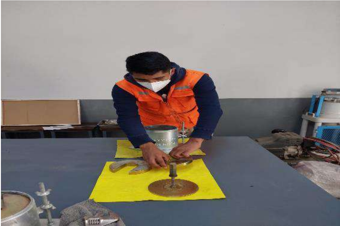
Fotografía 15. Preparación de molde para ensayo de CBR.
