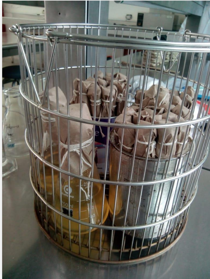
Agar Nutritivo, Manitol Salado, Mac Conkey, Tubos con agua destilada, Caldo Brila; listos para su Esterilización en el Autoclave
