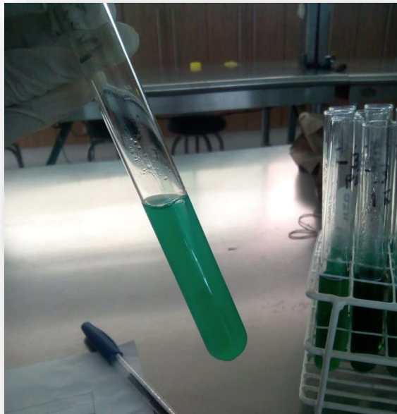
Resultados de Colimetrica Total en Jugo de Papaya, Piña, Surtido, Plátano con Leche
