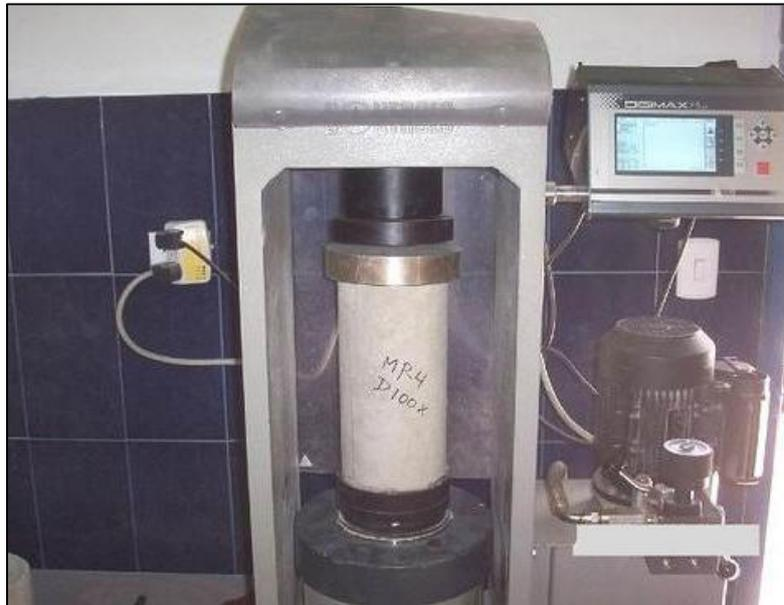
Figura 3. Vista del ensayo a compresión del concreto.
