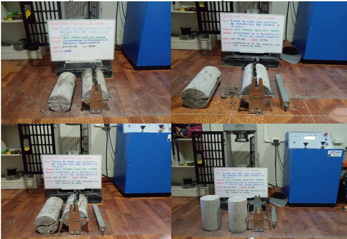
Fotografía 18. Vista de las roturas a tracción de las probetas a los 28 días.
