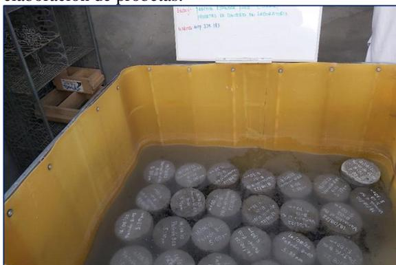
Fotografía 12. Vista del curado de probetas en laboratorio.
