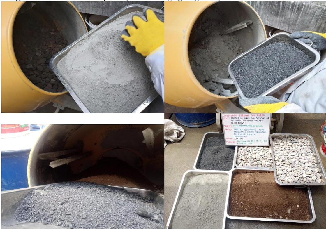
Fotografía 7. Elaboración de la mezcla patrón, además de las mezclas donde se sustituyó el 15 %, 20 % y 30 % del agregado fino por escoria de cobre.
