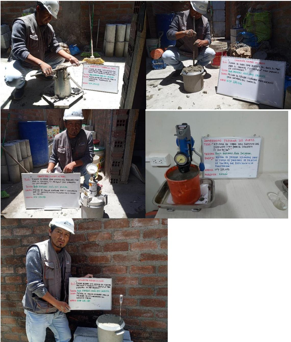
Fotografía 8. Medición de las propiedades en estado fresco del concreto patrón (asentamiento, peso unitario, contenido de aire, tiempo de fraguado y temperatura).
