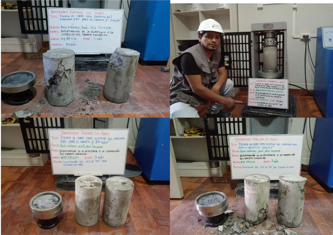
Fotografía 13. Vista de probetas roturadas a los 7 días.
