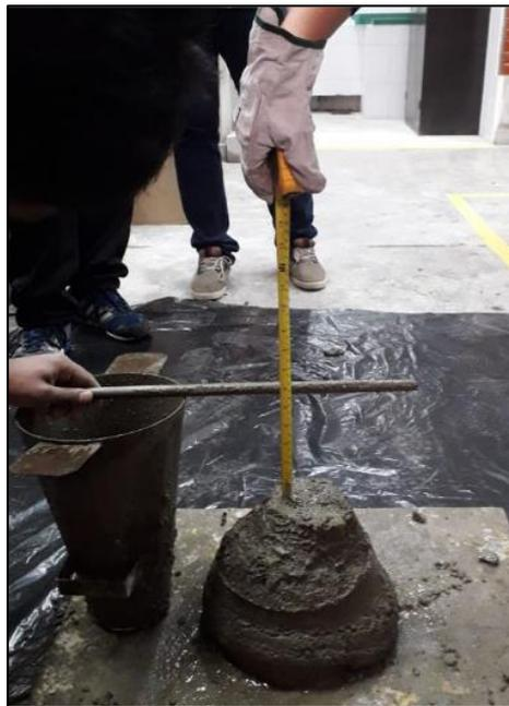
Figura 2. Vista de la medición del asentamiento del concreto por medio del cono de Abrams.
