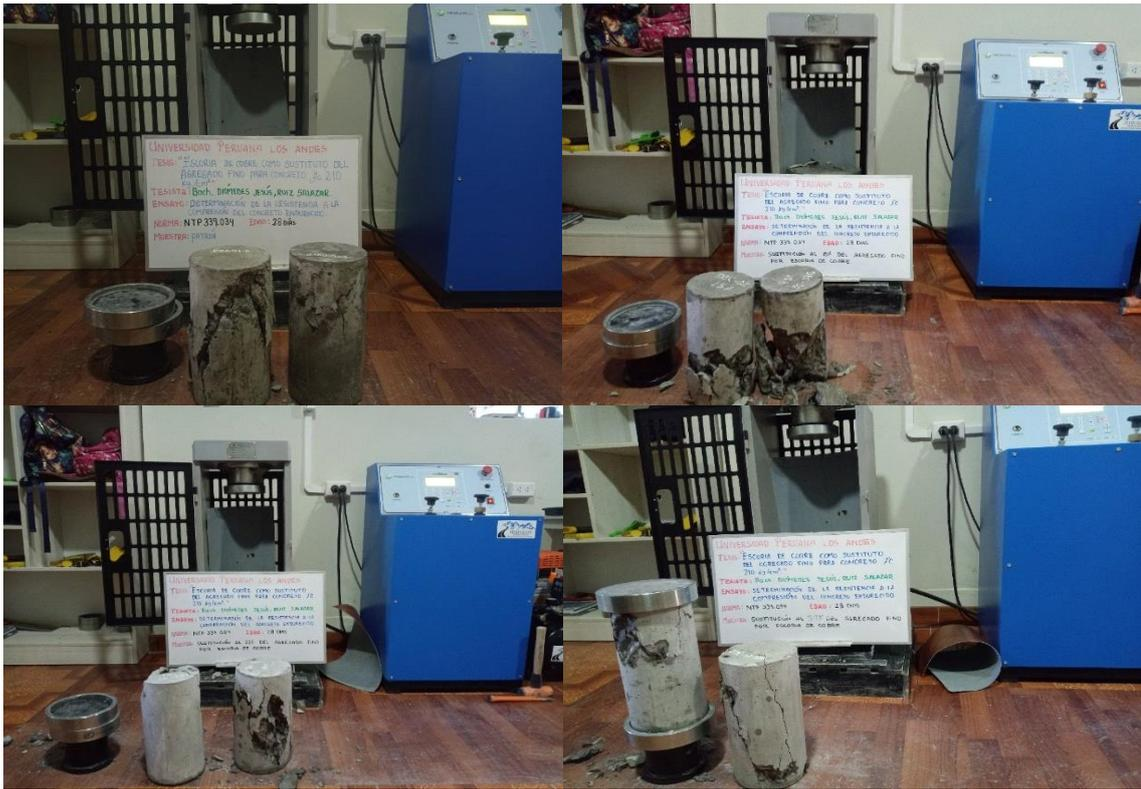
Fotografía 15. Vista de probetas roturadas a los 28 días.
