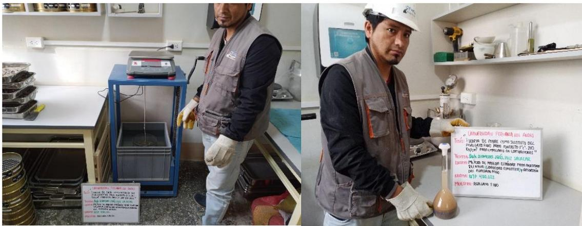
Fotografía 6. Determinación del peso específico del agregado grueso y fino.
