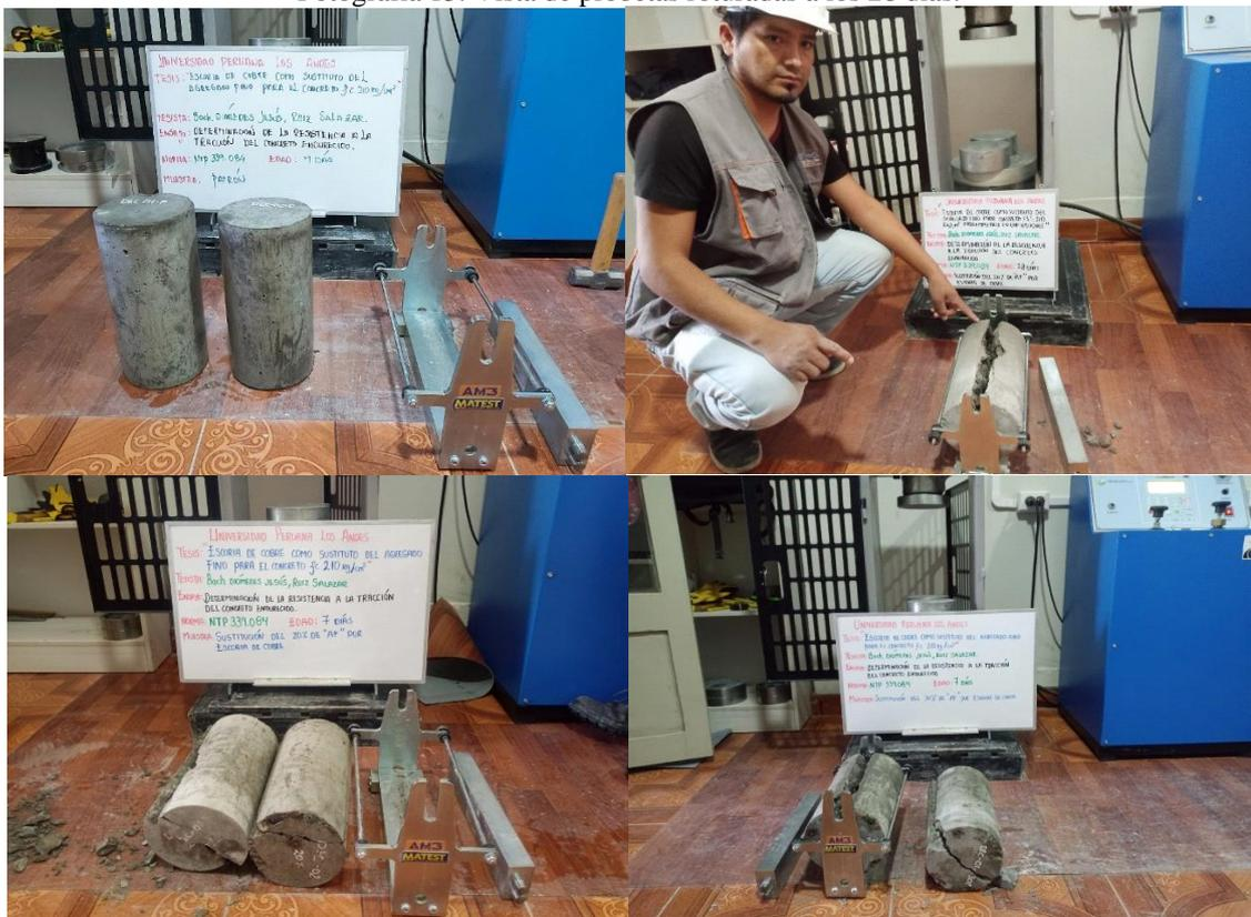
Fotografía 16. Vista de las roturas a tracción de las probetas a los 7 días.
