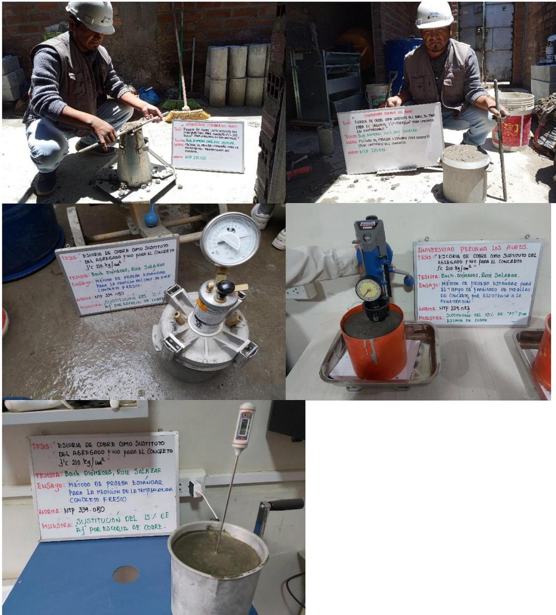
Fotografía 9. Medición de las propiedades en estado fresco del concreto con 15 % de escoria de cobre (asentamiento, peso unitario, contenido de aire, tiempo de fraguado y temperatura).
