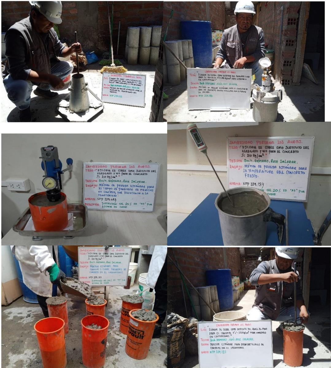
Fotografía 10. Medición de las propiedades en estado fresco del concreto con 20 % de escoria de cobre (asentamiento, peso unitario, contenido de aire, tiempo de fraguado y temperatura); además de la elaboración de probetas.
