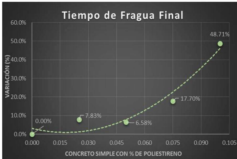
Figura 26: Comportamiento del tiempo de fragua final del concreto con poliestireno expandido respecto al convencional
