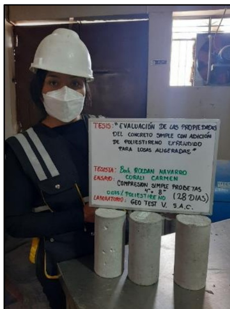
Fotografía N° 20: Testigos cilíndricos incorporados el 0.075% de poliestireno expandido para la resistencia a la compresión de los 28 días de edad, según referencia de la norma NTP 339.034/ ASTM C39.
