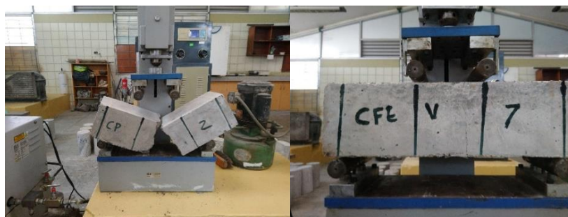
Figura 4:2 Especímenes ensayados a flexión
