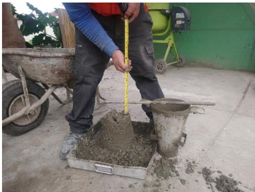
Foto 47: Medición del slump
