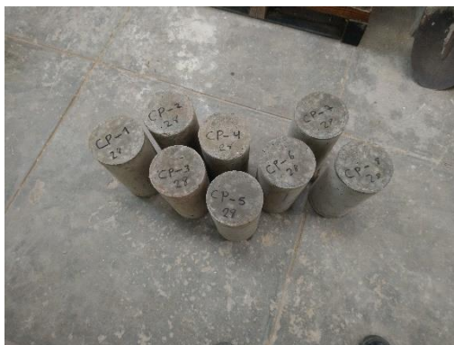
Foto 22: Desmolde de probetas
