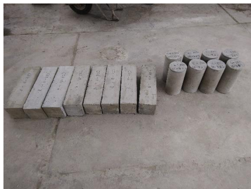
Foto 33: Desmolde de probetas
