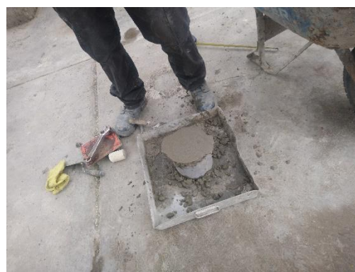
Foto 36: Enrazado para peso específico
