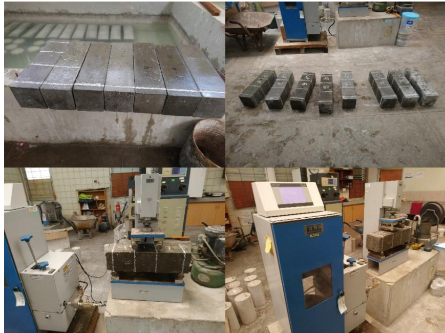
Figura 3:16 Resistencia a la flexión de concreto
