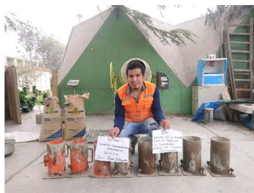
Foto 25: Elaboración de probetas
