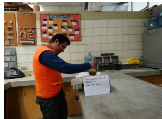
Foto 12: Pesado de la fiola con agua y agregado
