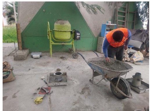
Foto 48: Varillado para peso específico I
