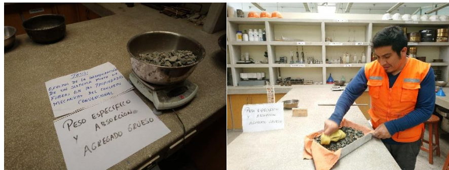
Figura 3:5 Gravedad específica y absorción del agregado grueso
