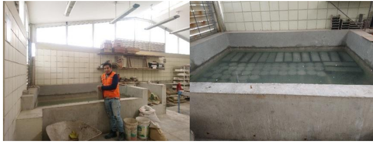
Figura 3:11 Curado de probetas cilíndricas y prismáticas
