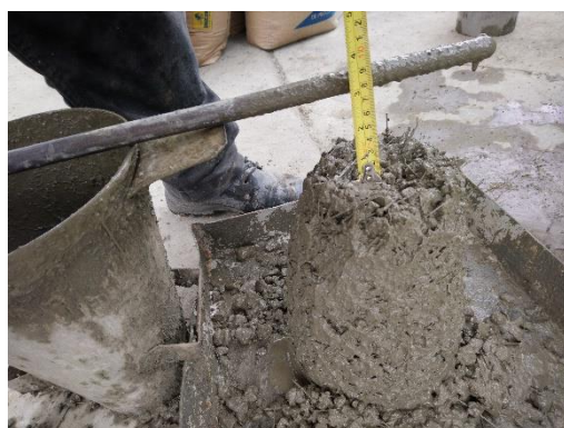
Foto 35: Medición del slump
