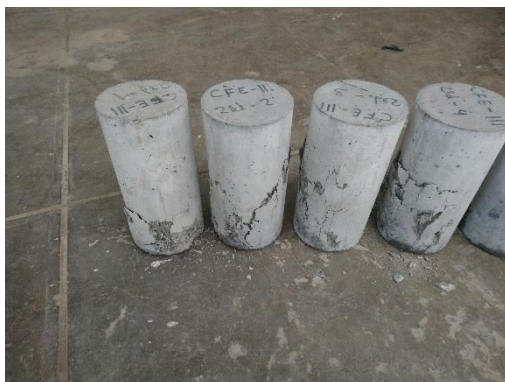
Foto 53: Rotura de probetas de CFE - III
