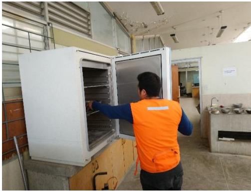
Foto 15: Colocado al horno las muestras para obtener su humedad y absorción natural
