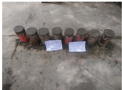
Foto 44: Vaciado de probetas
