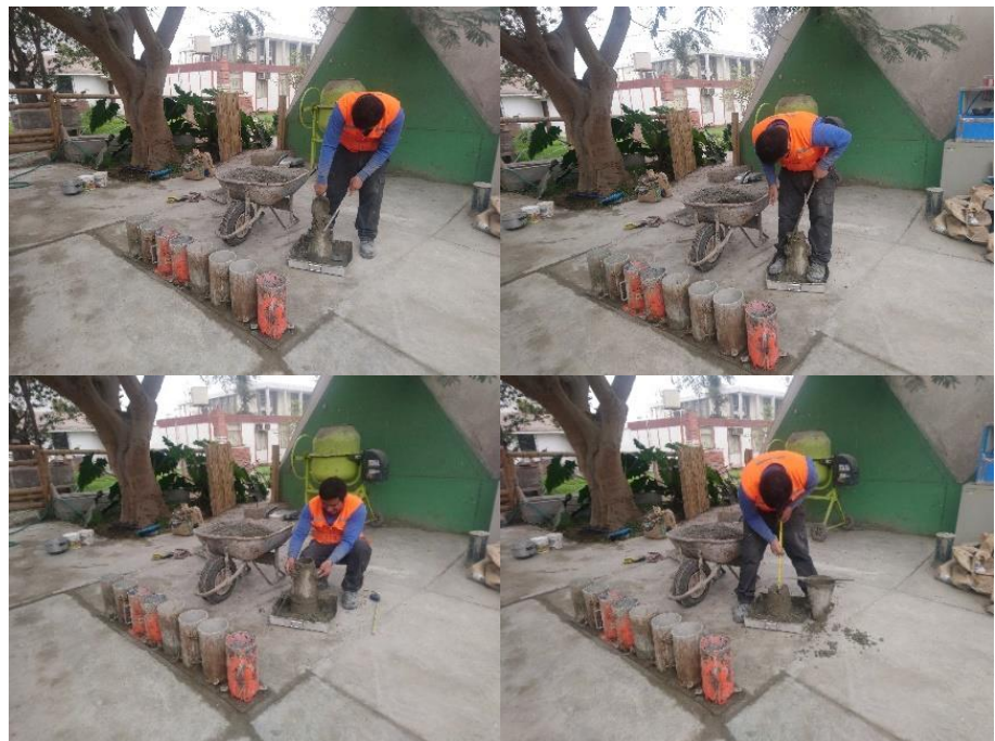
Figura 3:12 Cono de Abrams: capas, varillado y medición del slump.
