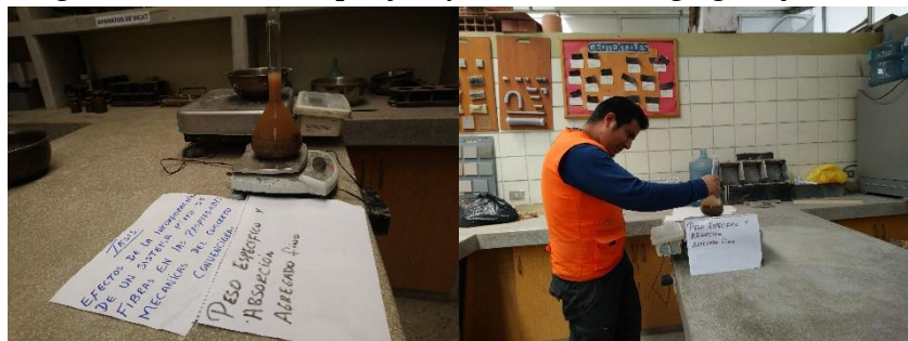
Figura 3:6 Gravedad específica y absorción del agregado fino
