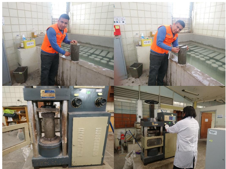
Figura 3:14 Resistencia a la compresión de concreto
