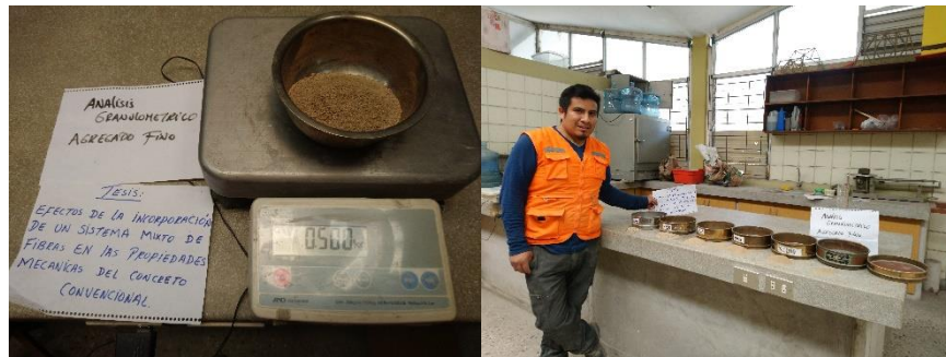
Figura 3:1 Análisis granulométrico – Agregado fino
