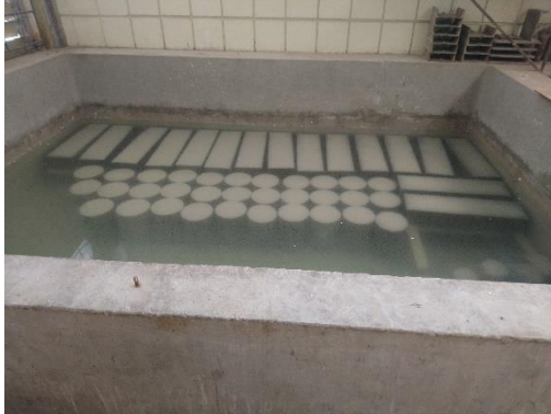
Foto 45: Curado de probetas
