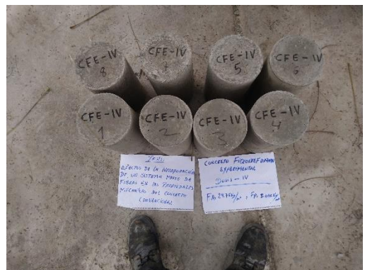
Foto 50: Desmolde de probetas
