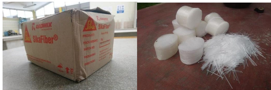
Figura 2:11 Fibra de polipropileno
