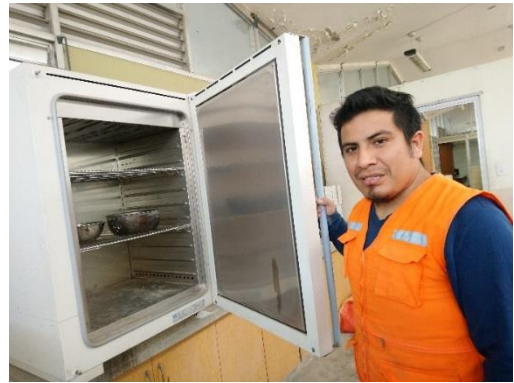
Foto 15: Colocado al horno las muestras para obtener su humedad y absorción natural
