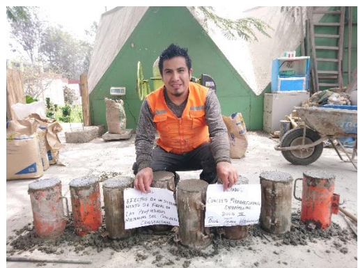
Foto 32: Vaciado de probetas
