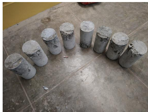
Foto 54: Rotura de probetas de CFE - V
