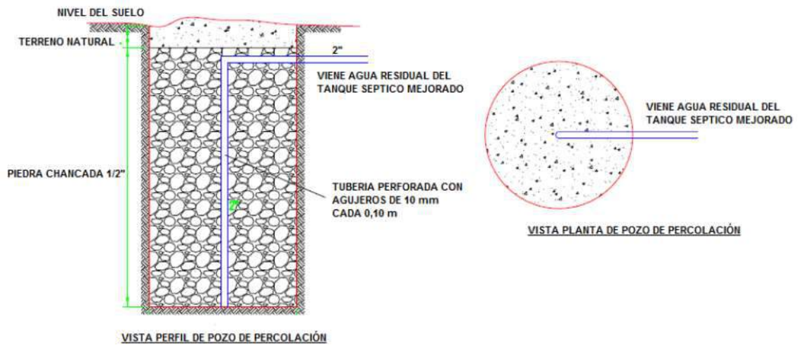
Figura 13- Pozo de absorción.
