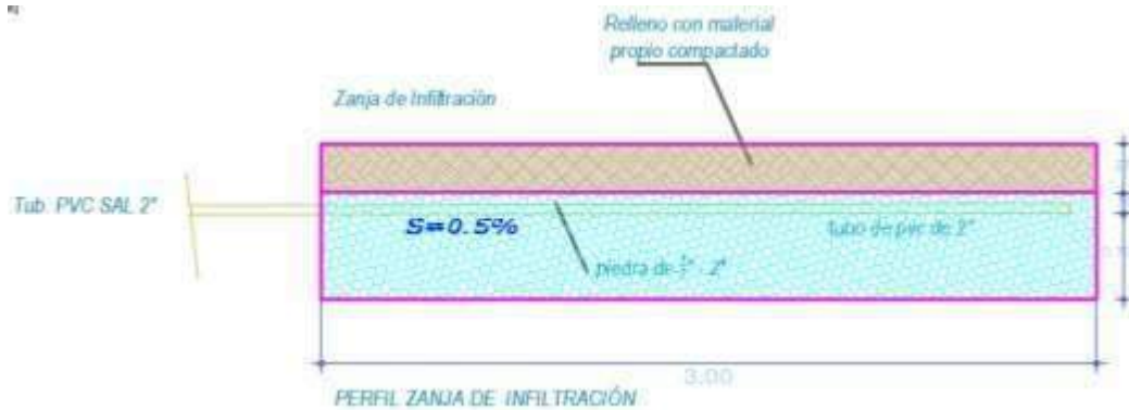
Figura 2. Planta y Perfil de Zanja de Infiltración
