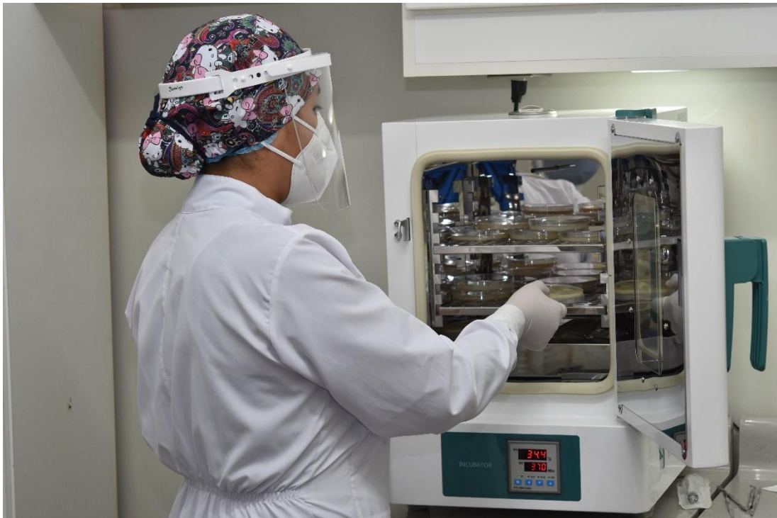
Fotografía 25. Incubación de las placas Petri a 37 °C durante hasta las 48 horas de evaluación.
