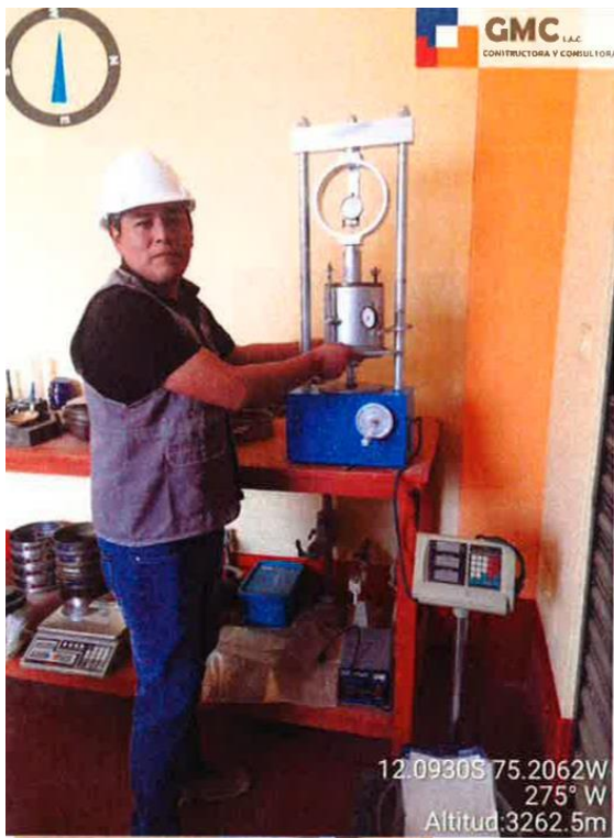
Fotografía 8. Ejecución del ensayo de CBR en los suelos.
