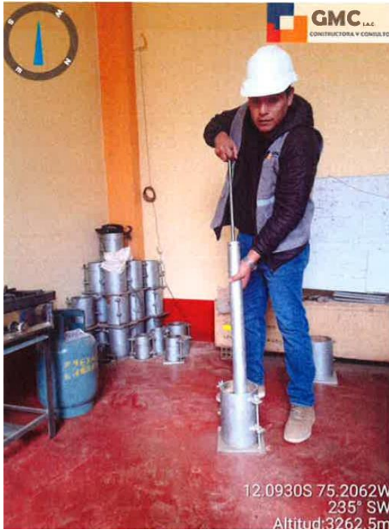
Fotografía 7. Compactación del suelo.
