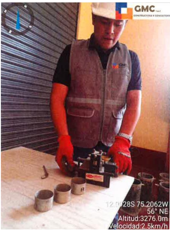
Fotografía 6. Determinación del límite líquido del suelo.
