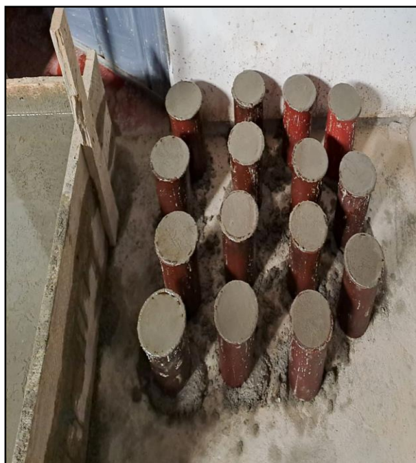
Fotografía N°8: Elaboración de 15 especímenes cilíndricos de concreto bajo normativa MTC E 702
