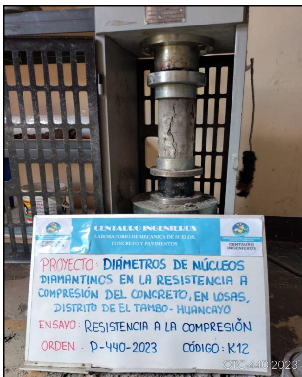
Fotografía N°15: Ensayo de Resistencia a la compresión especímenes cilíndricos bajo normativa ASTM C39/C39M
