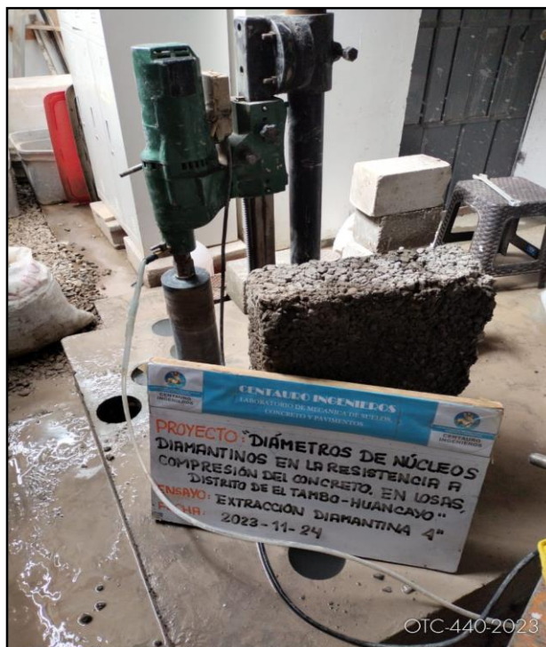
Fotografía N°11: Ensayo de Extracción de núcleos diamantinos bajo normativa NTP 339.059
