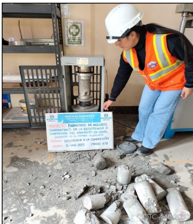
Fotografía N°14: Ensayo de Resistencia a la compresión especímenes cilíndricos bajo normativa ASTM C39/C39M
