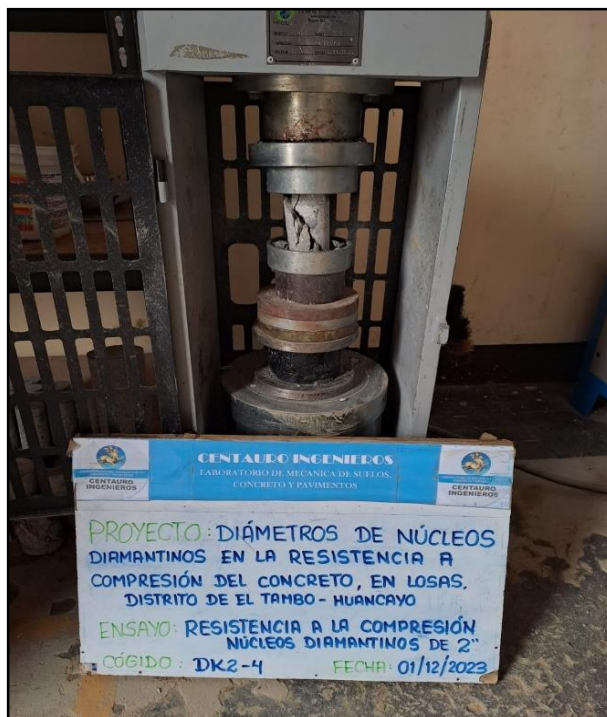
Fotografía N°17: Ensayo de Resistencia a la compresión núcleos diamantinos 2” bajo normativa ASTM C39/C39M
