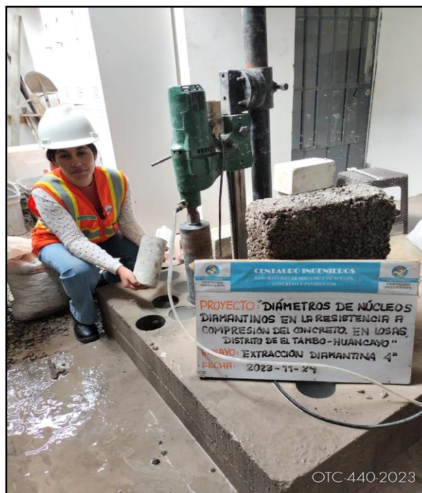
Fotografía N°12: Ensayo de Extracción de núcleos diamantinos bajo normativa NTP 339.059
