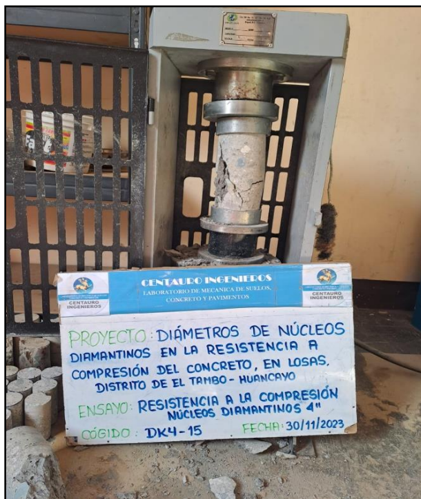
Fotografía N°23: Ensayo de Resistencia a la compresión núcleos diamantinos 4" bajo normativa ASTM C39/C39M
