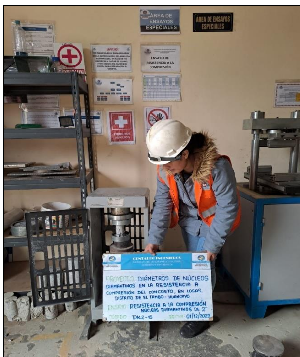
Fotografía N°18: Ensayo de Resistencia a la compresión núcleos diamantinos 2” bajo normativa ASTM C39/C39M
