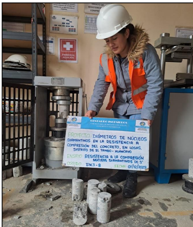
Fotografía N°19: Ensayo de Resistencia a la compresión núcleos diamantinos 3” bajo normativa ASTM C39/C39M
