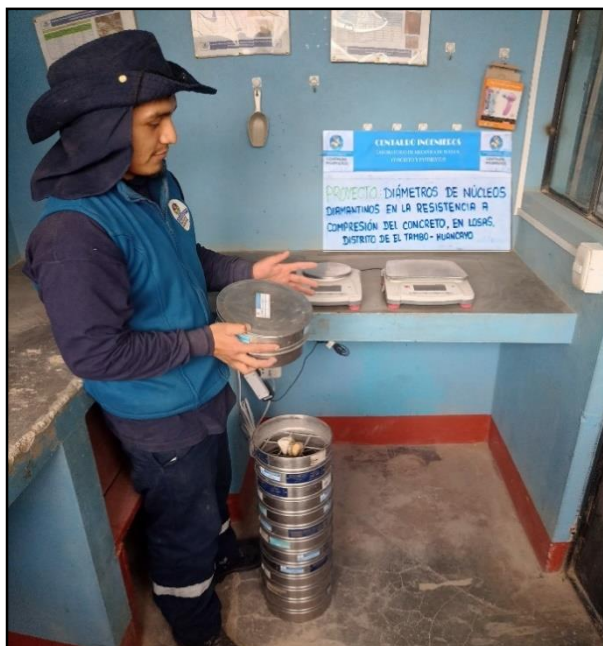
Fotografía N°1: Ensayo de granulometría bajo normativa ASTM C136/C136M
