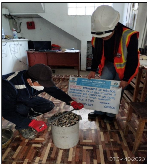
Fotografía N°2: Ensayo de Peso unitario suelto y compactado (PUC-PUS) bajo normativa NTP 400.017
