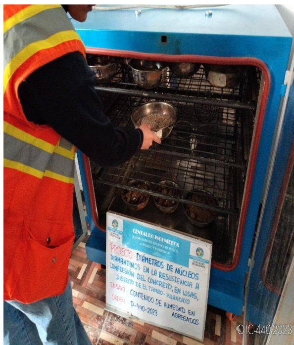
Fotografía N°5: Ensayo de Contenido de Humedad bajo normativa NTP 339.185
