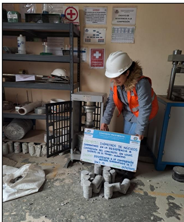
Fotografía N°20: Ensayo de Resistencia a la compresión núcleos diamantinos 3” bajo normativa ASTM C39/C39M
