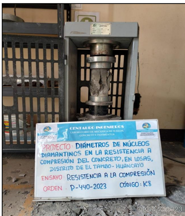
Fotografía N°13: Ensayo de Resistencia a la compresión especímenes cilíndricos bajo normativa ASTM C39/C39M
