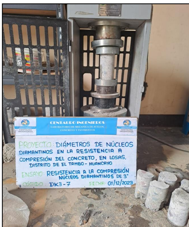
Fotografía N°21: Ensayo de Resistencia a la compresión núcleos diamantinos 3” bajo normativa ASTM C39/C39M
