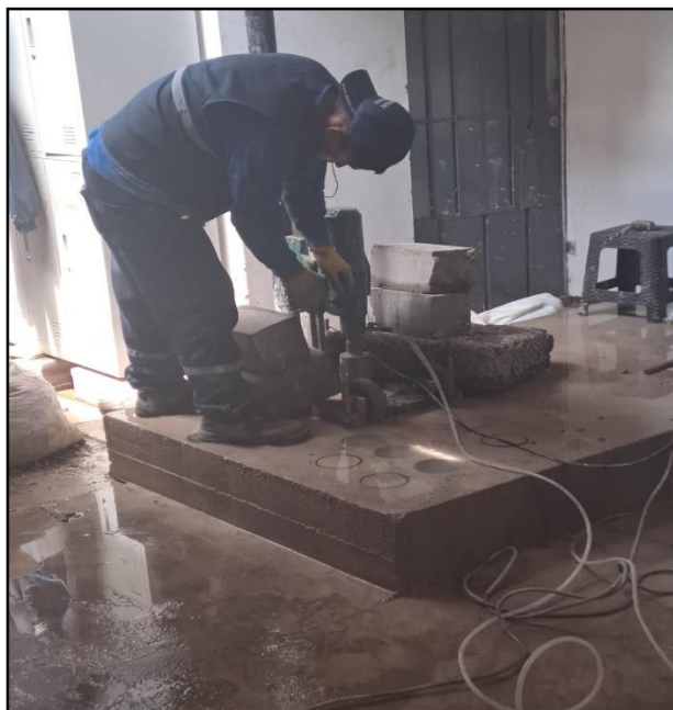
Fotografía N°10: Ensayo de Extracción de núcleos diamantinos bajo normativa NTP 339.059
