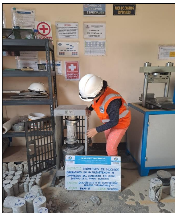
Fotografía N°22: Ensayo de Resistencia a la compresión núcleos diamantinos 4” bajo normativa ASTM C39/C39M
