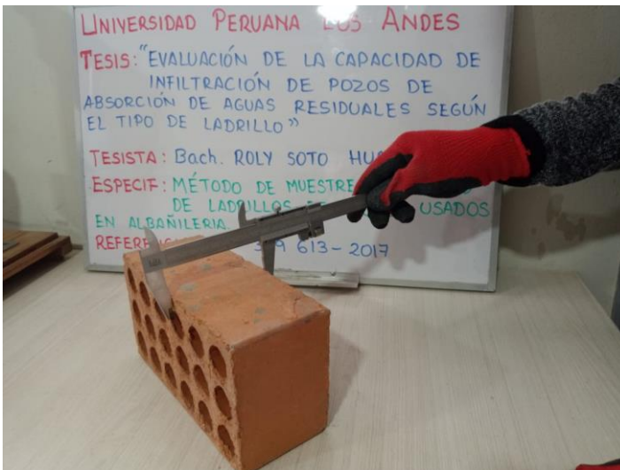
Fotografía 20. Medición de las dimensiones de las unidades de albañilería industrial.
