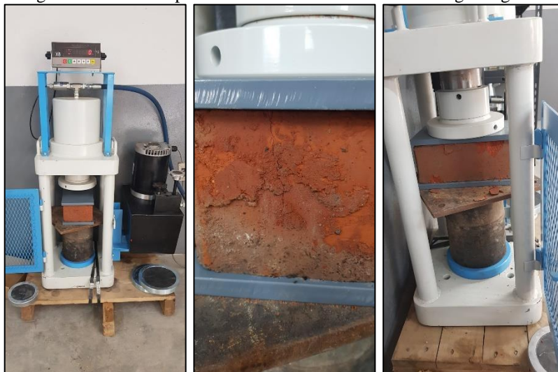
Fotografía 9. Medición de la resistencia a compresión del ladrillo cocido de arcilla.
