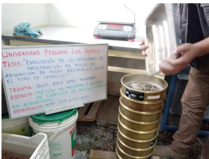
Fotografía 3. Vista del proceso de granulometría del suelo.
