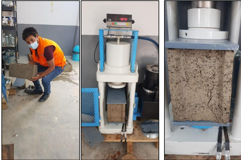
Fotografía 10. Vista de rotura de los ladrillos de King Kong.
