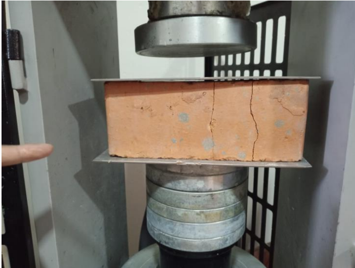
Fotografía 25. Vista de la rotura de las unidades de albañilería industrial.
