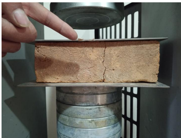
Fotografía 24. Vista de la rotura a compresión de las unidades de albañilería artesanal.
