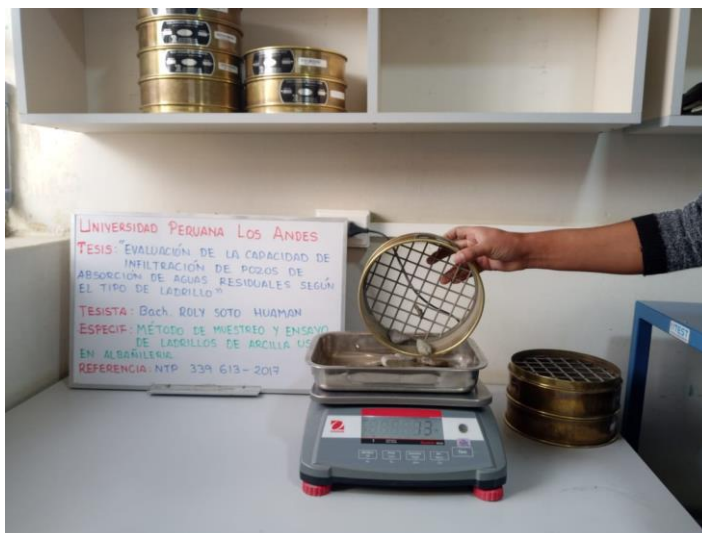
Fotografía 2. Vista del pesaje del material retenido en la mala de 1/2".
