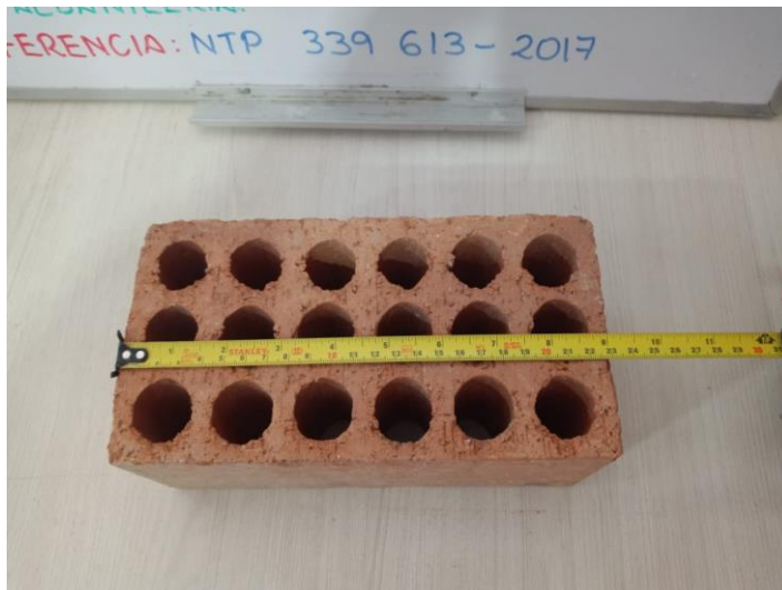
Fotografía 22. Determinación del “largo” de las unidades de albañilería industrial.
