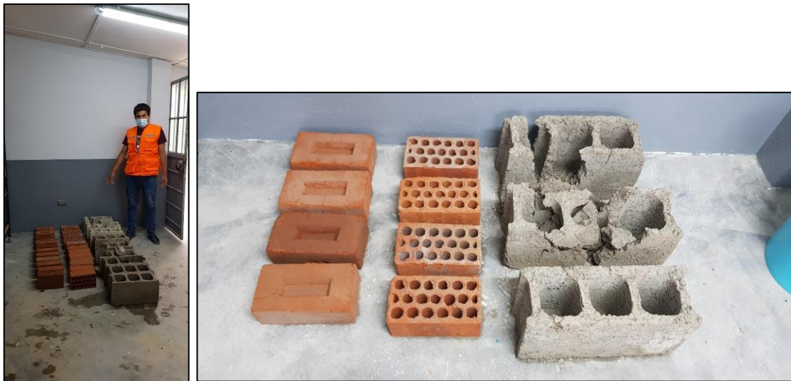
Fotografía 11. Vista de los ladrillos después de haber estado en los pozos de percolación.
