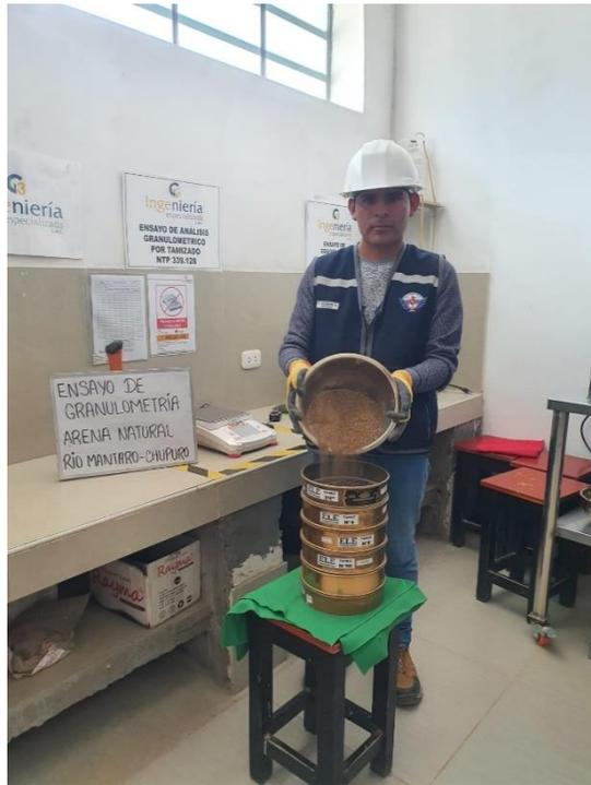
*Figura 15: Ensayo de granulometría de arena natural cantera Chupuro*
