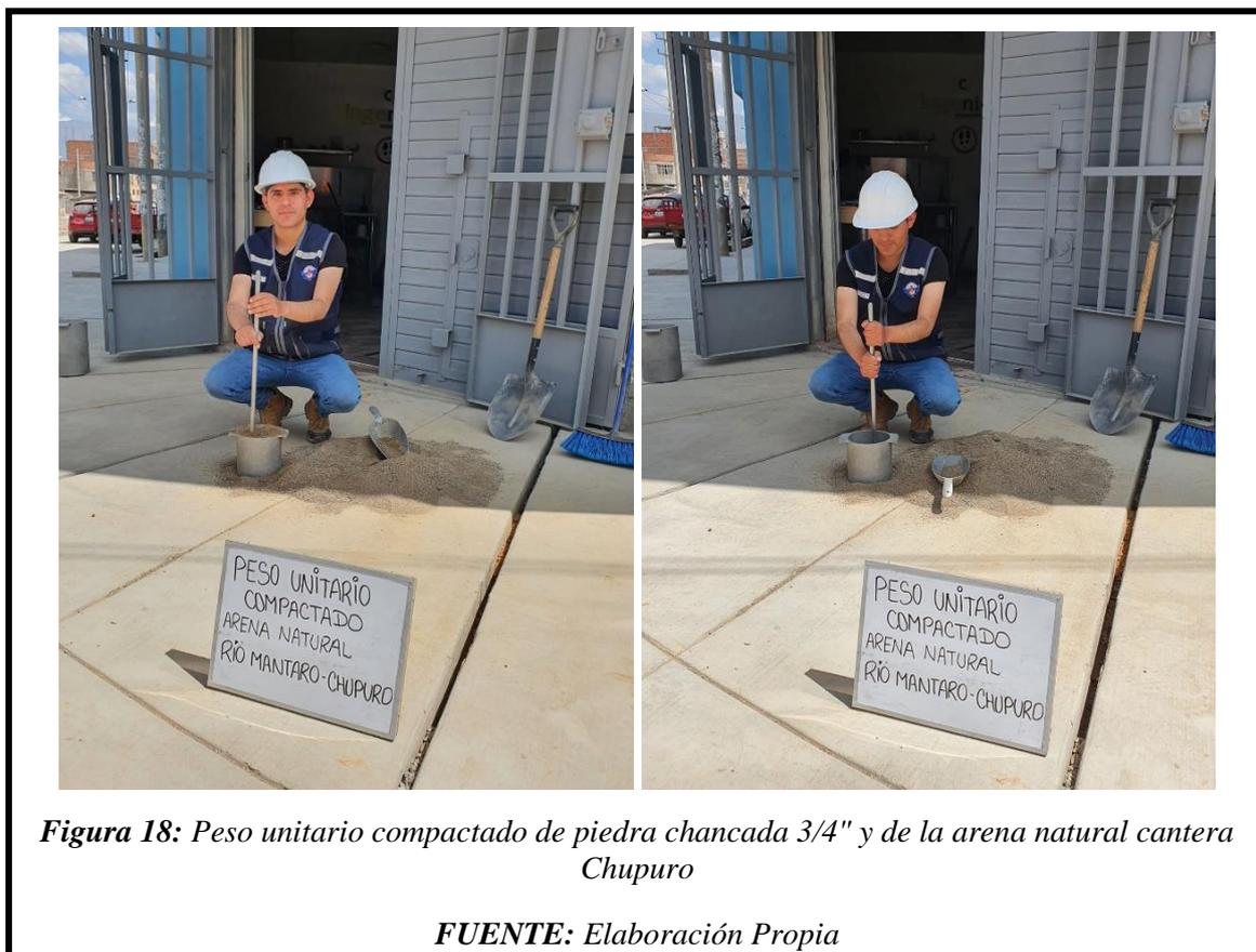
**Figura 18:** *Peso unitario compactado de piedra chancada 3/4" y de la arena natural cantera Chupuro*
