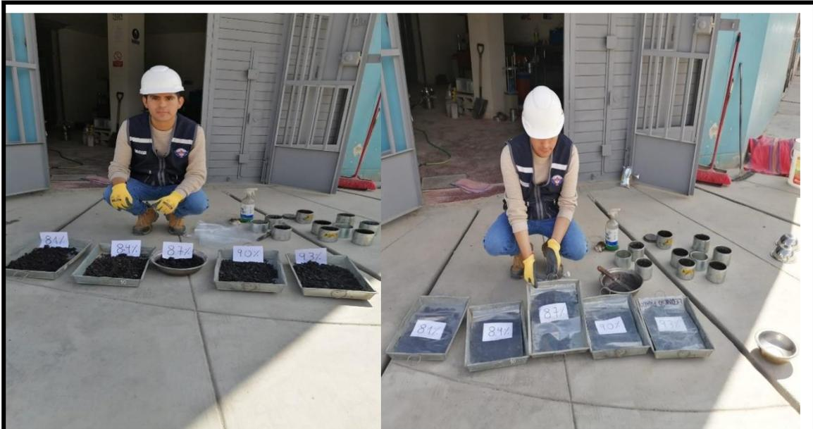
**Figura 23:** Determinación del porcentaje óptimo de emulsión asfáltica
