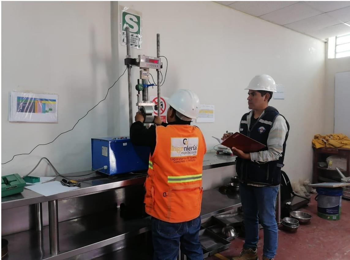
*Figura 39: Rotura de las briquetas, cálculo de la estabilidad*
