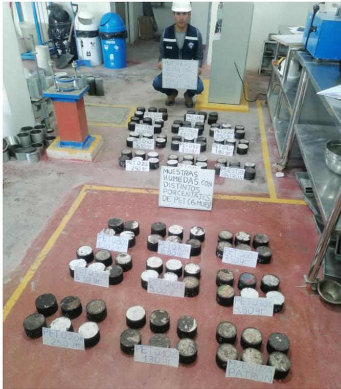
**Figura 33:** Briquetas a ser ensayadas para el cálculo de la estabilidad y el flujo
