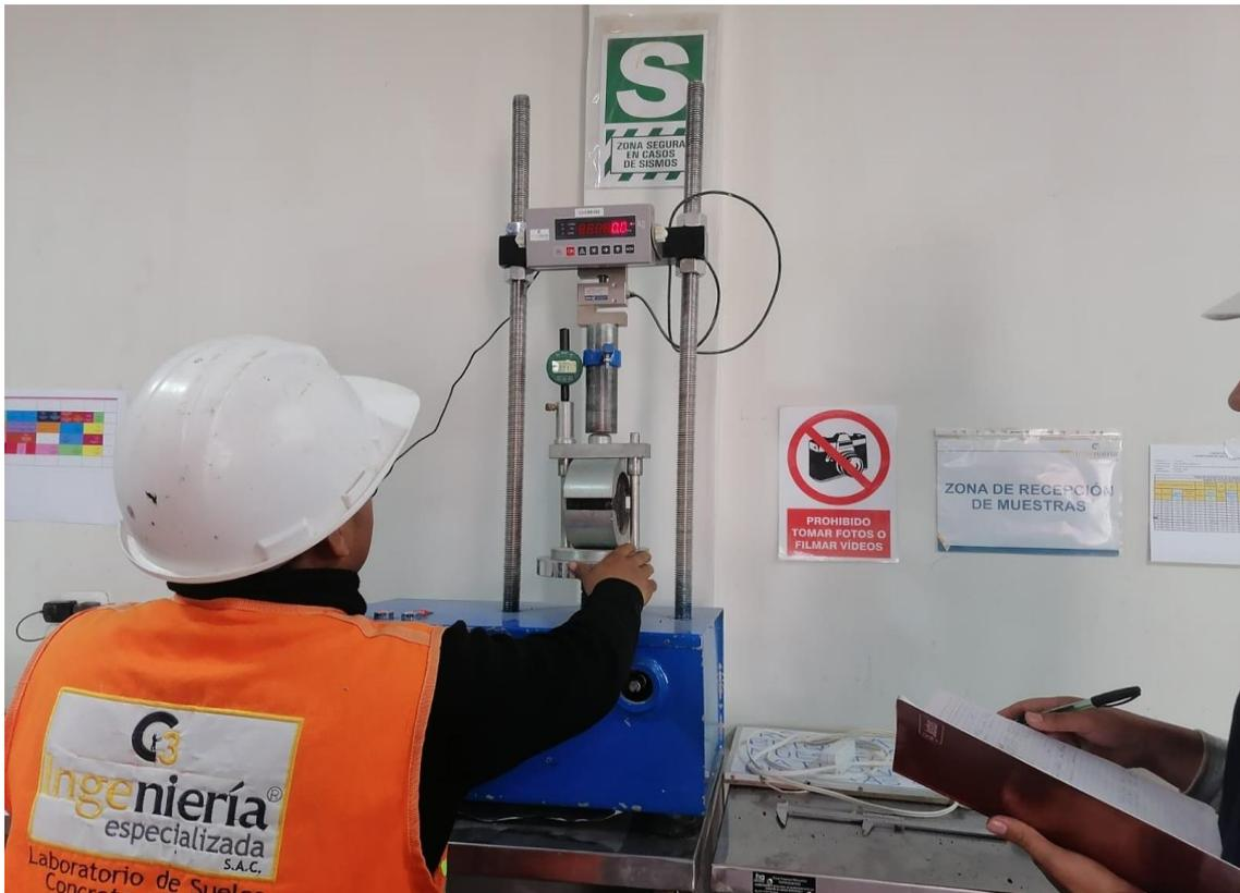
**Figura 38:** Rotura de las briquetas, muestra patrón 6 muestras secas
