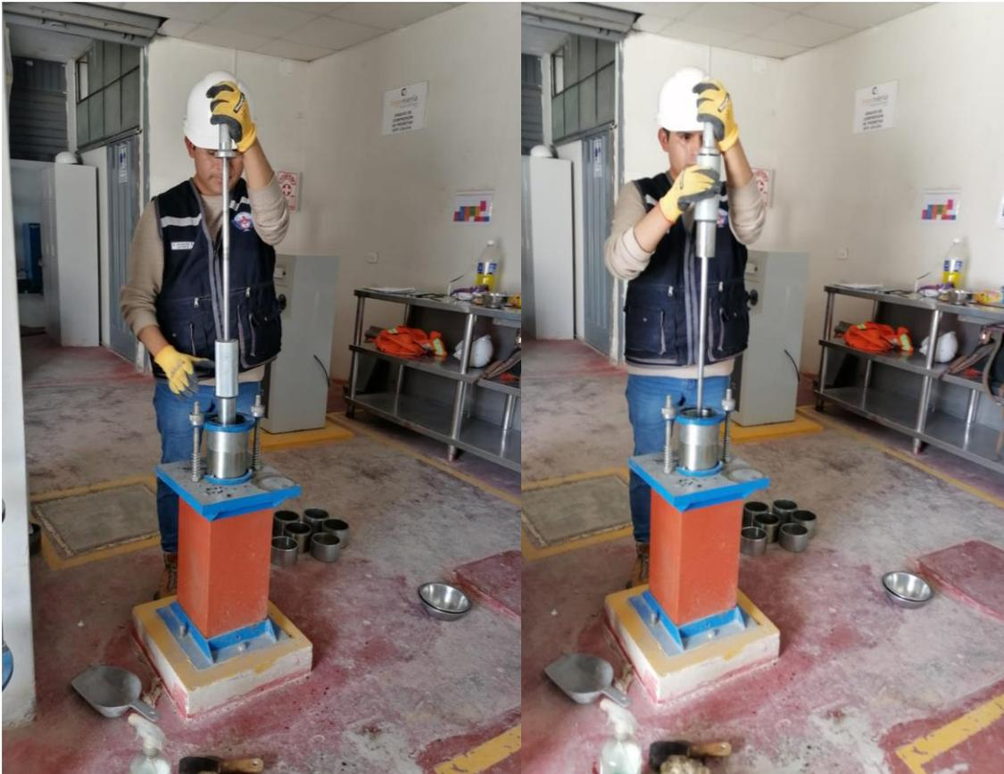
**Figura 32:** Elaborando muestras de briquetas con 75 golpes en la compactación en cada cara
