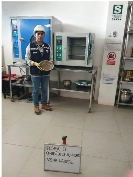
*Figura 16: Ensayo de contenido de humedad de arena natural cantera Chupuro*
