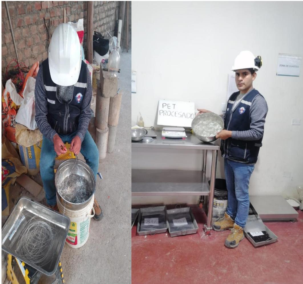
**Figura 10:** *Procesamiento de las fibras de polietileno de botellas recicladas PET*
