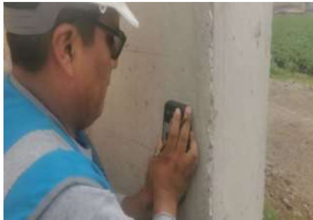
Figura 6 Proceso de medición de la velocidad de pulso ultrasónico Fuente: Propia (2023).
