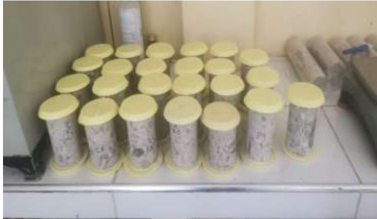
Imagen 07: Vista general de núcleos extraídos de las columnas C-5, C-6 y C-7.
