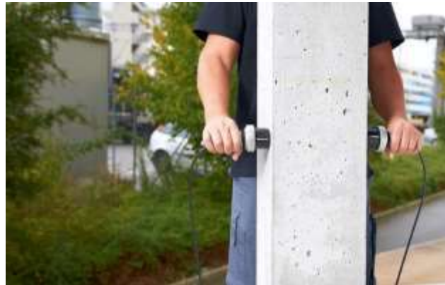
Figura 4 Medición tradicional del pulso ultrasónico Fuente: Proceq (2023).
