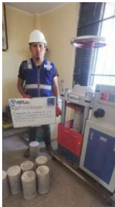
Imagen 08: Vista general del proceso del ensayo de resistencia a compresión en especímenes cilíndricos.
