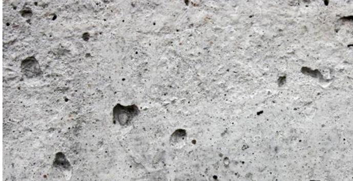
*Figura 3 Aire atrapado en el concreto*
