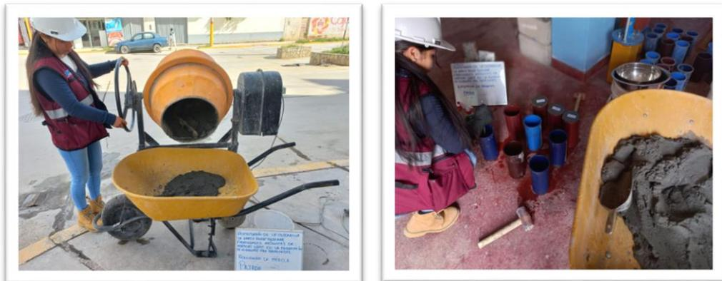
Figura 12 y Figura 13 Mezcla de concreto y elaboración de probetas
