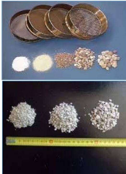
Figura 2 Herramientas para determinar el tamaño máximo de agregado
