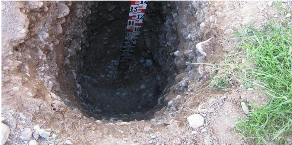
**FOTO 1:** descripción del suelo de la calicata C-1 donde se ve el Tipo de material existe en el anexo de porococha en la Pavimentación empedrada,
