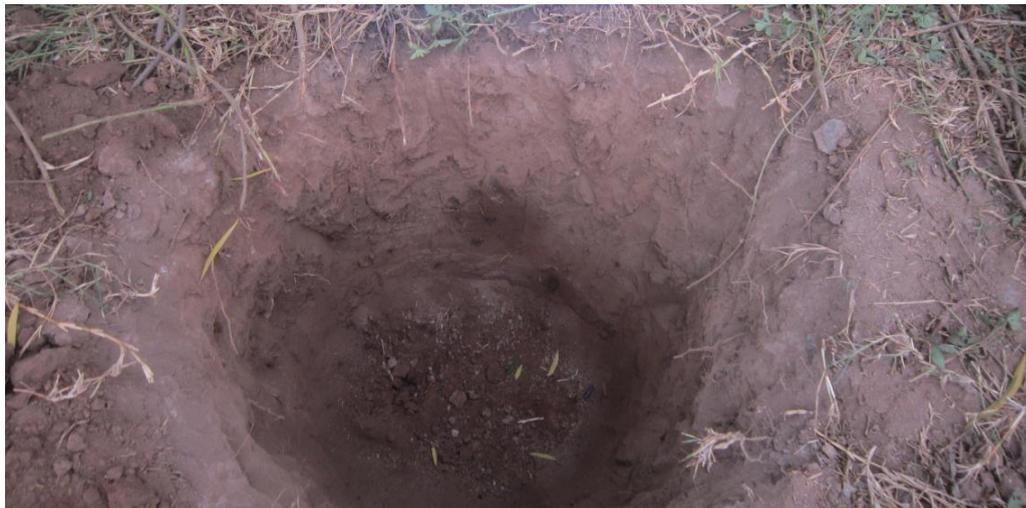
**Foto 2:** se aprecia el material de la excavación de la **calicata C-2**, realizada en la pavimentación empedrada en las calles en el anexo de porococha, distrito de tauripampa-Provincia de Yauyos -Lima. No se encontró el nivel Freático
