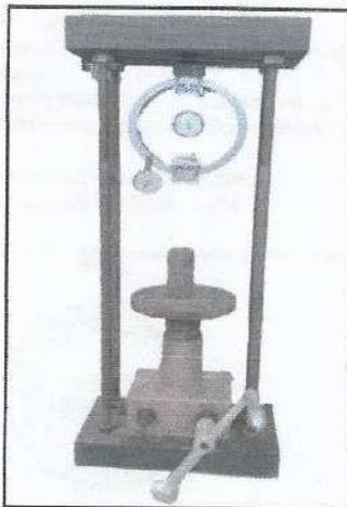
**Equipo 4:** Equipo para ensayo de C.B.R. y anillo de carga de 500 kgf.
