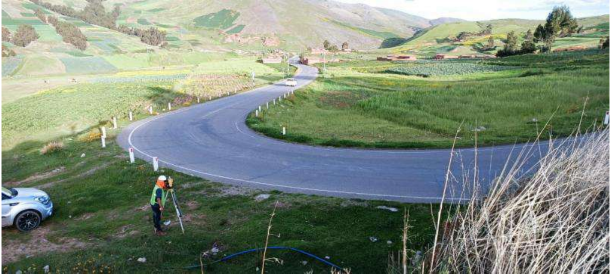
Fotografía N° 5. Toma de datos geométricos de vía
