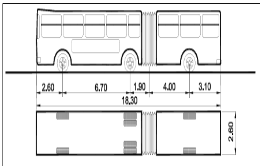
Figura 3. Dimensiones de Ómnibus Articulado (BA-1)
