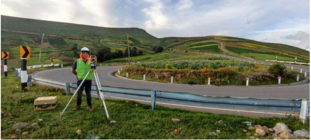
Fotografía N° 3. Levantamiento topográfico de curva sin presencia de sobreebanco
