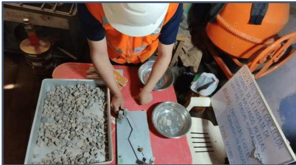
Figura 4.16. Se observa como determinamos las partículas chatas y alargadas
