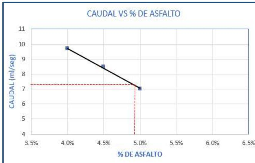
Figura 5.47. Caudal vs % de asfalto.
