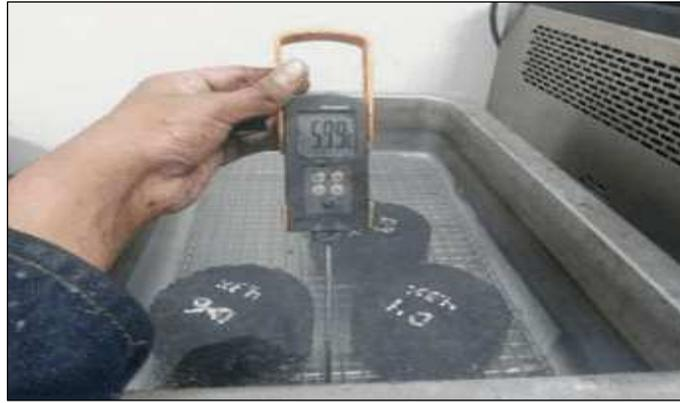
Figura 4.28. Ensayo de cántabro en estado húmedo
