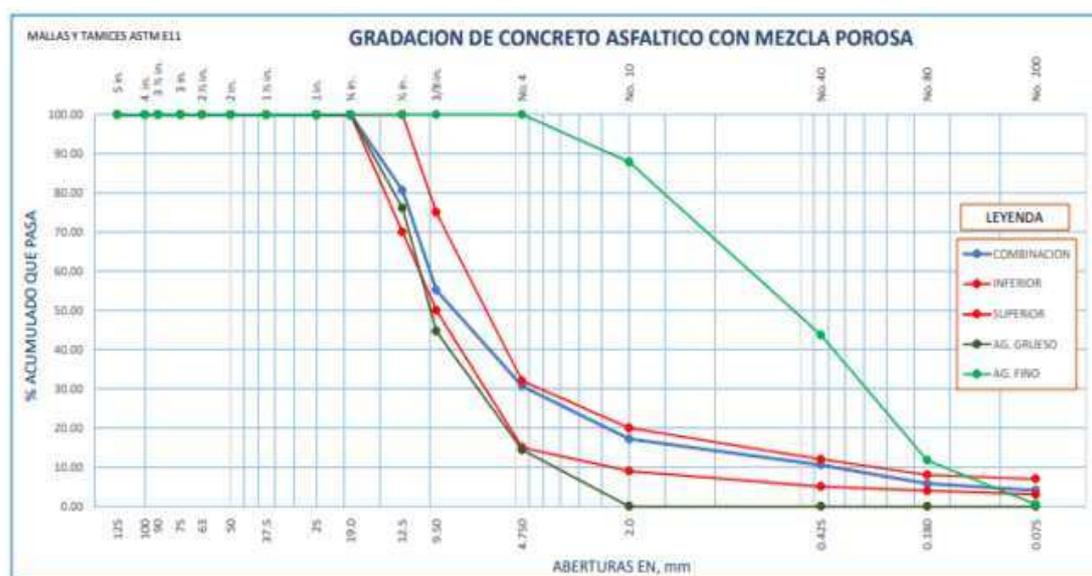
Figura 5.30. Se observa el análisis granulométrico
