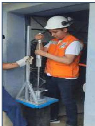
Figura 4.22. Se observa la compactación a 50 golpes cada lado de la muestra.
