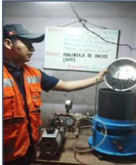
Figura 4.26. Se observa la muestra pasando por el Rice.
