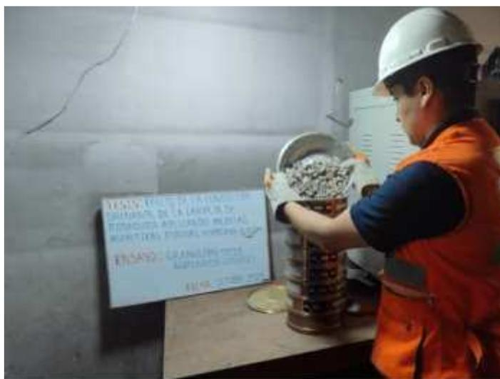
Figura 4.11. Análisis granulométrico por tamizado MTC E 107.
