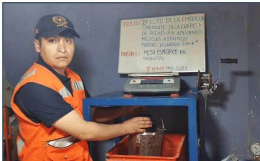
Figura 4.19. Peso específico de briquetas.
