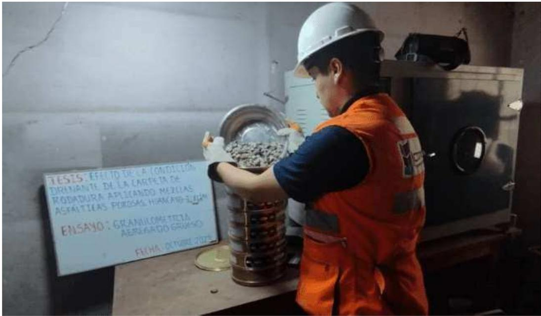
Figura 50. Ensayo análisis granulométrico, tamizado
