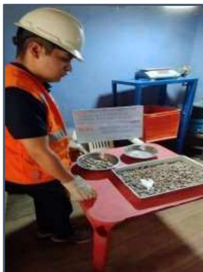
Figura 4.15. Verificando las caras fracturadas del agregado grueso.
