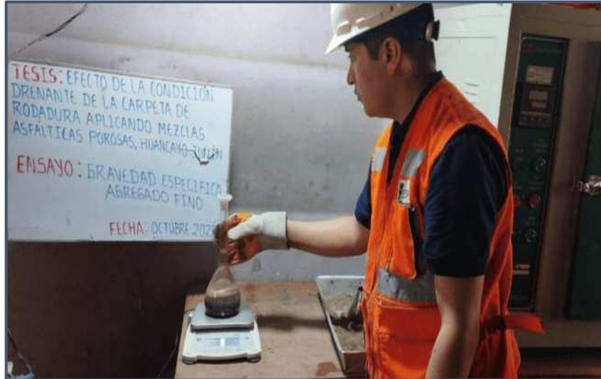
Figura 4.17. Cálculo de la gravedad específica.
