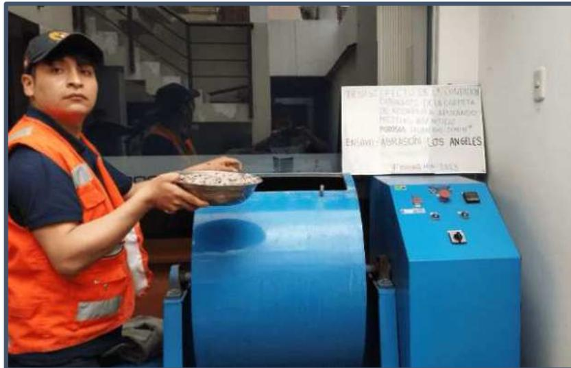
Figura 4.12. Abrasión los ángeles de los agregados.
