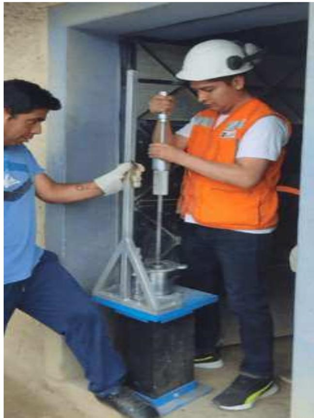
Figura 51. Elaborando de las briquetas porosas a 50 golpes
