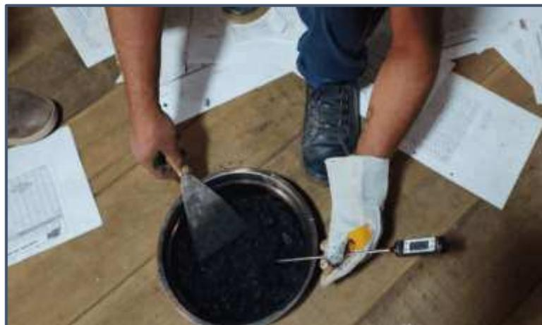
Figura 4.21. Se observa la mezcla de agregado y asfalto a 160°C.
