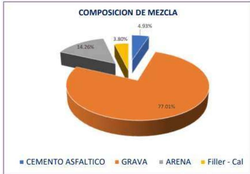
Figura 5.35. Composición de la mezcla asfáltica porosa convencional.
