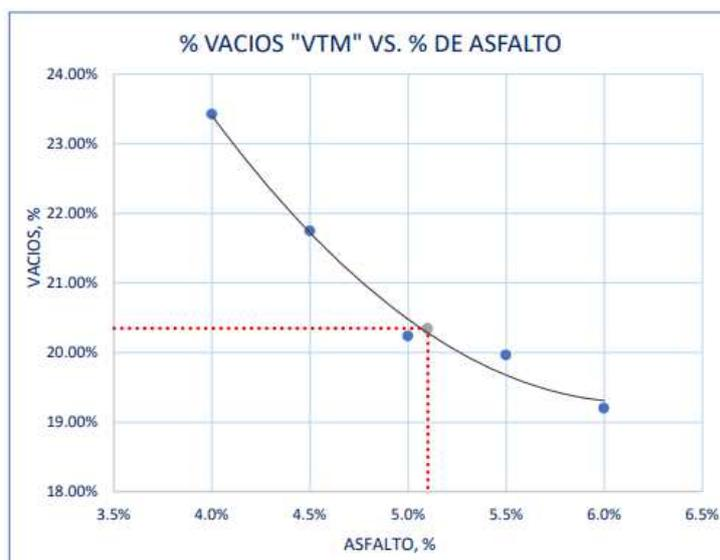
Figura 5.39. % de vacíos vs % de asfalto de la MAC con polímeros.
