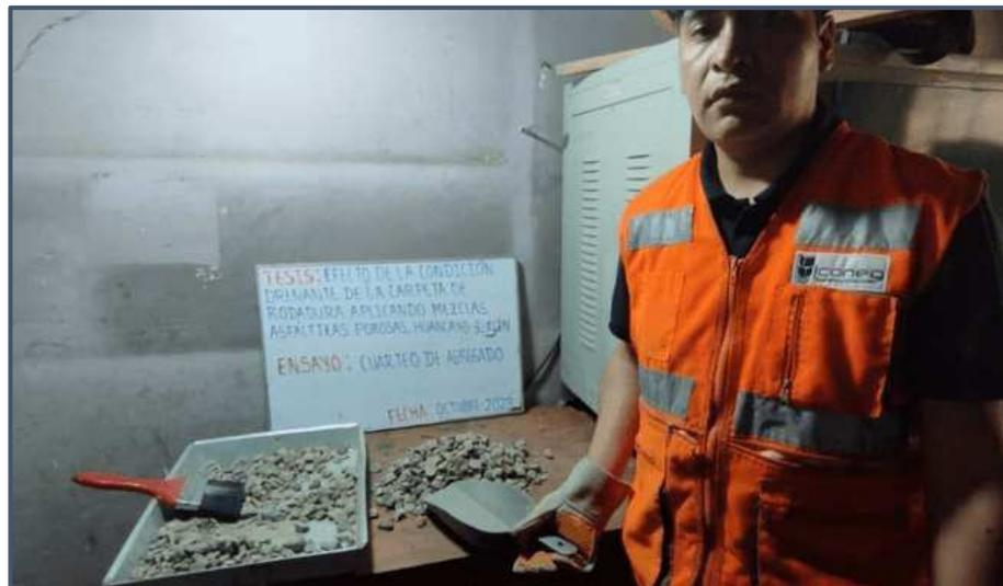
Figura 4.10. Cuarteo de los agregados.
