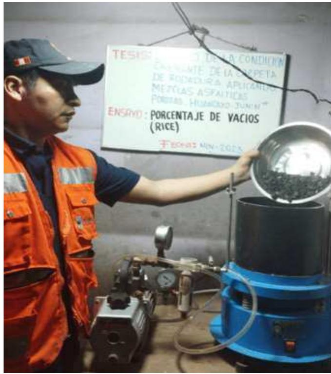
Figura 53. Ensayo de Rice, hallamos el porcentaje de vacíos.
