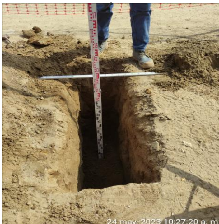
Figura 1. 2 Calicata en el distrito de Ventanilla. Elaboración propia
