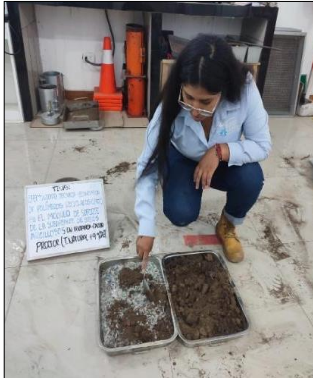
Fotografía mezclando el terreno natural con el PET.
