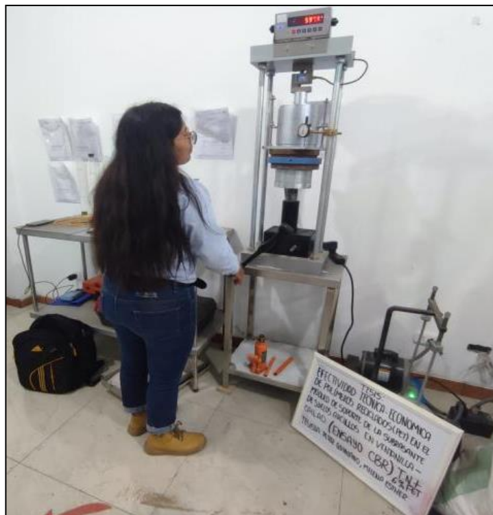
Figura 4. 10 Fotografía realizando el ensayo CBR al 6%. Elaboración propia.
