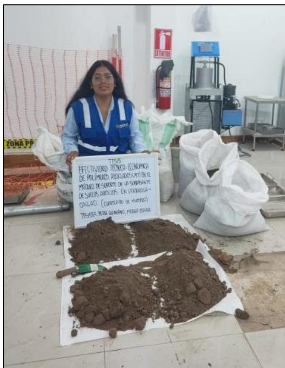
Figura 4. 5 Fotografía del cuarteo. Elaboración propia.
