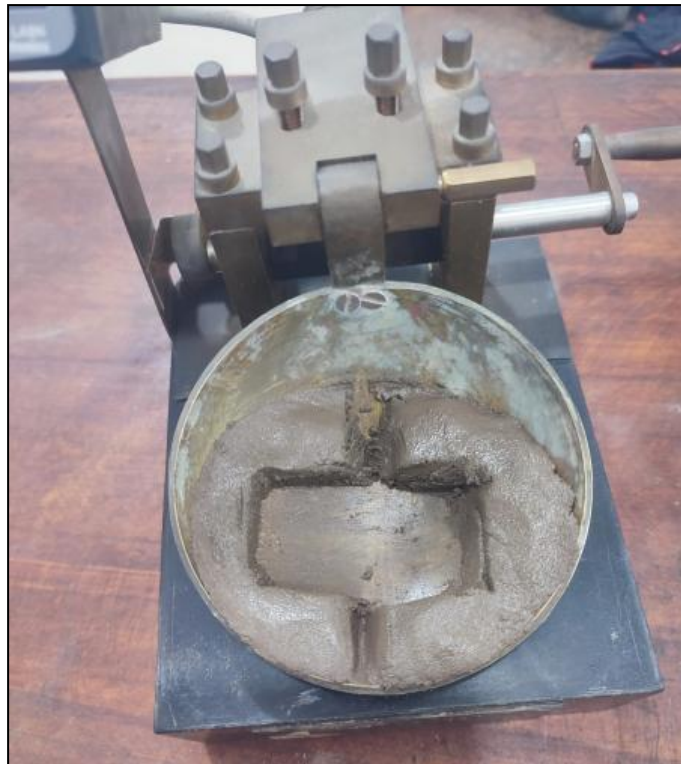
Fotografía del material extraído para el límite plástico.
