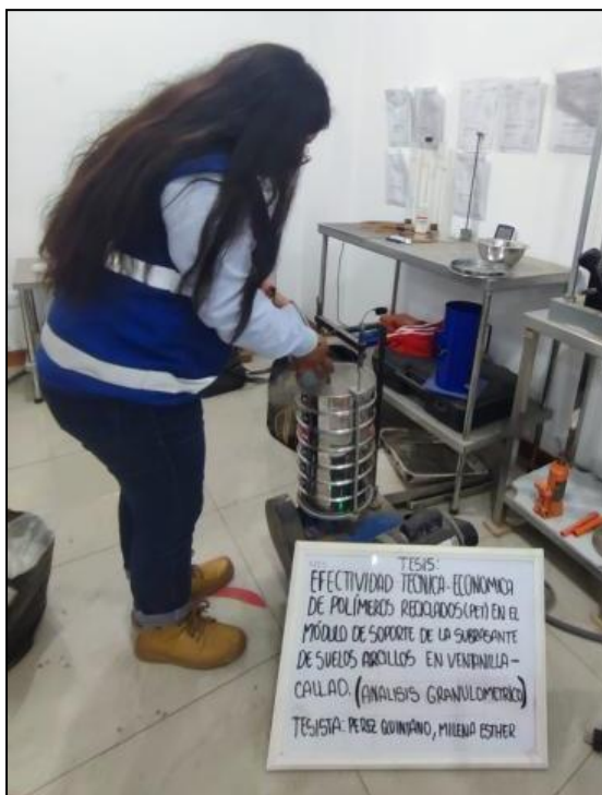
Figura 4. 6 Fotografía de la granulometría. Elaboración propia.
