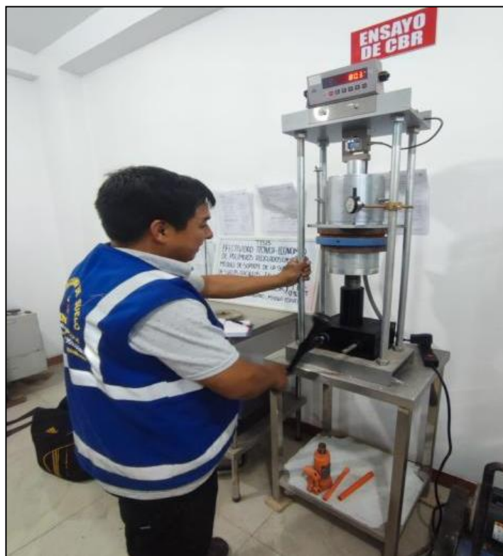
Figura 4. 11 Fotografía realizando el ensayo CBR al 9%. Elaboración propia.
