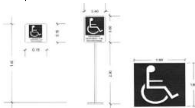
Figura 25 Detalle de señalización para discapacitados
