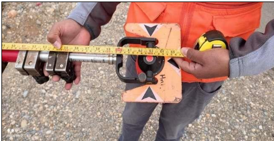
Figura 4: Calibración de bastones y prismas.
