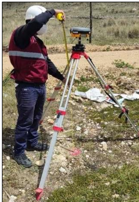
Figura 6: Estacionamiento de GPS diferencial.
