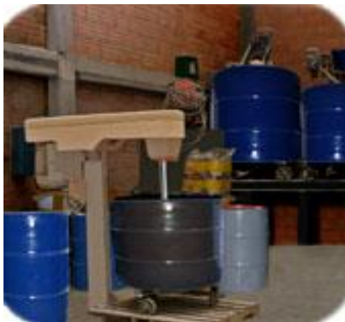
Figura 4. Mezclado de Pintura. Elaboración propia
