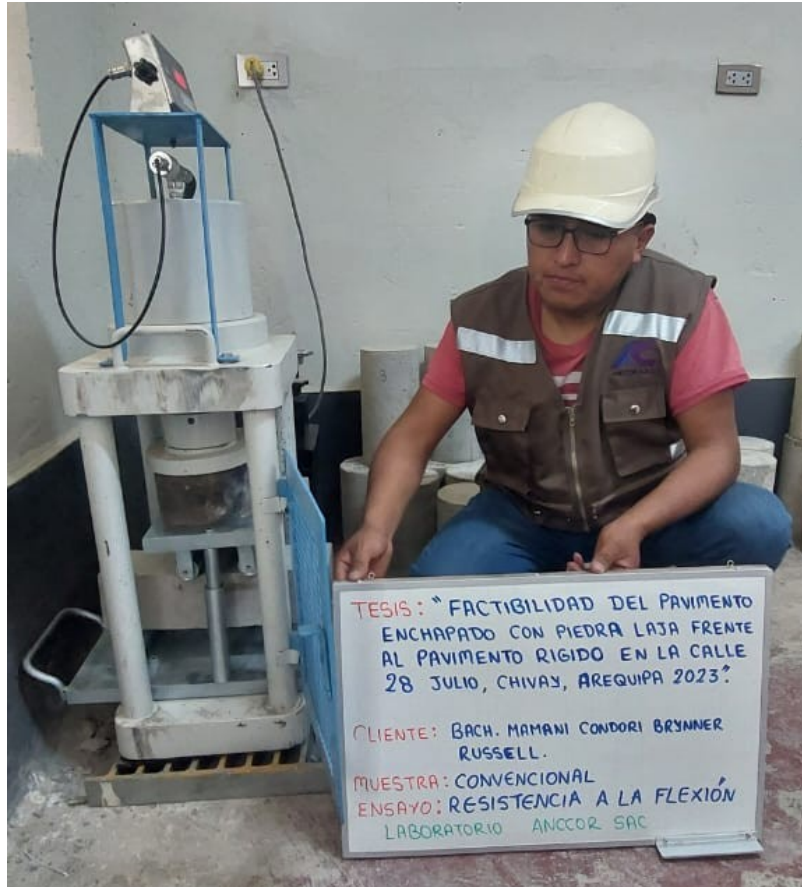
FOTOGRAFÍA 05: Ensayo de Resistencia a la Flexión, pavimento convencional.
