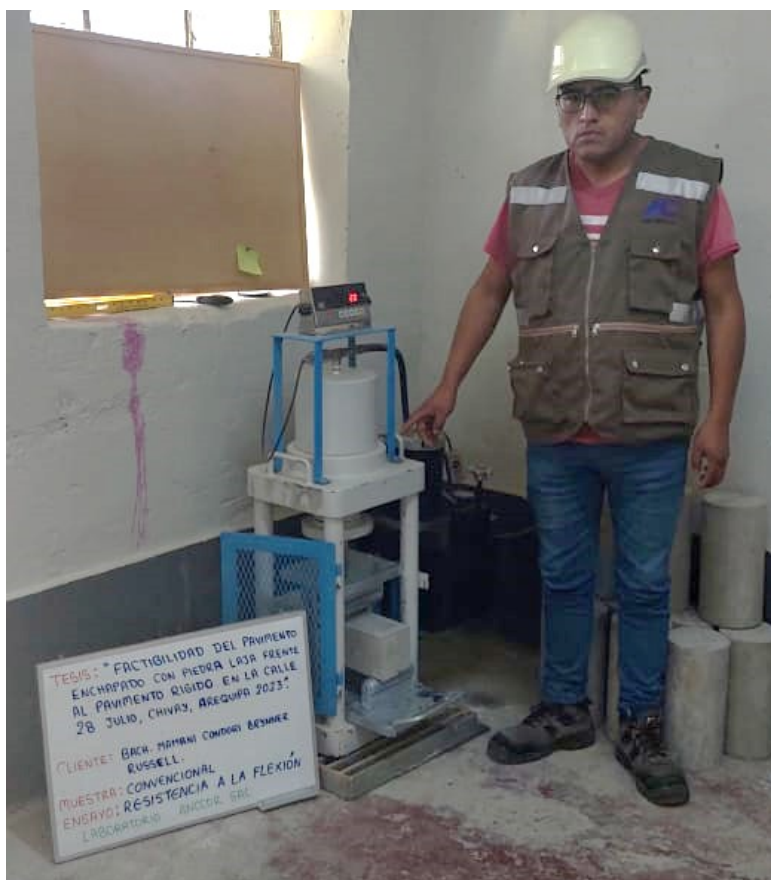
FOTOGRAFÍA 07: Ensayo de Resistencia a la Flexión pavimento convencional.
