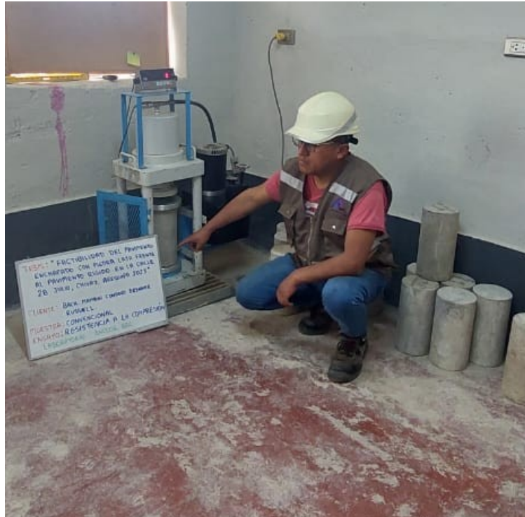
FOTOGRAFÍA 03: Ensayo de Resistencia a la Compresión para pavimento Convencional.
