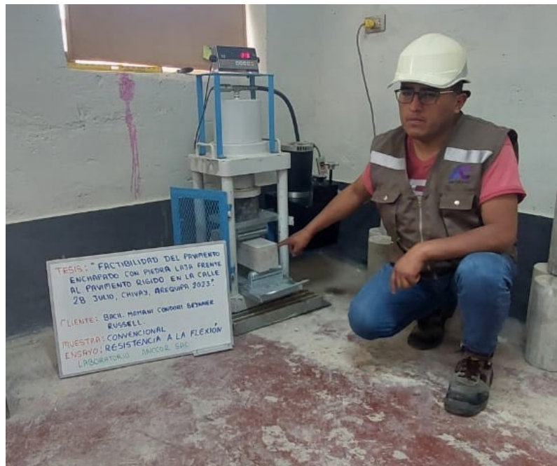
FOTOGRAFÍA 06: Ensayo de resistencia a la Flexión, pavimento convencional.
