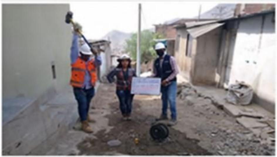
*Fotografía 20: Ensayo de refracción sísmica AA.HH. las lomas de san bentin.*
