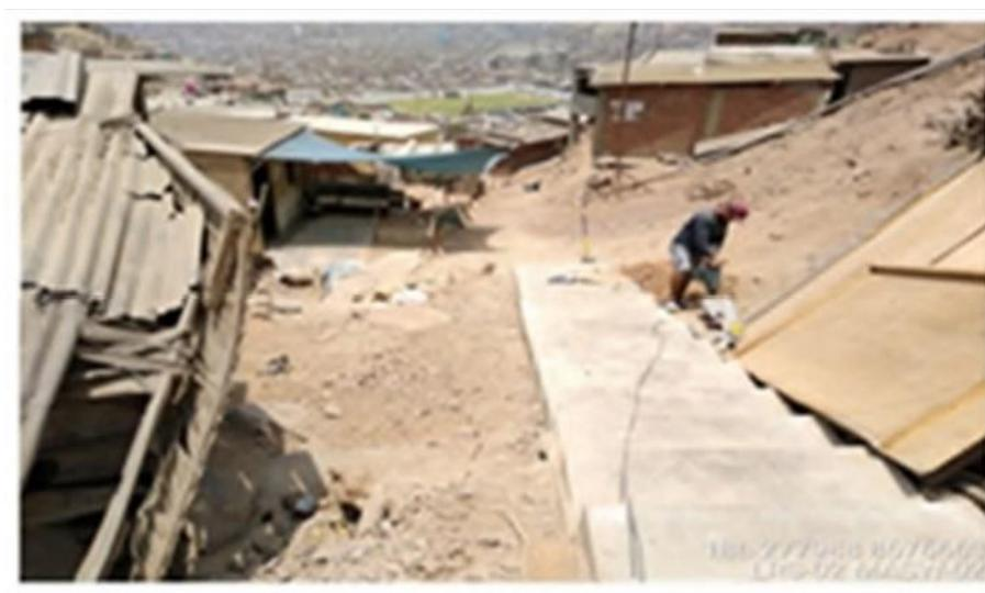
*Fotografía 15: Ensayo de refracción sísmica AA.HH. las lomas de san bentin.*
