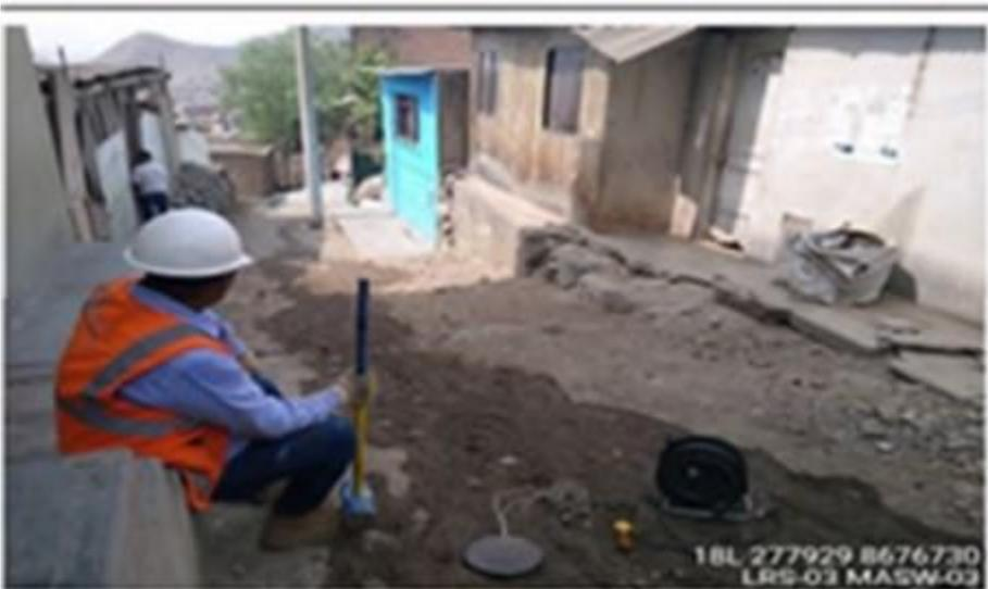
*Fotografía 31: Ensayo de masw métodos geofísicos AA.HH. las lomas de San Bentin*
