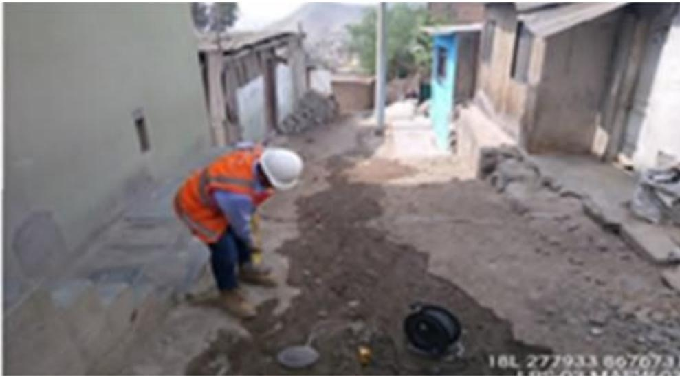
*Fotografía 32: Ensayo de masw métodos geofísicos AA.HH. las lomas de San Bentin*
