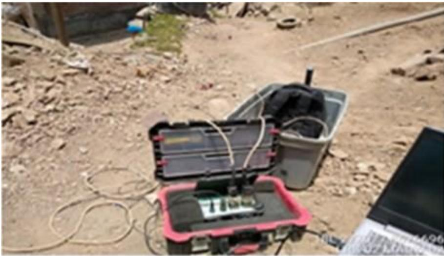
*Fotografía 28: Ensayo de masw métodos geofísicos AA.HH. las lomas de San Bentin*
