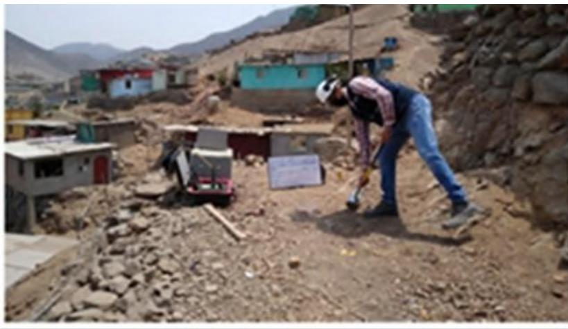
*Fotografía 23: Ensayo de masw métodos geofísicos AA.HH. las lomas de San Bentin*
