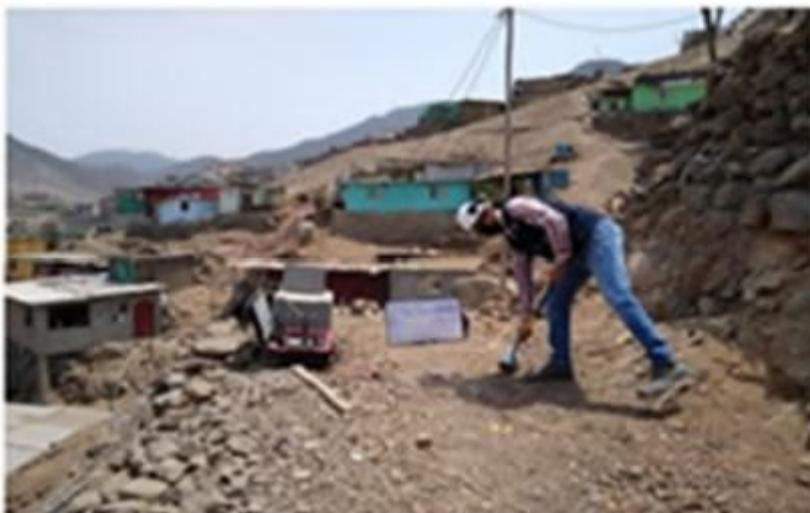
*Fotografía 12: Ensayo de refracción sísmica AA.HH. las lomas de san bentin.*
