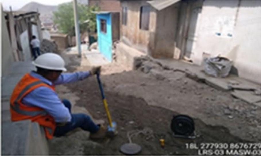
*Fotografía 29: Ensayo de masw métodos geofísicos AA.HH. las lomas de San Bentin*
