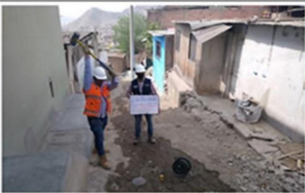
**Fotografía 18:** *Ensayo de refracción sísmica AA.HH. las lomas de san bentin.*
