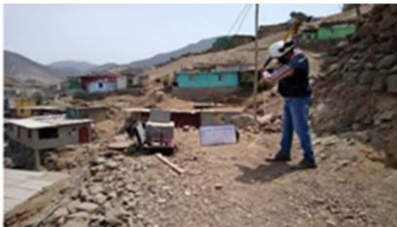
*Fotografía 13: Ensayo de refracción sísmica AA.HH. las lomas de san bentin.*
