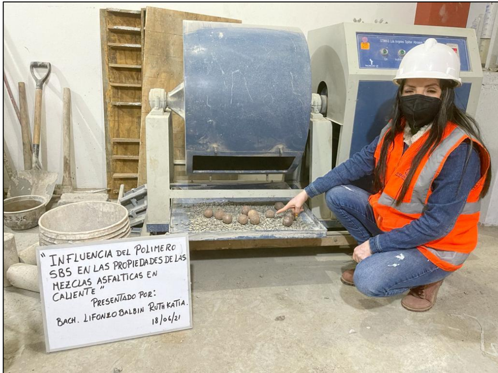
Fotografía 7. Ejecución del ensayo de Los Ángeles del agregado grueso.
