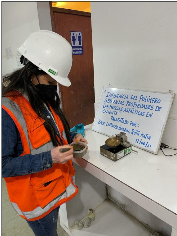
Fotografía 5. Evaluación del límite líquido del agregado fino.
