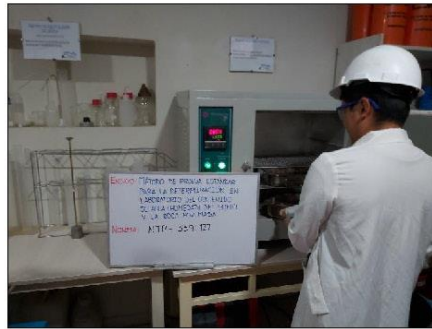
Imagen 06: Secado de muestras en horno para determinar el contenido de humedad según norma ASTM D2216
