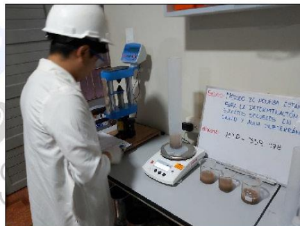
Imagen 11: Determinación de Sulfatos solubles en Suelos. Según norma NTP 339.178
