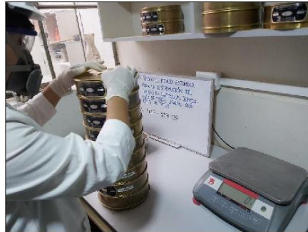
Imagen 07: Análisis granulométrico por tamizado según normas ASTM D422, NTP 339.128
