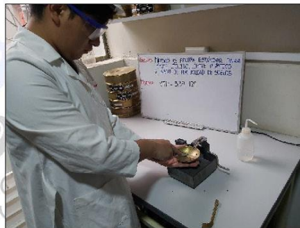
Imagen 08: Determinación de los límites de Atterberg según normas ASTM D4318, NTP 339.129
