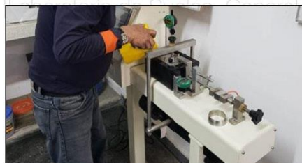
Imagen 15: Ensayo de corte directo según norma ASTM D3080, NTP 339.171
