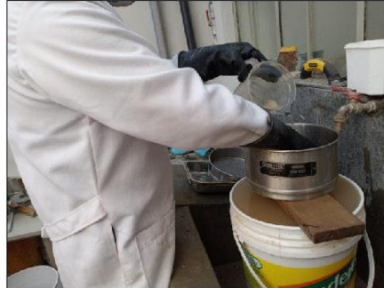
Imagen 04: Lavado de muestras de para separar los suelos finos con un tamiz N° 200
