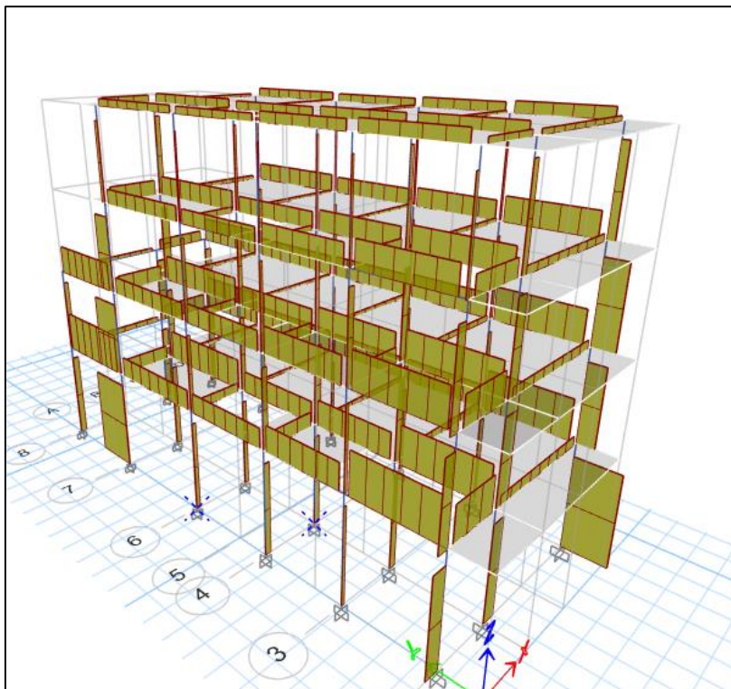
Figura 63. Fuerza cortante de entre piso del modelo 1, por sismo en el eje Y-Y.
