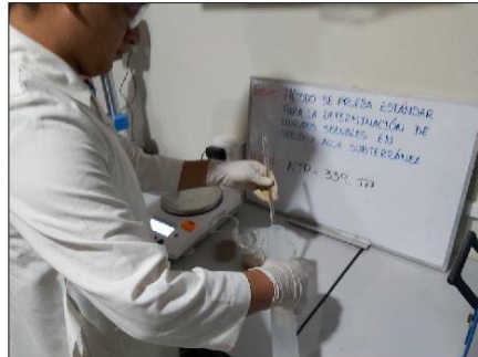
Imagen 13: Determinación de Cloruros solubles en Suelos. Según norma NTP 339.178
