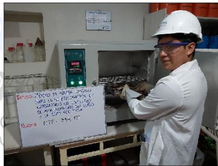
Imagen 05: Secado de muestras en horno para determinar el contenido de humedad según norma ASTM D2216
