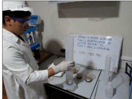
Imagen 10: Determinación de Sulfatos solubles en Suelos. Según norma NTP 339.178
