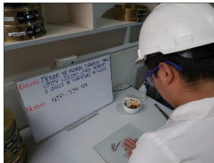
Imagen 09: Determinación de los límites de Atterberg según normas ASTM D4318, NTP 339.129
