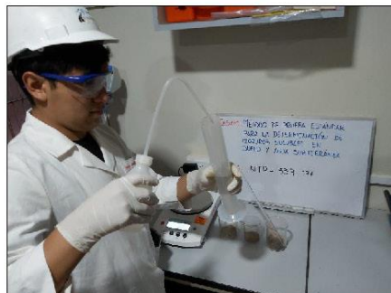
Imagen 12: Determinación de Cloruros solubles en Suelos. Según norma NTP 339.178
