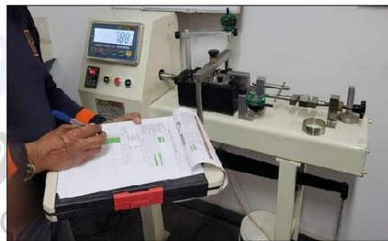
Imagen 14: Ensayo de corte directo según norma ASTM D3080, NTP 339.171
