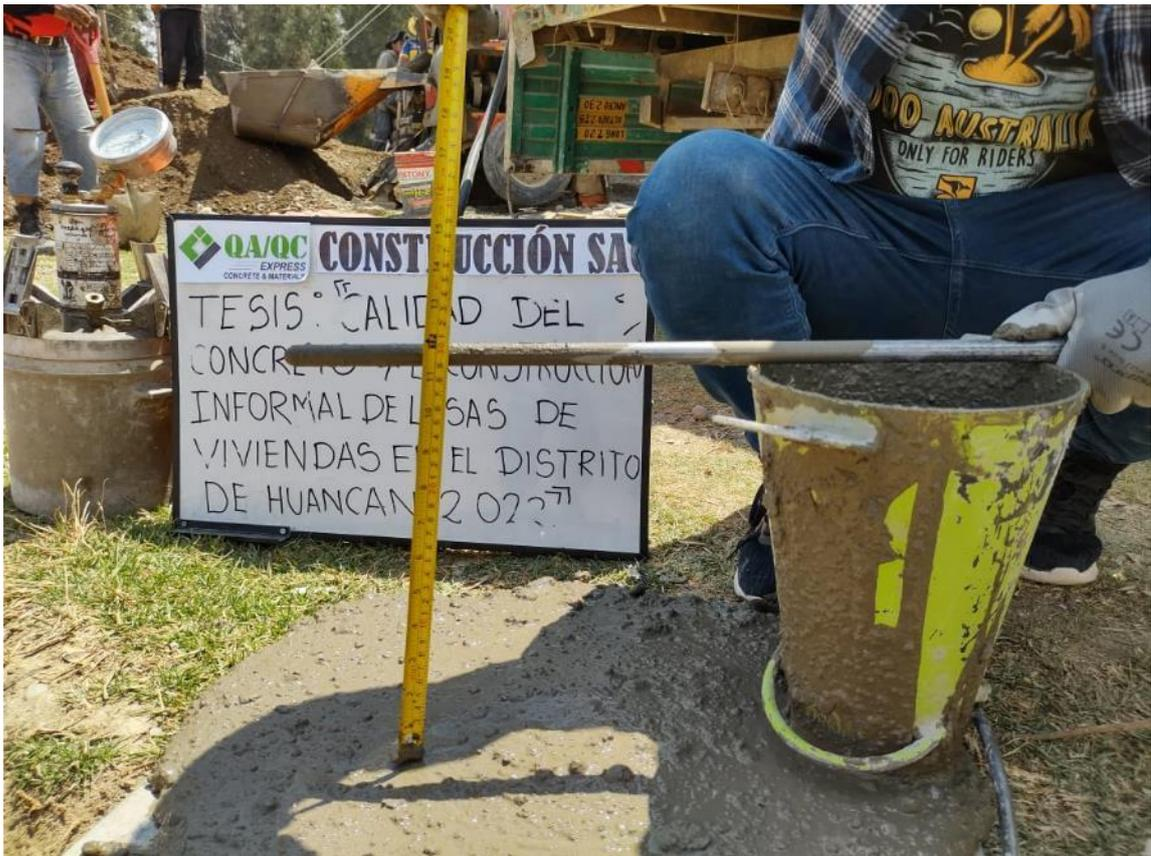
*Figura 4.3 Moldeo de probetas cilíndricas de 6" x 12" vivienda N° 20*
