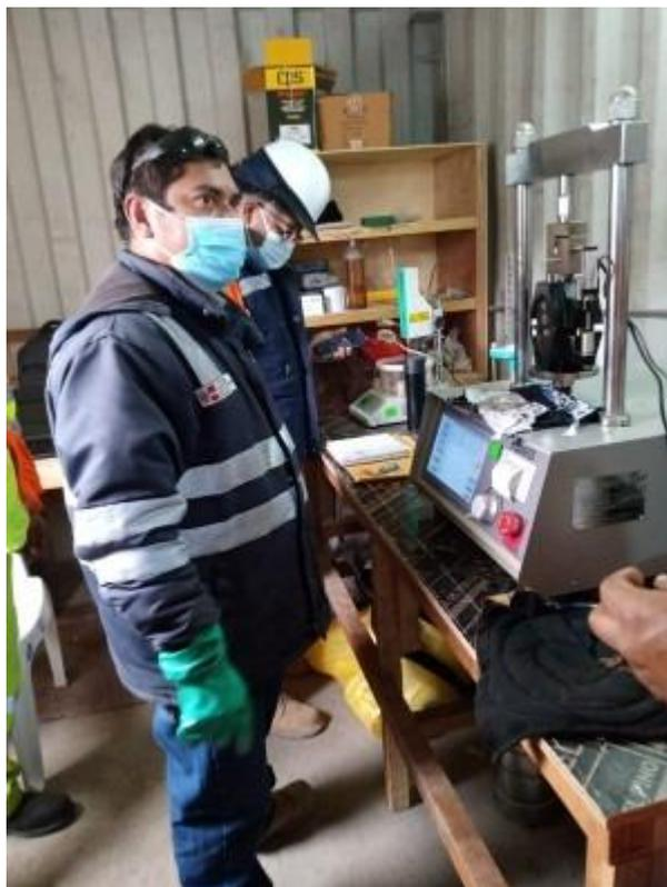
Fotografía 10. Vista del ensayo de Marshall, de las muestras de asfalto patrón.
