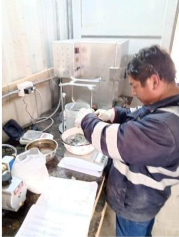
Fotografía 1. Mezcla de los componentes del asfalto patrón.
