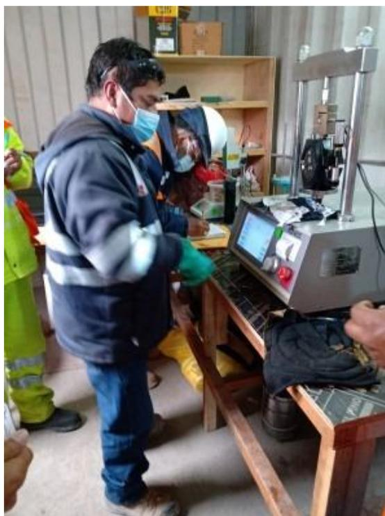
Fotografía 12. Vista del ensayo de Marshall, de las muestras de asfalto con 25 % de RAP y agente rejuvenecedor.
