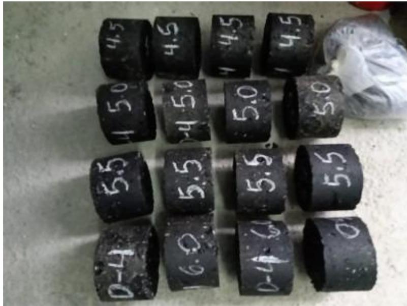
Fotografía 7. Vista de las muestras de asfalto modificado con 20 % RAP y agente rejuvenecedor en proporciones de 4 %, 5 % y 6 %.
