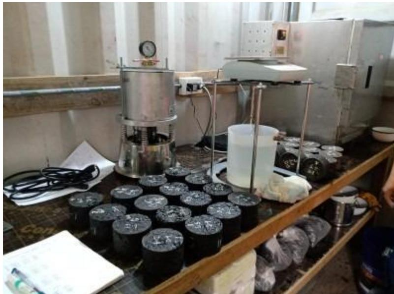
Fotografía 8. Vista de las muestras de asfalto modificado con 25 % RAP y agente rejuvenecedor en proporciones de 4 %, 5 % y 6 %.
