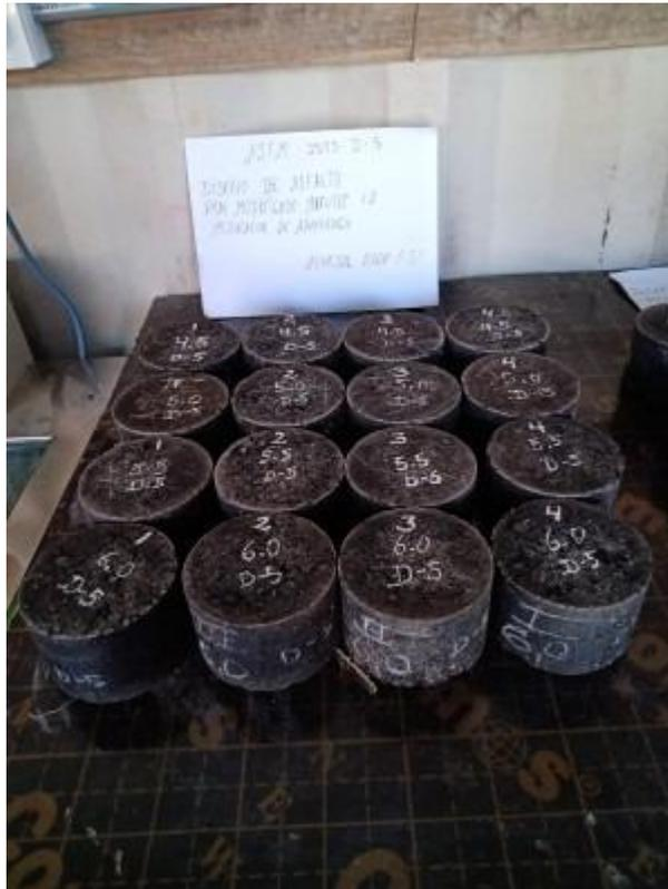
Fotografía 9. Vista de las muestras de asfalto modificado con 30 % RAP y agente rejuvenecedor en proporciones de 4 %, 5 % y 6 %.
