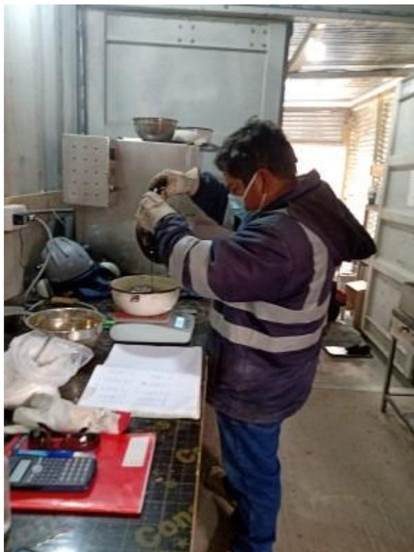
Fotografía 4. Mezcla de los componentes del asfalto con 30 % de RAP y dosificaciones de agente rejuvenecedor de 4 %, 5 % y 6 %.
