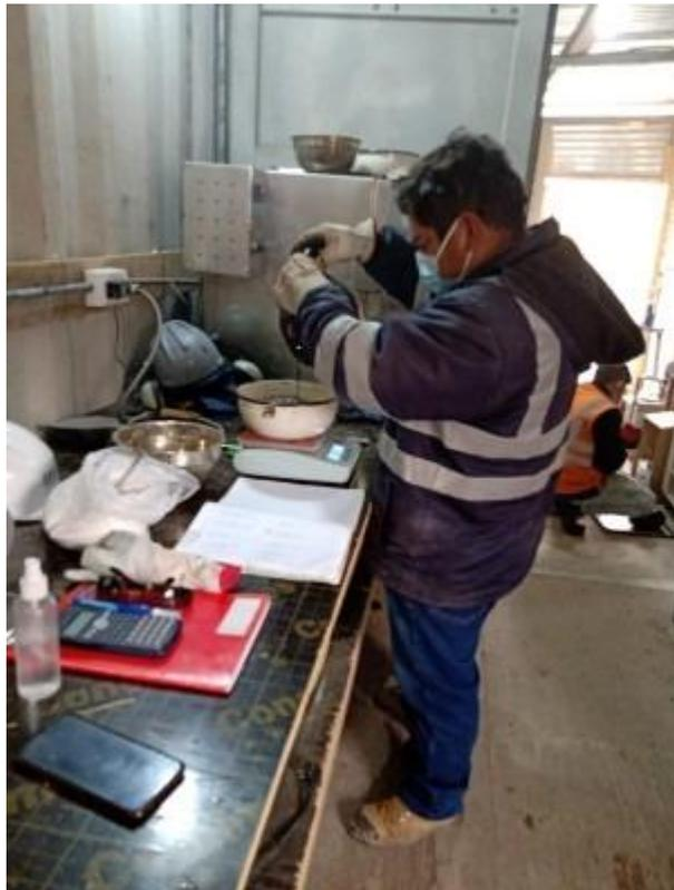
Fotografía 2. Mezcla de los componentes del asfalto con 20 % de RAP y dosificaciones de agente rejuvenecedor de 4 %, 5 % y 6 %.
