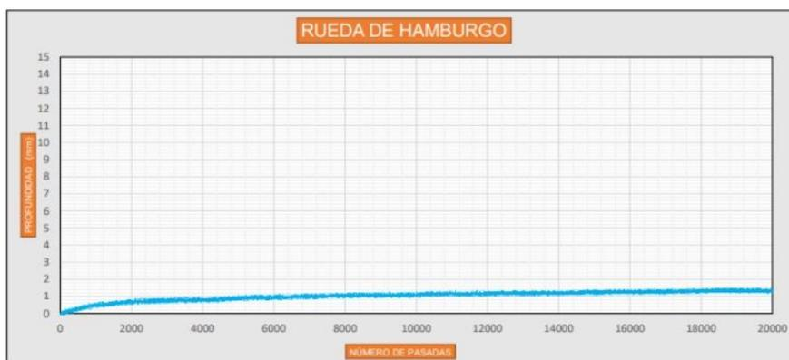
**Cuadro N°11:** se observa el resultado del ensayo indicando una curva sin distorsión la cual indica que tiene un buen comportamiento a la deformación, las cuales como resultado se tiene 20000 pasadas y una deformidad de 1.32 mm.
