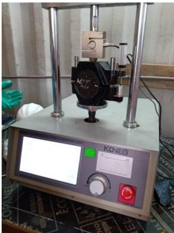
Fotografía 11. Vista del ensayo de Marshall, de las muestras de asfalto con 20 % de RAP y agente rejuvenecedor.
