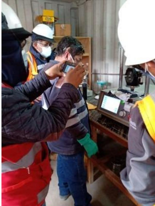
Fotografía 13. Vista del ensayo de Marshall, de las muestras de asfalto con 30 % de RAP y agente rejuvenecedor.
