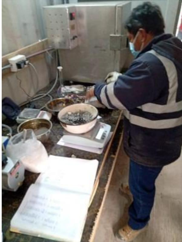
Fotografía 3. Mezcla de los componentes del asfalto con 25 % de RAP y dosificaciones de agente rejuvenecedor de 4 %, 5 % y 6 %.
