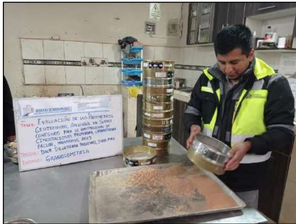
Fotografía N° 9: Ensayo granulométrica, según referencia de la norma MTC E 107
