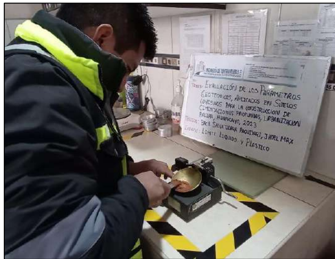
Fotografía N° 12: Ensayo de límite líquido, para esto la muestra debe de ser homogénea y debe de ser colocada en la copa de Casagrande de manera uniforme, según referencia de la norma MTC E 110
