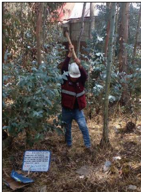
Fotografía N° 6: Se aplican los shots o golpes con una comba sísmica para generar vibraciones, que son registrados en cada uno de los geófonos y estos son amplificados por el sismógrafo para finalmente ser visualizados en la pantalla de una computadora personal.
