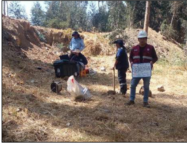
Fotografía N° 7: Ubicación de los shots que van fuera del tendido de cable, alineado a la misma y a una distancia equivalente al 5%, 10% y 20 % de la longitud de tendido. (Método del MASW)
