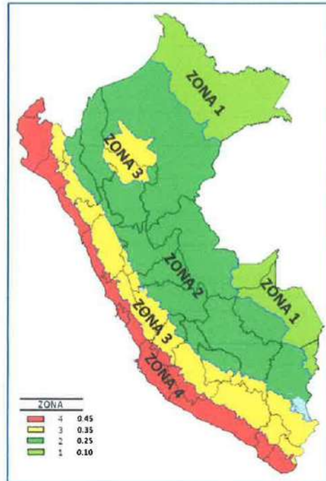
Figura No. 11 Zonas Sismicas
