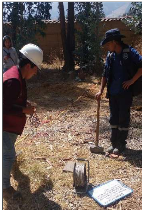
Fotografía N° 8: Durante el levantamiento en campo se aplicó 5 shorts para la línea sísmica de refracción; 1 shot fuera del tendido a dos metros del primer y último geófono en ambos extremos, y los tres shot restantes entre los geófonos 6 -7 ,12-13 y 16-17
