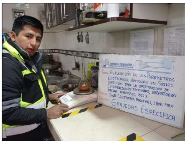
Fotografía N° 10: Ensayo de gravedad específica, referencia de la norma MTC E 111
