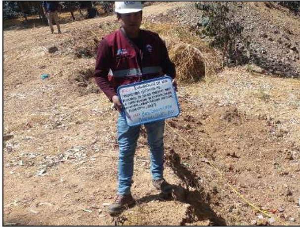
Fotografía N° 5: Tendido de cable con un espaciamiento de geófonos de 4 metros, en total se utilizaron 24 geófonos a lo largo de la línea de refracción sísmica.
