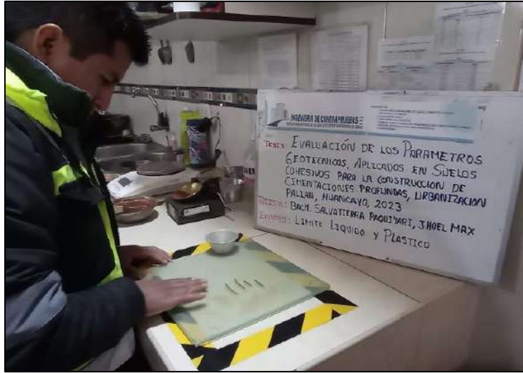
Fotografía N° 13: Ensayo de límite plástico de la muestra realizando unas barritas o rollitos de suelo de más o menos 3.2mm de diámetro rodando con la palma de la mano, según referencia de la norma MTC E 111
