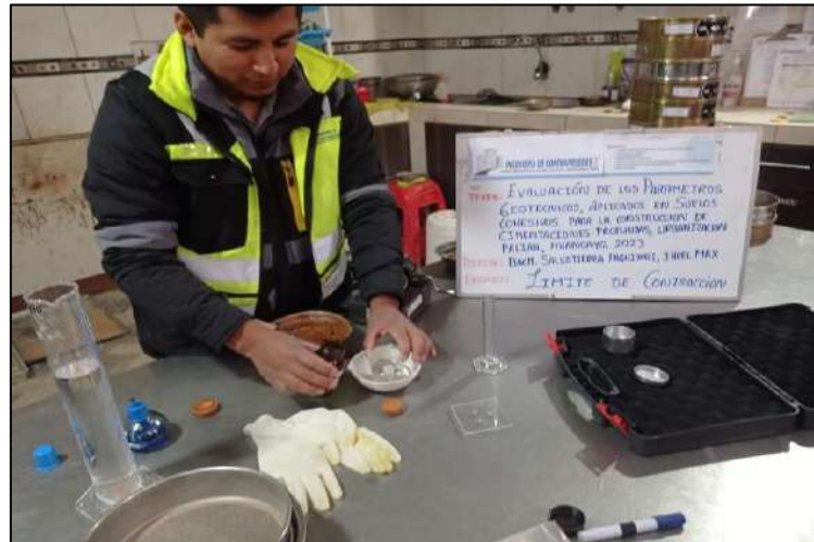
Fotografía N° 14: Ensayo de límite contracción que representa el contenido máximo del agua usando el método del mercurio, según referencia de la norma MTC E 112
