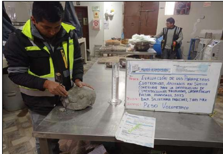
Fotografía N° 11: Ensayo de peso volumétrico del suelo arcilloso con una muestra inalterada, la cual se talla, se pesa y se desarrolla por el método de inmersión en agua
