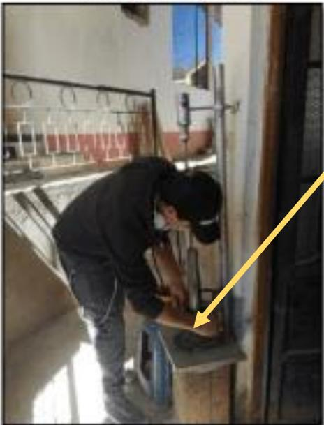
Se observa a la sílice de siendo molido para obtener el nanosilice que se pueda incorporar como un aditivo a la mezcla de concreto para nuestra investigación.
