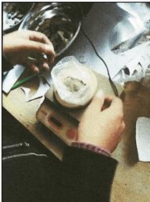
Se observa el pesaje del nanosilice para incorporarlo a la mezcla con diseño al 1.00 % de nanosilice en peso de cemento, el mismo procedimiento para los diferentes diseños.
