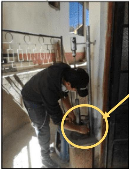
Se observa el retiro del material ya pulverizado nanosilice, para el tamizado del mismo.
