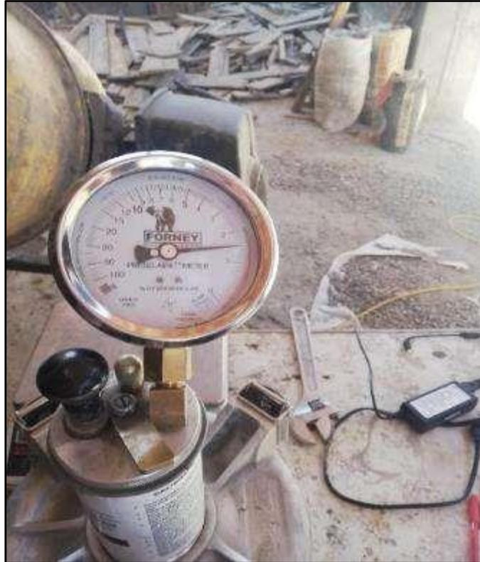
**a. Ensayo de contenido de aire en la muestra de concreto convencional**
