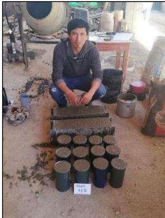
**Fotografía 4.** *Elaboración y llenado de mezcla fresca de concreto en vigas con la incorporación del 1% de nanosilice en peso, según norma ASTM C94 y C31.*
