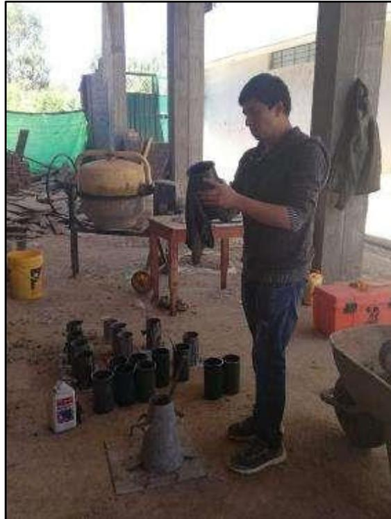
**Fotografía 3.** Muestras de concreto con la incorporación del 1% de nanosilice en peso, vaciadas ya en los moldes según norma ASTM C94 y C31.
