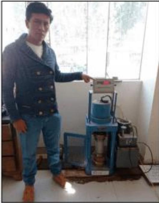
Se observa la realización del ensayo de compresión simple, para las probetas con incorporación de nanoslice.
