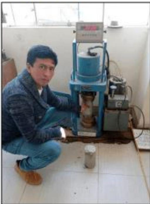
Se observa ya la obtención de resultados en la rotura de todas las probetas de concreto incorporadas con nanoslice según los diseños.
