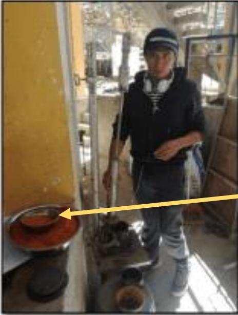
Se observa la nanosilice en el recipiente plateado, silice en estado solido esferas de color y aspecto anaranjado, para luego proceder al chancado y pulverizado para obtener el nanosilice para el estudio de investigacion
