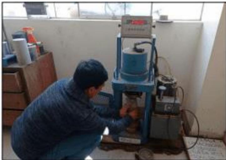
Se observa el retiro de de los testigos ya ensayados, comprobando que al adicionar nanosilice se aumenta considerablemente la resistencia
