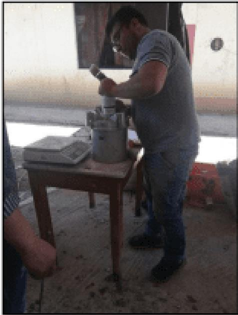
Se observa la realización del ensayo de espacios vacíos con la olla Washington, con la primera adición del 1% de nanosilice.
