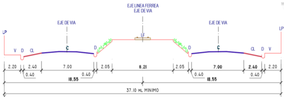
Figura 18 – Sección típica de vía – Av. Ferrocarril.
