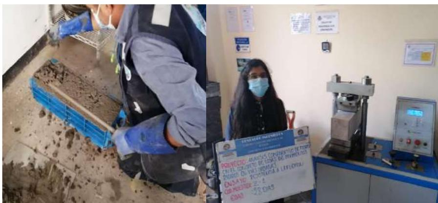
Figura 4.19: Elaboración de la viga y ensayo a la flexotracción.
