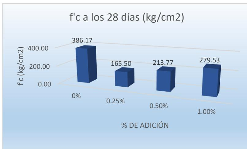
Gráfico 5.34: Diferencia de resistencias, muestra patrón/fibra de polipropileno
