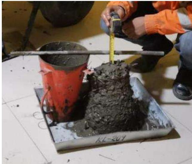
*Figura 4.15: Obtención del asentamiento*
