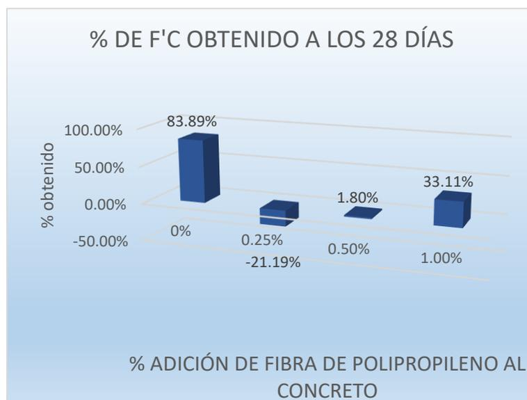
Gráfico 5.35: Comparación de % de  $f'_{c}$  obtenido con fibra de polipropileno
