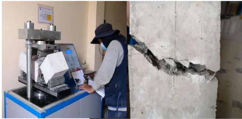
Figura 4.20: Ensayo a flexotracción.
