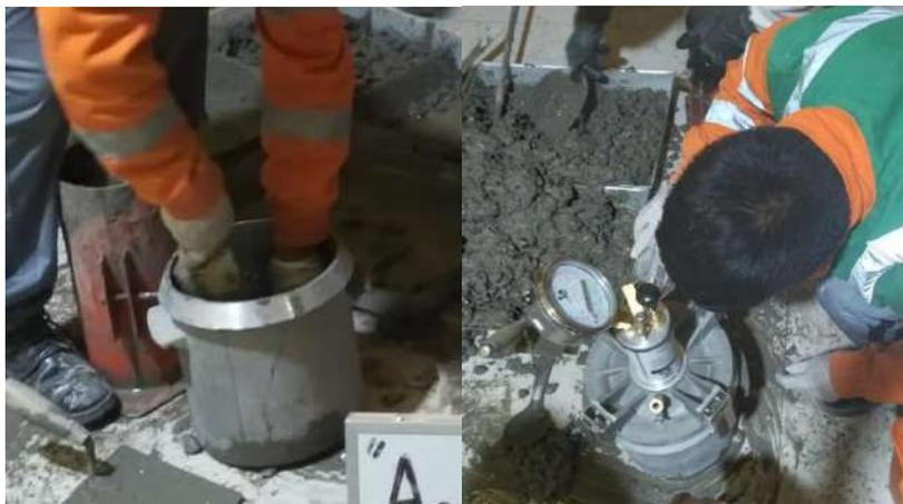
Figura 4.17: Obtención del contenido de aire.
