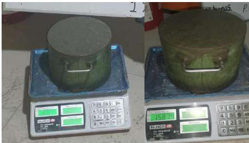
Figura 4.16: Determinación del peso unitario.
