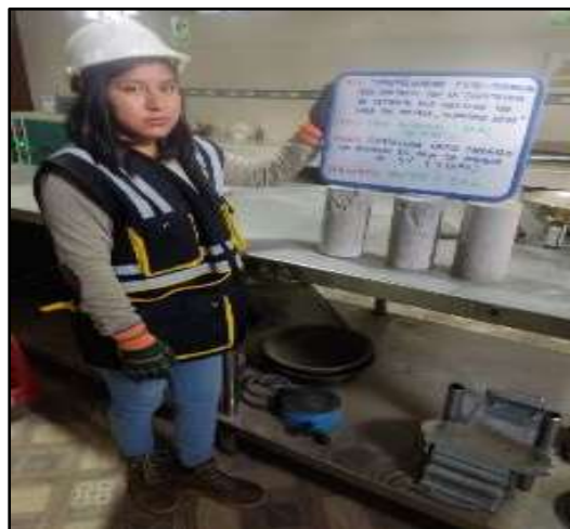
Fotografía N° 72: Espécimen 2 para el f'c con adición de 4% de paja de arveja a los 7 días
