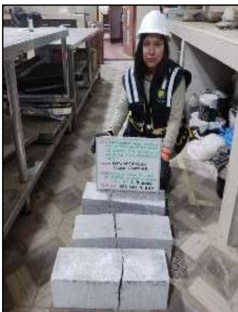
Fotografía N° 117: Especímenes para el MR con incorporación de 8% de paja de arveja a los 7 días.
