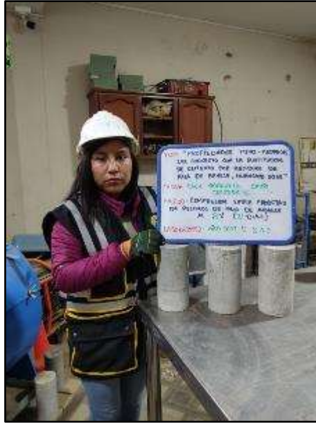
Fotografía N° 90: Especímenes para el f'c con adición de 8% de paja de arveja a los 21 días.
