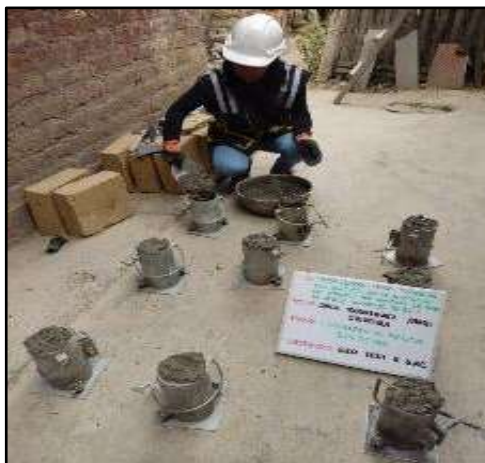
Fotografía N°27: Preparación de testigos cilíndricos convencionales
