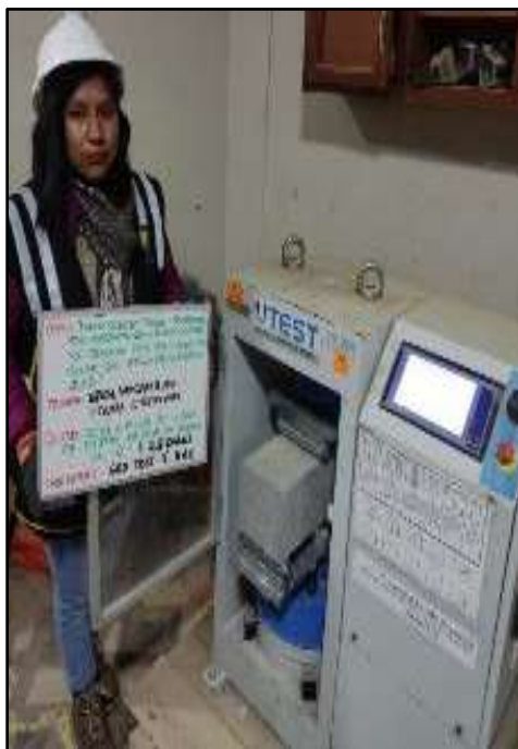
Fotografía N° 114: Espécimen 1 para el MR con incorporación de 6% de paja de arveja a los 28 días.
