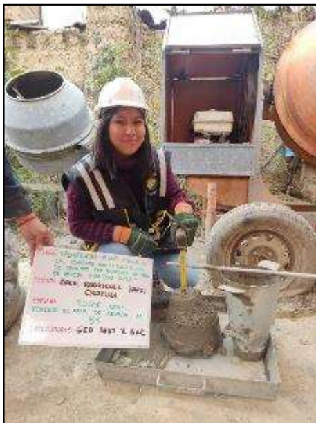
Fotografía N° 59: Medida del asentamiento de concreto fresco usando 8% de paja de arveja
