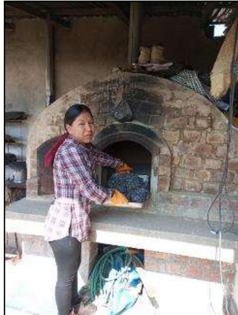
Figura N° 24. Calcinación de plantas de plantas de arveja secas a 240°C
