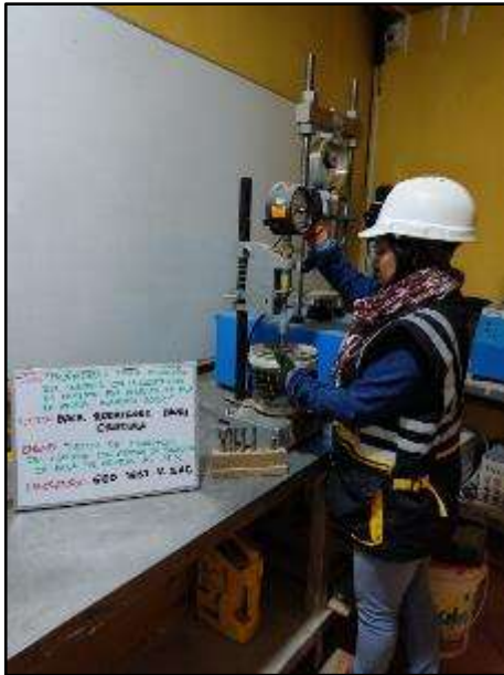
Fotografía N° 38: Observación del ensayo de penetración para cotejar el tiempo de fragua con 4% de paja de arveja
