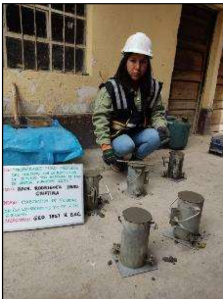
Fotografía N° 51: Preparación de testigos cilíndricos con el 6% de paja de arveja
