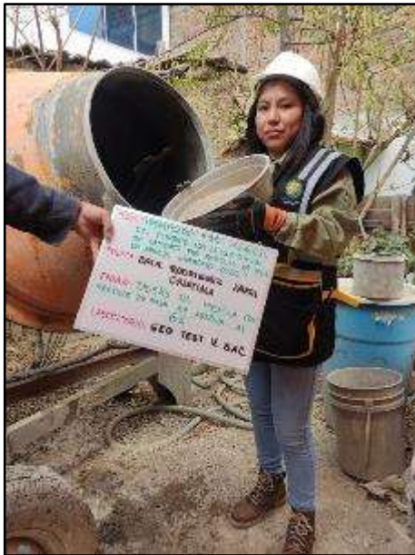
Fotografía N° 43: Incorporación de arena fina para la mezcla del concreto con 6% de paja de arveja
