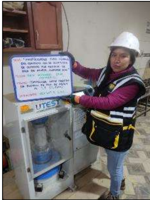
Fotografía N° 75: Espécimen 1 para el f'c con adición de 4% de paja de arveja a los 21 días.
