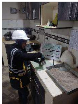
Fotografía N° 10: Evaluación de la gravedad específica y absorción
