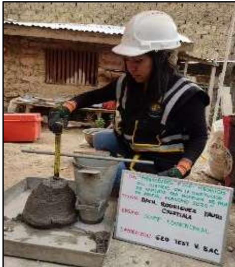
Fotografía N° 23: Medida del asentamiento del concreto convencional
