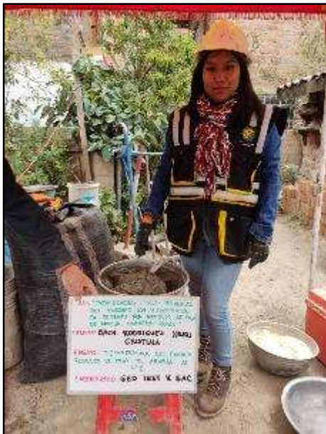
Fotografía N° 34: Toma de temperatura del concreto recién sacado de la mezcladora con 4% de paja de arveja
