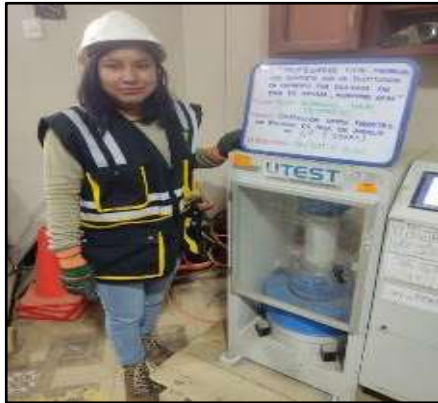
Fotografía N° 79: Espécimen 1 para el f'c con adición de 6% de paja de arveja a los 7 días.
