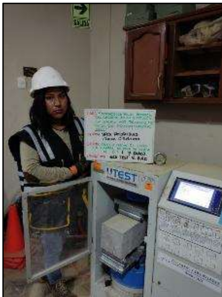
Fotografía N° 109: Espécimen 1 para el MR con incorporación de 6% de paja de arveja a los 7 días.
