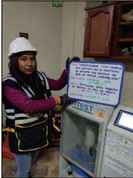
Fotografía N° 82: Espécimen 1 para el f'c con adición de 6% de paja de arveja a los 21 días.
