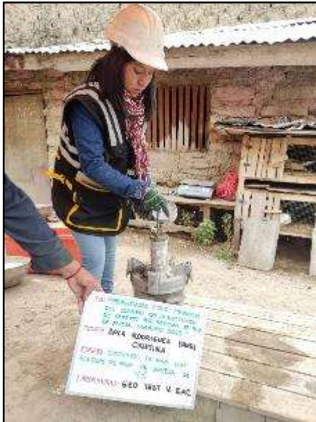
Fotografía N° 36: Medida del contenido de aire por presión del concreto fresco con 4% de paja de arveja
