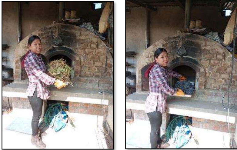
Fotografía N° 4 y 5. Incineración de la paja de arveja a los 240°C.
