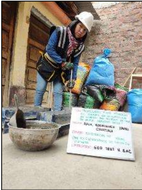
Fotografía N° 40: Preparación de testigos rectangulares utilizando 4% de paja de arveja
