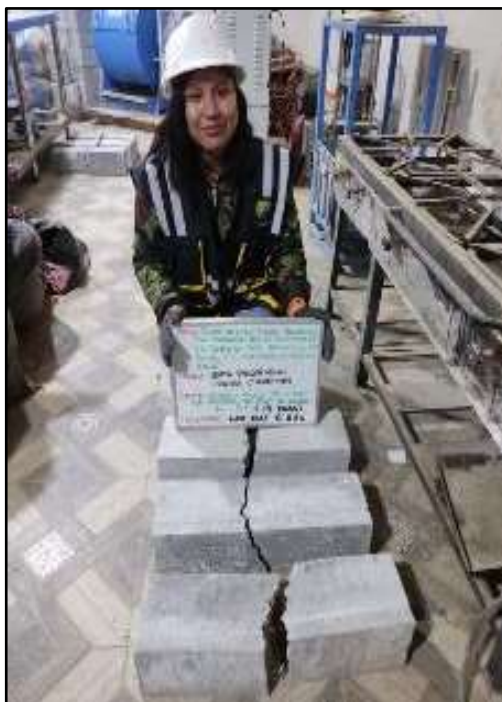
Fotografía N° 118: Especímenes para el MR con incorporación de 8% de paja de arveja a los 14 días.
