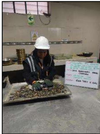
Fotografía N°12: Ensayo de la gravedad específica del agregado grueso
