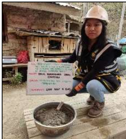
Fotografía N° 22: Toma de temperatura del concreto recién salido de la mezcladora
