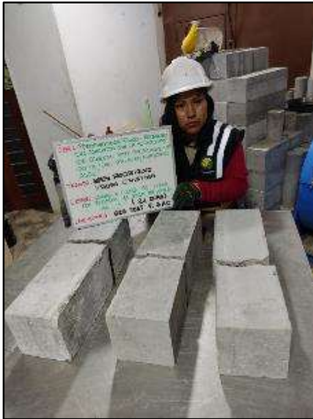
Fotografía N° 106: Especímenes para el MR con incorporación de 4% de paja de arveja a los 21 días.
