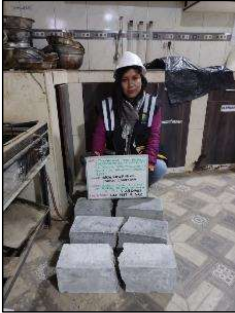
Fotografía N° 122: Especímenes para el MR con incorporación de 8% de paja de arveja a los 28 días.
