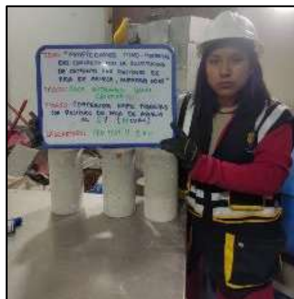
Fotografía N° 81: Espécimen 1 para el f'c con adición de 6% de paja de arveja a los 14 días.
