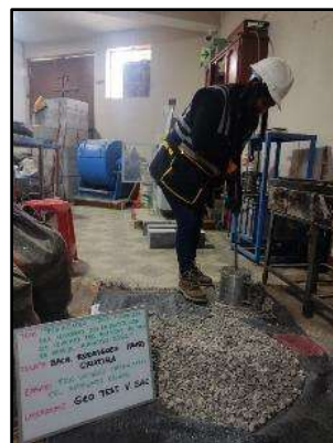
Fotografía N°16: Llenado y compactado con la varilla al agregado grueso
