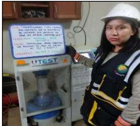
Fotografía N° 71: Espécimen 1 para el f'c con adición de 4% de paja de arveja a los 7 días
