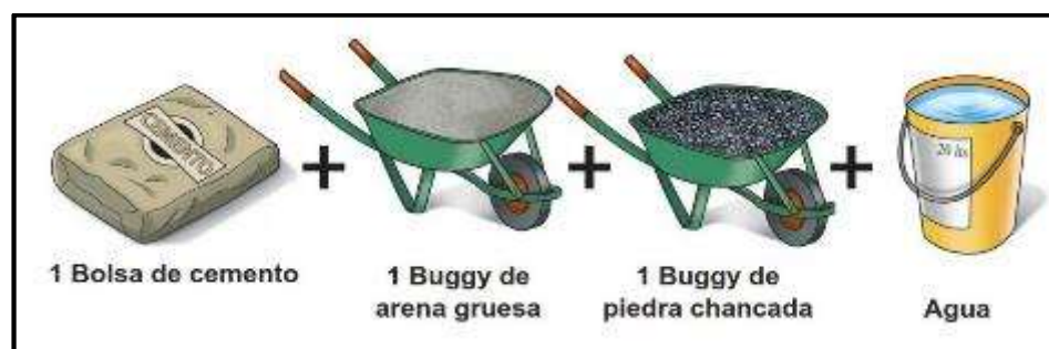
Figura N° 16. Componentes del concreto armado
