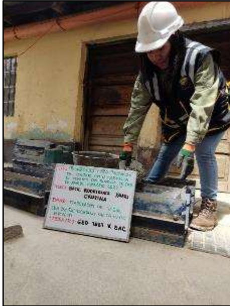
Fotografía N° 52: Preparación de testigos rectangulares utilizando 6% de paja de arveja
