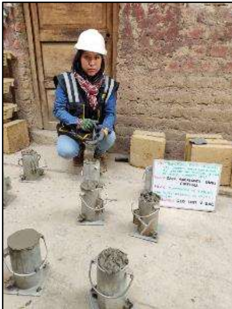
Fotografía N° 39: Preparación de testigos cilíndricos con el 4% de paja de arveja
