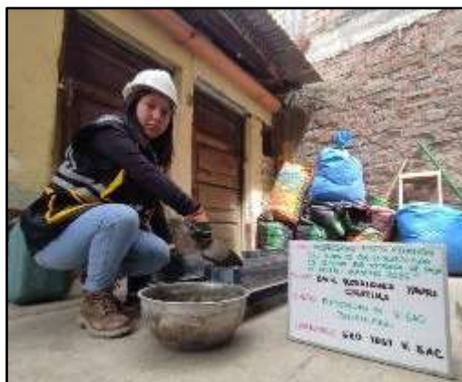
Fotografía N°28: Preparación de testigos rectangulares para la mezcla convencional
