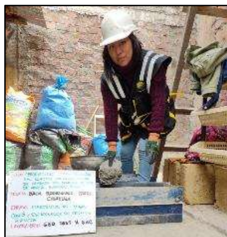
Fotografía N° 64: Preparación de testigos rectangulares utilizando 8% de paja de arveja
