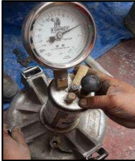
Figura N° 27. Proceso del ensayo de la olla de Washinton
