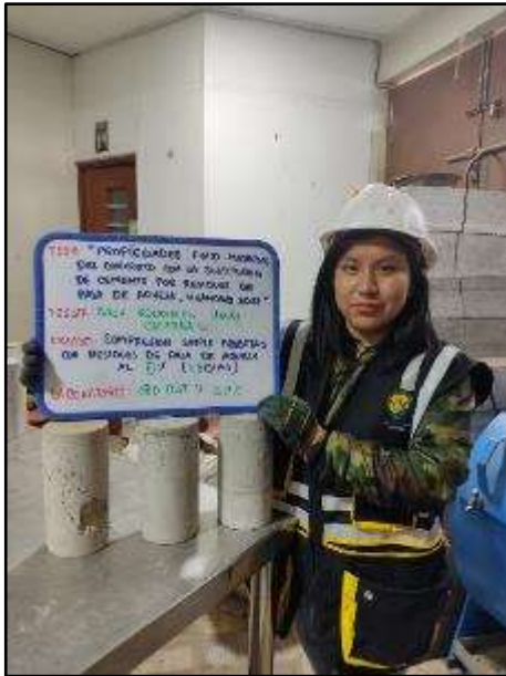
Fotografía N° 92: Especímenes para el F´C con adición de 8% de paja de arveja a los 28 días.
