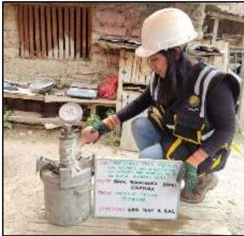
Fotografía N°26: Medida del contenido de aire con la Olla de Washington
