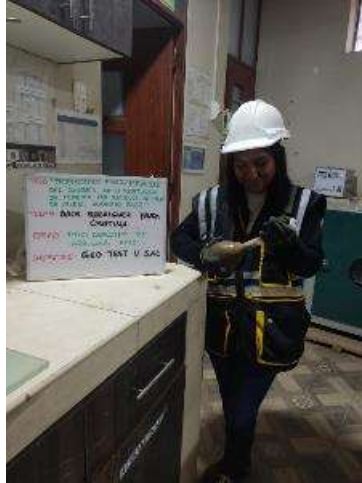
Fotografía N° 11: Ensayos con la fiola de vidrio para la gravedad específica y la absorción de los gránulos.
