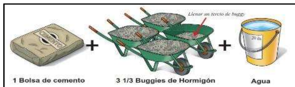
Figura N° 14. Componentes del concreto ciclópeo
