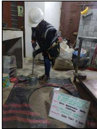
Fotografía N° 14: Compactación con la varilla del agregado fino en el molde
