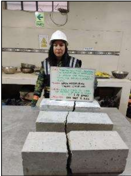
Fotografía N° 104: Especímenes para el MR con incorporación de 4% de paja de arveja a los 14 días.
