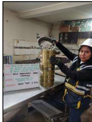
Fotografía N°9: Tamizado del agregado grueso, según la NTP 400.012.
