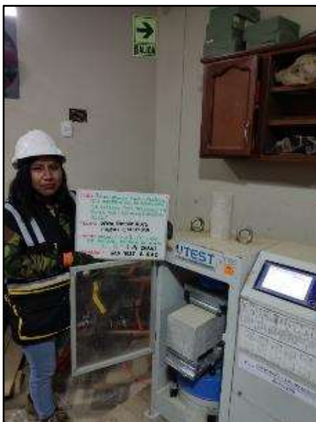
Fotografía N° 110: Espécimen 1 para el MR con incorporación de 6% de paja de arveja a los 14 días.
