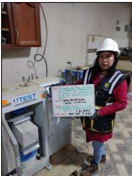
Fotografía N° 112: Especimen 1 para el MR con incorporación de 6% de paja de arveja a los 21 días.
