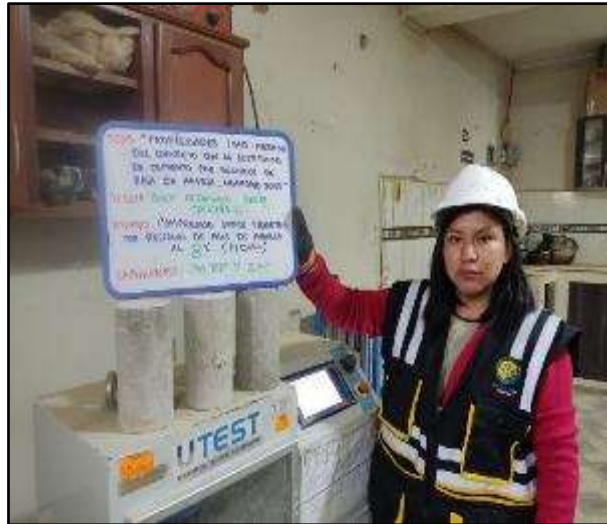
Fotografía N° 88: Especímenes para el f'c con adición de 8% de paja de arveja a los 14 días.
