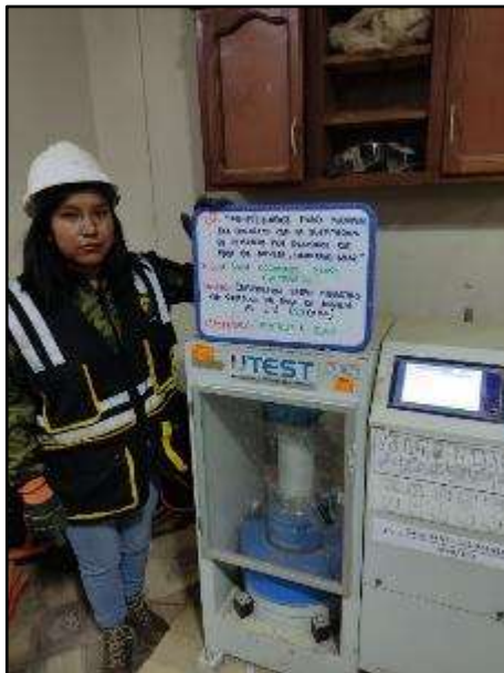
Fotografía N° 91: Especímen 1 para el f'c con adición de 8% de paja de arveja a los 28 días.
