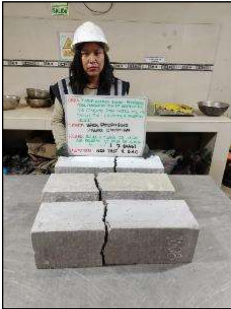
Fotografía N° 102: Especímenes para el MR con incorporación de 4% de paja de arveja a los 7 días.
