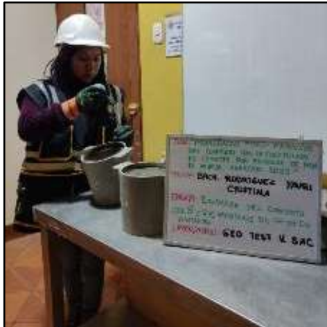
Fotografía N°62: Ensayo de exudación del concreto con el 8% de paja de arveja
