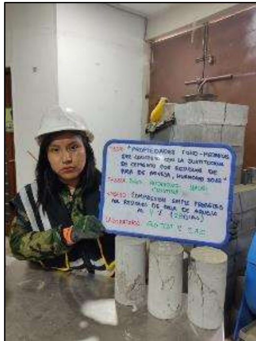
Fotografía N° 78: Especímenes para el f c con adición de 4% de paja de arveja a los 28 días.
