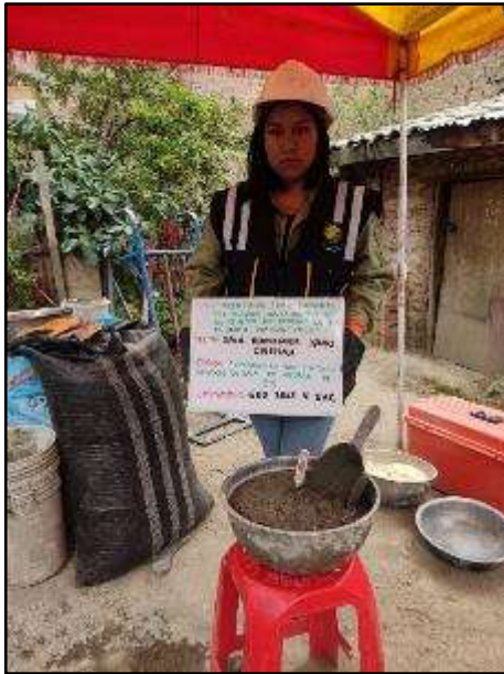
Fotografía N° 46: Toma de temperatura del concreto recién sacado de la mezcladora con 6% de paja de arveja
