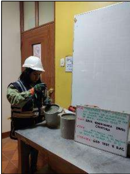
Fotografía N° 50: Ensayo de exudación del concreto con el 6% de paja de arveja
