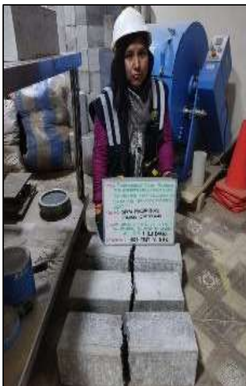
Fotografía N° 115: Especímenes para el MR con incorporación de 6% de paja de arveja a los 28 días.
