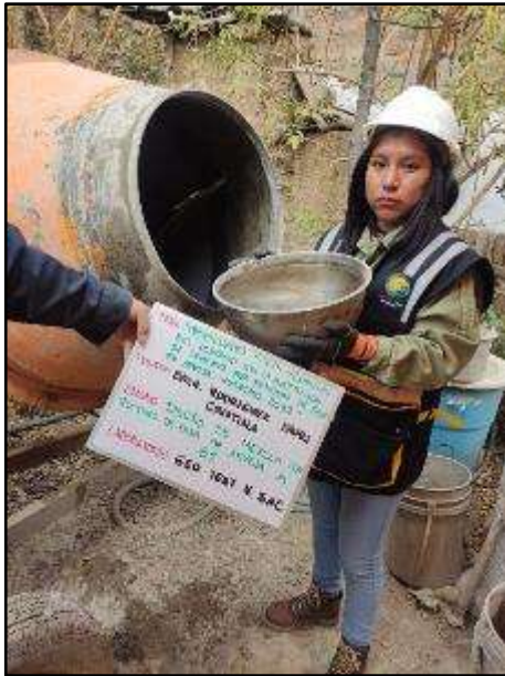
Fotografía N° 44: Incorporación del agua para la mezcla del concreto con 6% de paja de arveja
