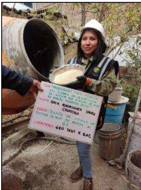
Fotografía N° 45: Incorporación de la paja de arveja con peso requerido del 6% de para su mezcla del concreto
