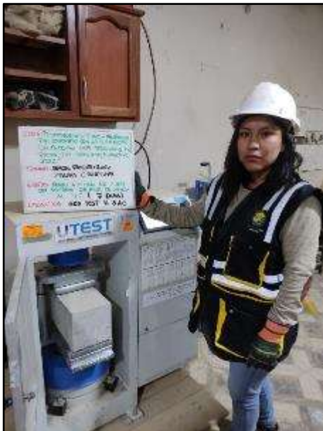
Fotografía N° 101: Especímen 1 para el MR con 4% de paja de arveja a los 7 días.
