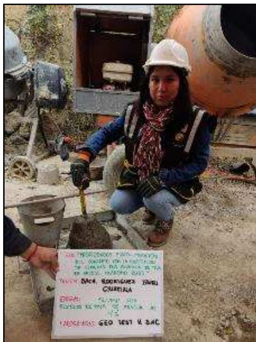
Fotografía N° 35: Medida del asentamiento de concreto fresco usando 4% de paja de arveja
