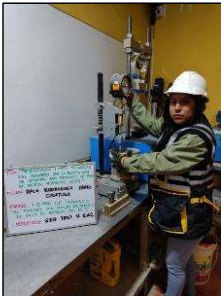
Fotografía N° 49: Observación del ensayo de penetración para cotejar el tiempo de fragua con 6% de paja de arveja
