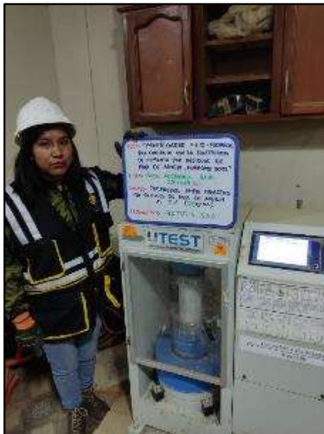
Fotografía N° 83: Espécimen 1 para el f'c con adición de 6% de paja de arveja a los 28 días.
