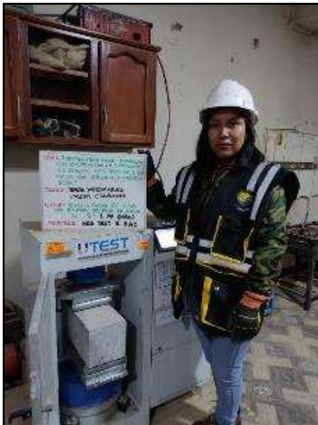
Fotografía N° 103: Especímen 1 para el MR con incorporación de 4% de paja de arveja a los 14 días.
