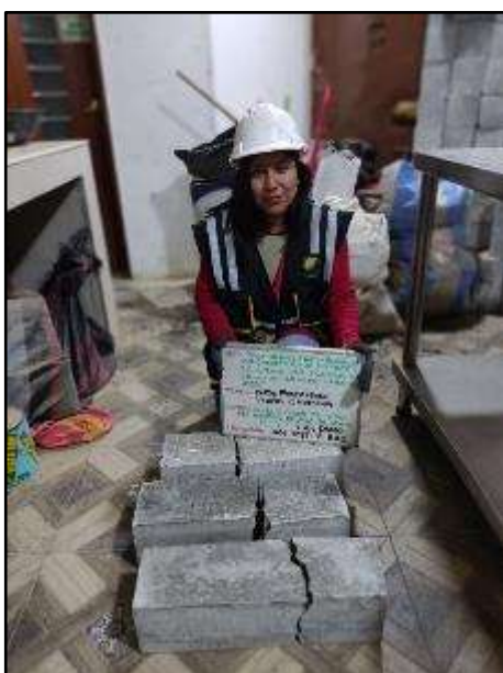
Fotografía N° 113: Especímenes para el MR incorporación de 6% de paja de arveja a los 21 días.
