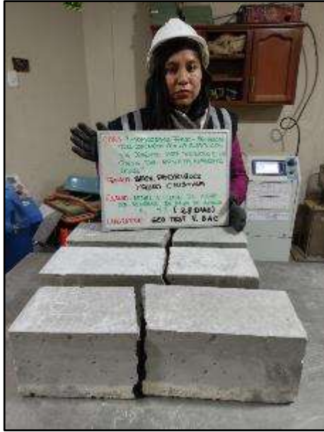
Fotografía N° 108: Especímenes para el MR con incorporación de 4% de paja de arveja a los 28 días.
