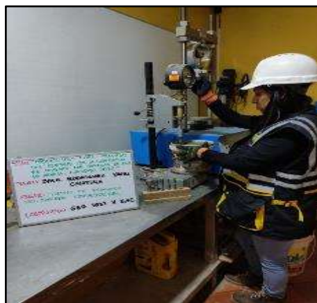
Fotografía N°25: Observación del ensayo de penetración para cotejar el tiempo para el fraguado
