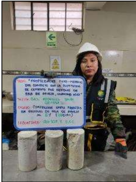
Fotografía N° 84: Especímenes para el f'c con adición de 6% de paja de arveja a los 28 días.
