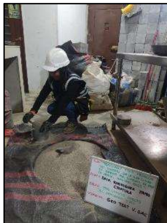
Fotografía N°15: Llenado y enrasado para las 2 capas restantes
