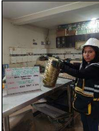
Fotografía N°8: Tamizado del agregado fino, según la NTP 400.012.
