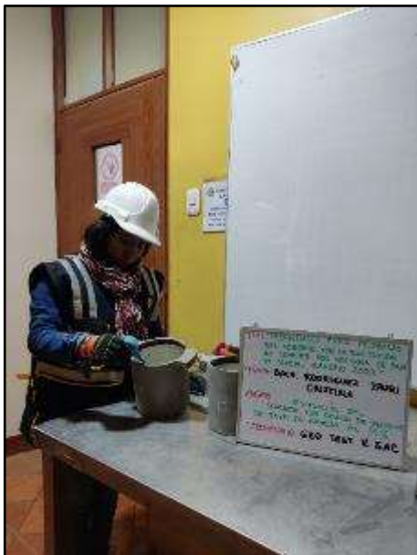
Fotografía N° 37: Ensayo de exudación del concreto con el 4% de paja de arveja,
