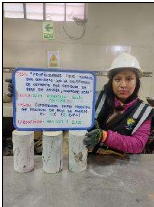
Fotografía N° 76: Espécimen 2 para el f'c con adición de 4% de paja de arveja a los 21 días.
