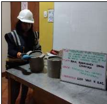
Fotografía N° 24: Ensayo de exudación del concreto convencional.
