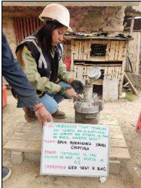
Fotografía N° 48: Medida del contenido de aire por presión del concreto fresco con 6% de paja de arveja
