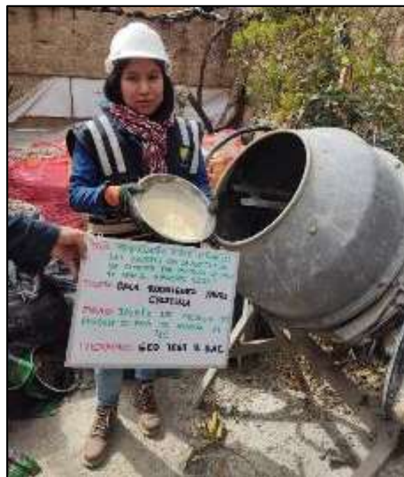
Fotografía N° 33: Incorporación de la paja de arveja con peso requerido del 4% del concreto
