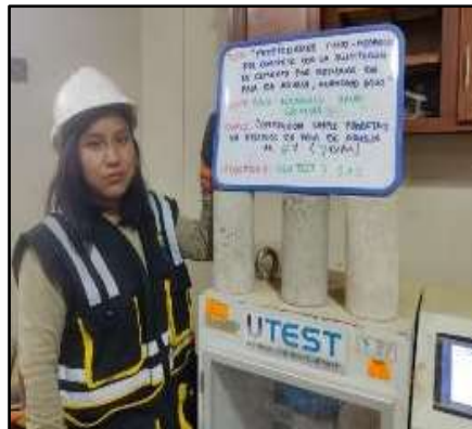
Fotografía N° 80: Especímenes para el f'c con adición de 6% de paja de arveja a los 7 días.
