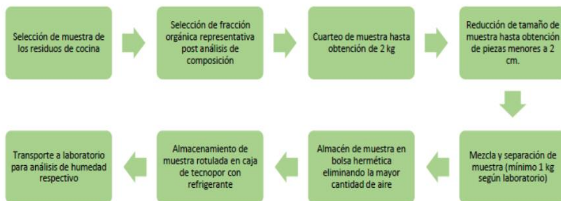
Figura 19. Procedimiento de toma de muestra para análisis de humedad.
